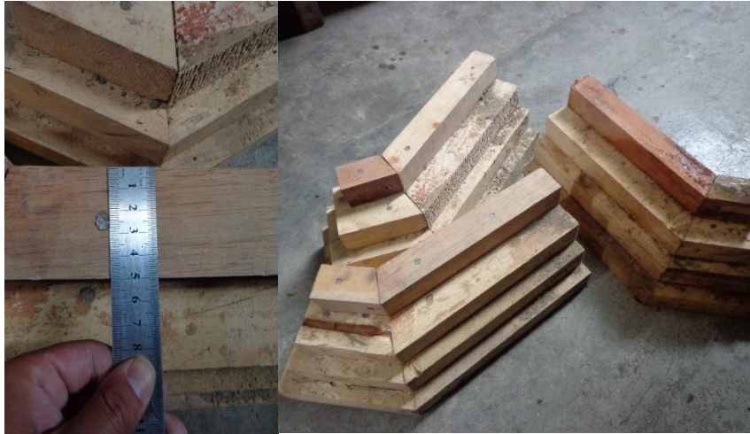
Figura 43. Construcción de espigones angulares impermeables de sección b \cdot h = 5 \cdot 5 cm a escala 1:20, la cual a escala natural representa a una sección de b \cdot h = 1 \cdot 1 m.
