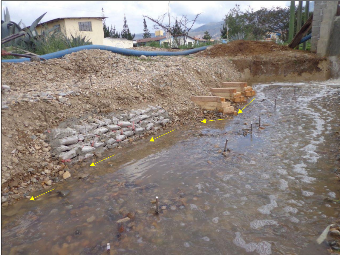
Figura 63. Comportamiento del flujo con la combinación de estructuras bolsacreto - espigo en el modelo.
