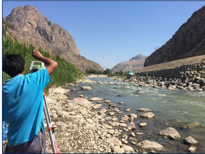
Figura 25. Levantamiento topográfico de la zona en estudio con Estación Total Leyca.
