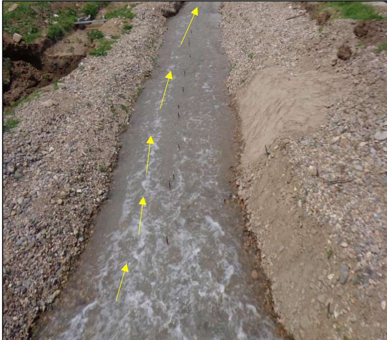
Figura 51. Comportamiento del flujo sin estructuras en el modelo físico.
