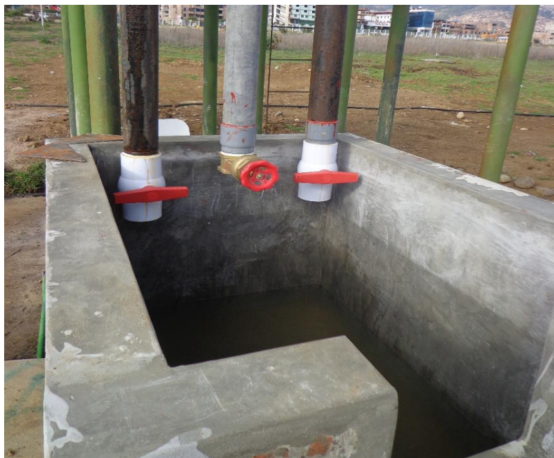
Figura 40. Poza al inicio del modelo para lograr un ingreso uniforme del agua al modelo.
