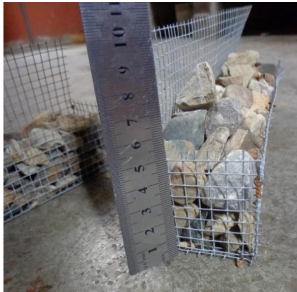
Figura 42. Construcción de gaviones permeables de sección b \cdot h = 5 \cdot 5 cm a escala 1/20 lo que a escala natural equivale a una sección de b \cdot h = 1 \cdot 1 m. elaborados con malla fierro y rellena con piedra chancada de 1/2 ".
