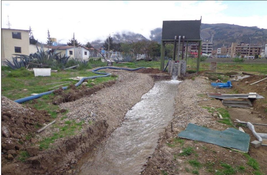
Figura 35. Modelo físico de lecho móvil a escala 1/20 construido en el campus de la Universidad Nacional de Cajamarca.
