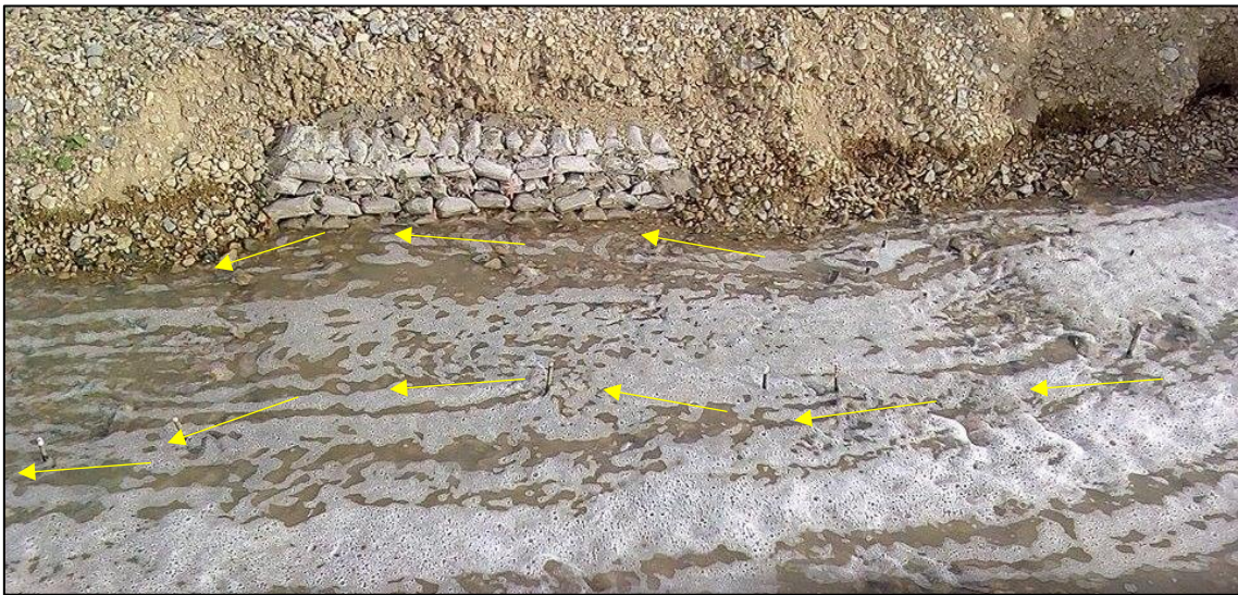
Figura 58. Comportamiento del flujo con estructura de bolsacreto en el modelo físico.
