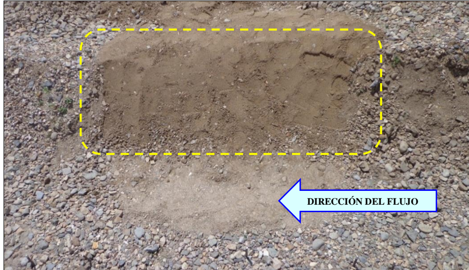
Figura 45. Reemplazo del material del lecho de fondo móvil con material que presenta la misma similitud geométrica a escala 1:20.
