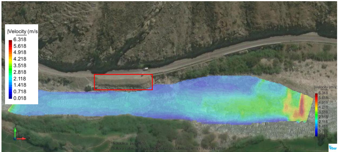
Figura 57. Comportamiento del flujo con estructuras de gavión en el modelamiento IBER, visualización de la velocidad.
