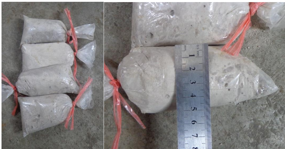
Figura 44. Construcción de bolsacretos elaborados a base de mezcla de cemento y arena fina envueltos en bolsa plástica con medidas de sección muy aproximadas a b \cdot h = 5 \cdot 5 cm a escala 1:20 la cual a escala natural equivale a una sección de b \cdot h = 1 \cdot 1 m.
