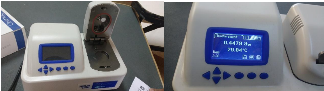
Anexo 2. Equipo AQUALAB usado para la determinación de a_w
