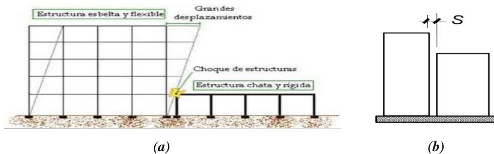
Figura 23: (a) Choque de estructuras por no tener una junta sísmica reglamentaria, (b) Juntas de separación sísmica
