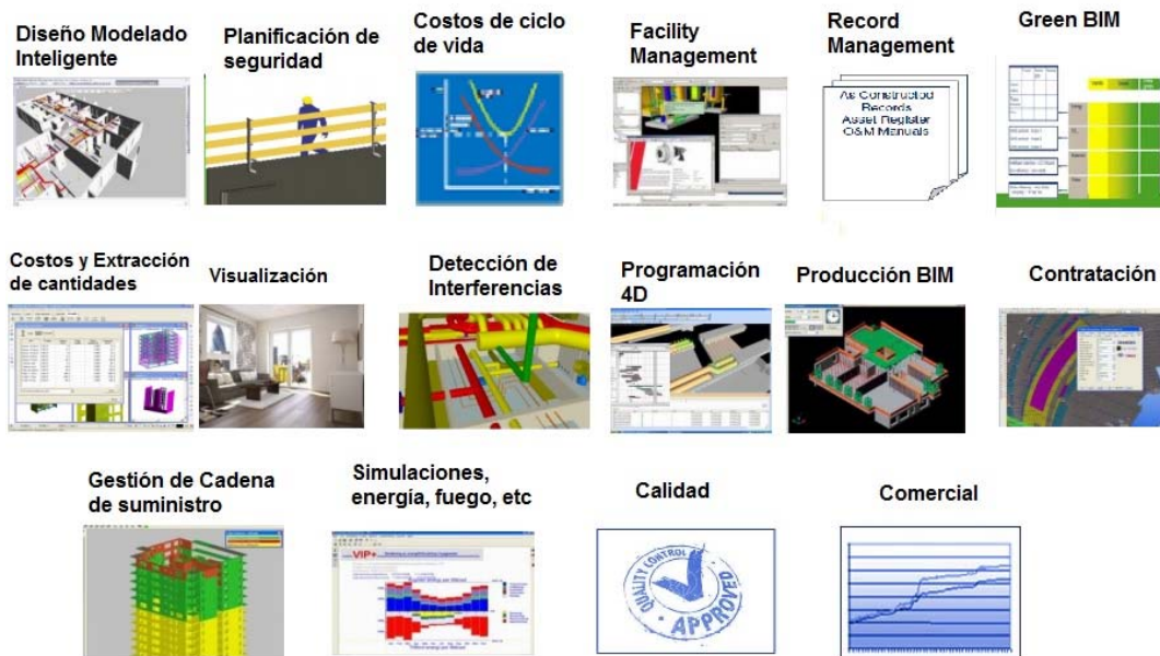
Figura 4. Grupos de usos BIM para proyectos de construcción. (Howard, 2012)
