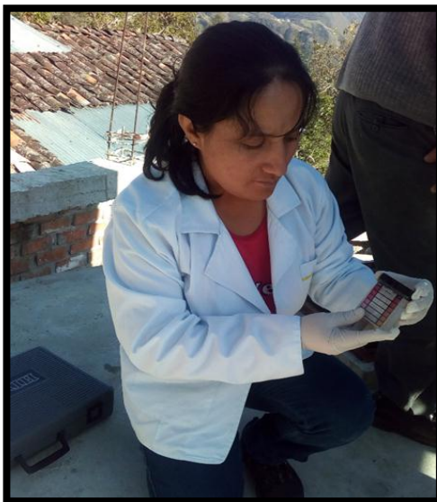
Figura 21. Registro de análisis de los parámetros realizados en campo: temperatura y cloro libre residual
