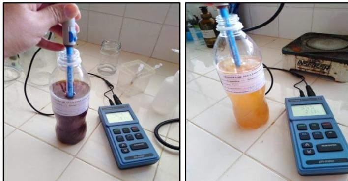
**Figura 19.** Medición del pH del efluente.
