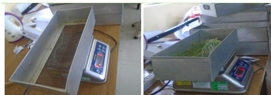
Figura 9. Peso de muestras de forraje para determinación de materia seca.
