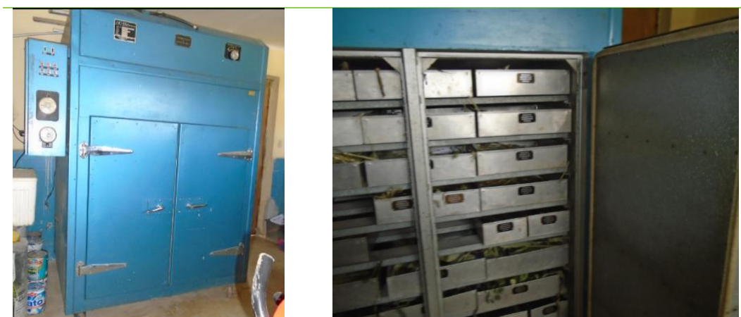
Figura 8. Muestras de pastura en proceso de secado en estufa.
