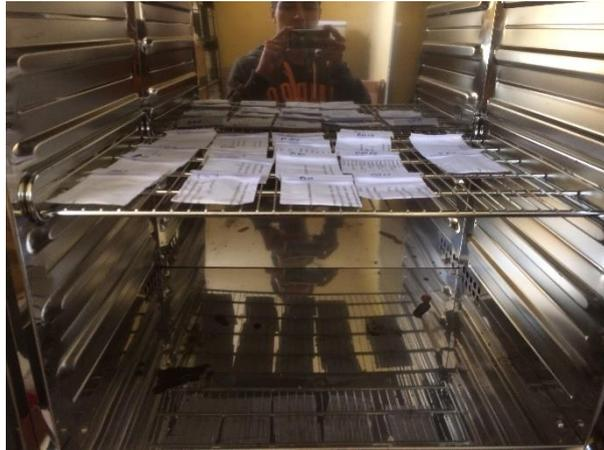
**Fig. 32.** Semillas preparadas para la prueba de contenido de humedad.
