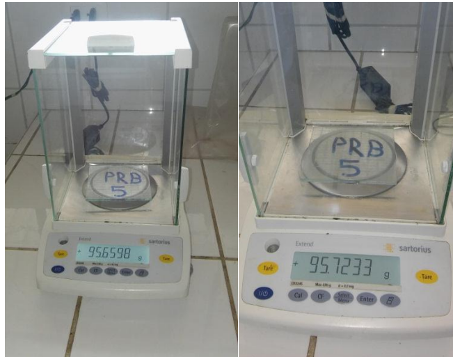
Figura 6.10. Pesado en laboratorio de la placa receptora Bellavista (PRB-05) ubicada en el punto de monitoreo Sevilla (Muestreo N° 4): Izquierda peso inicial. Derecha peso final.
