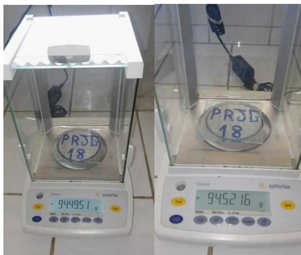
Figura 6.12. Pesado en laboratorio de la placa receptora Sevilla (PRJG-18) ubicada en el punto de monitoreo cercano a José Gálvez (Muestreo N° 4): Izquierda peso inicial. Derecha peso final.
