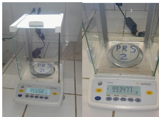
Figura 6.9. Pesado en laboratorio de la placa receptora Sevilla (PRS-02) ubicada en el punto de monitoreo Sevilla (Muestreo N° 4): Izquierda peso inicial. Derecha peso final.
