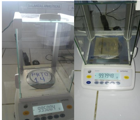
Figura 6.7. Pesado en laboratorio de la placa receptora El Torno (PRTO-14) ubicada en el punto de monitoreo El Torno (Muestreo N° 2): Izquierda peso inicial. Derecha peso final.
