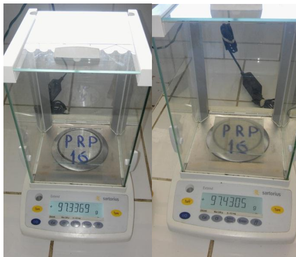
Figura 6.11. Pesado en laboratorio: Izquierda peso inicial. Derecha peso final de la placa receptora Sevilla (PRS-) ubicada en el punto de monitoreo Sevilla (Muestreo N° 4).
