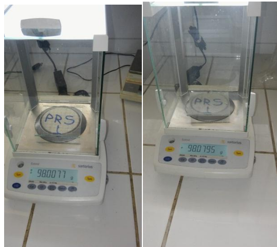
Figura 6.8. Pesado en laboratorio de la placa receptora Sevilla (PRS-01) ubicada en el punto de monitoreo Sevilla (Muestreo N° 3): Izquierda peso inicial. Derecha peso final.
