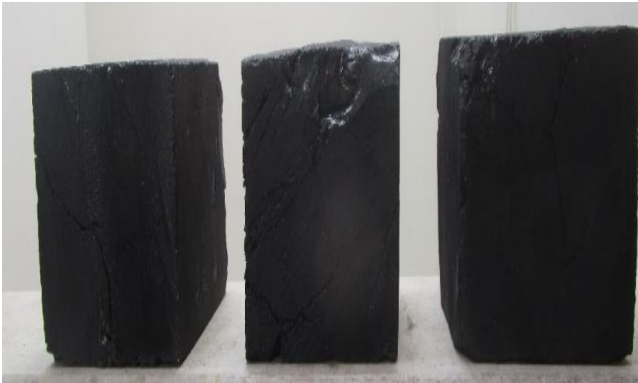
Foto 26: Muestras cortadas en cubos 10 cm de lado
