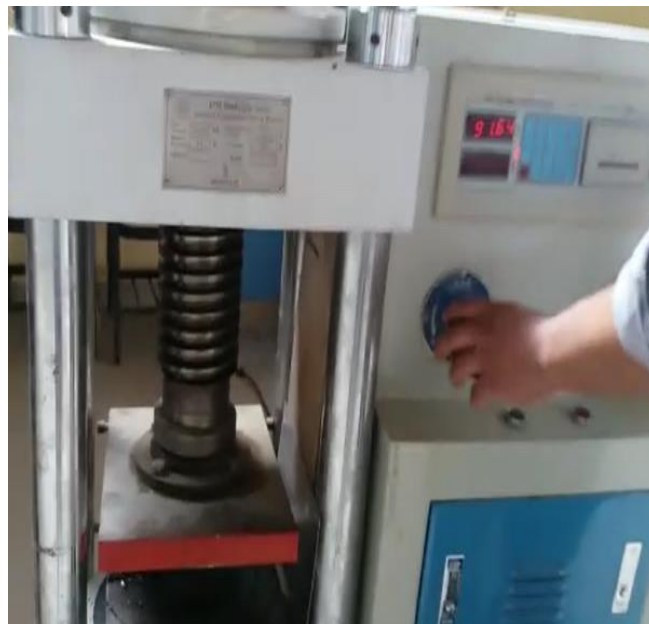
Foto 31: Medida la fuerza aplicada sobre la muestra 91,64 KN
