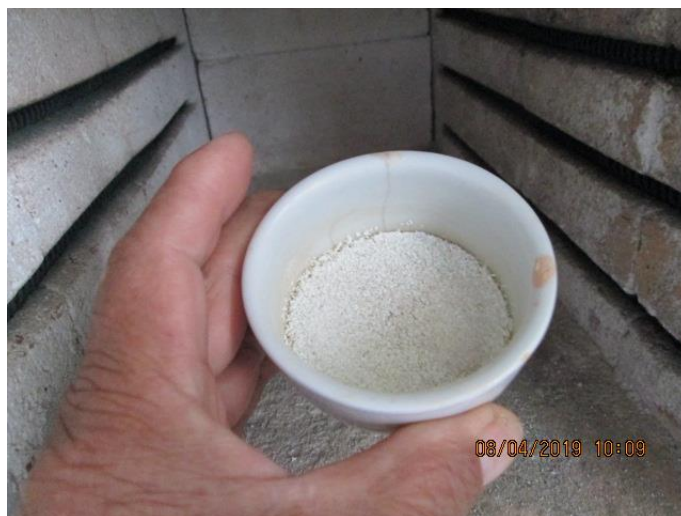
Foto 13: Muestra Calcinada de carbón antracítico.
