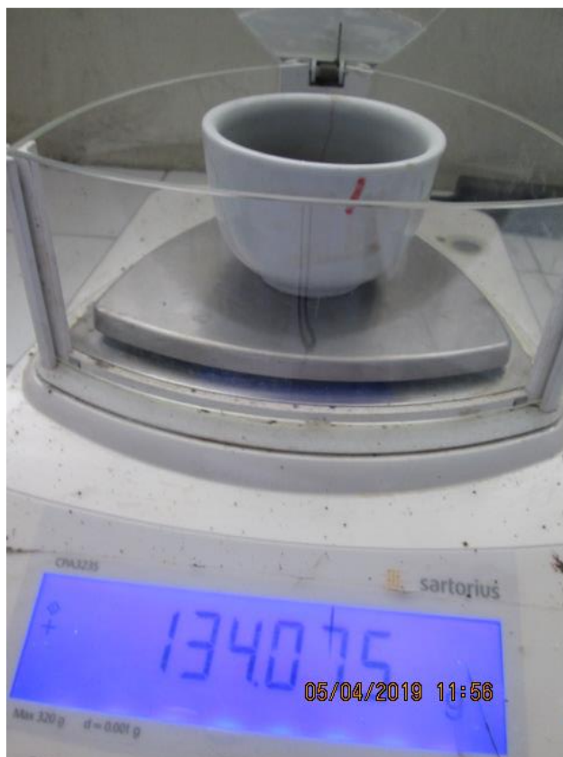
Foto 10: Peso de la muestra con el crisol
