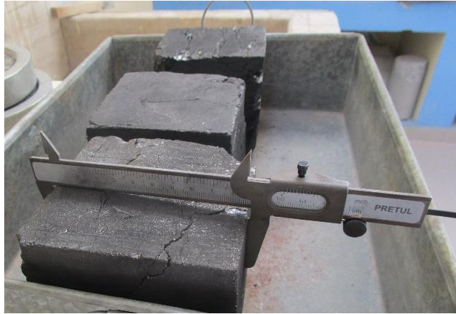
Foto 28: Medida con el vernier las dimensiones de la Muestra
