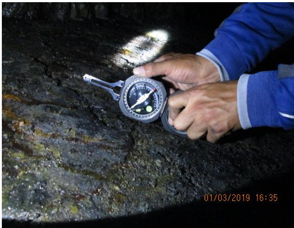
Foto 2: Medida del Buzamiento con brújula tipo Brunton
