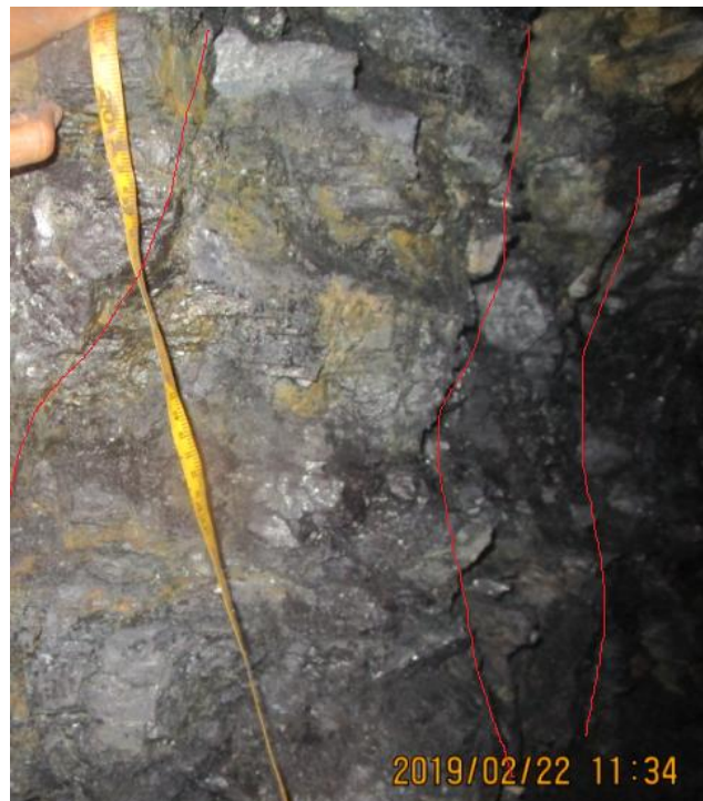
Foto 22: Ventana 6 presenta 3 discontinuidades
