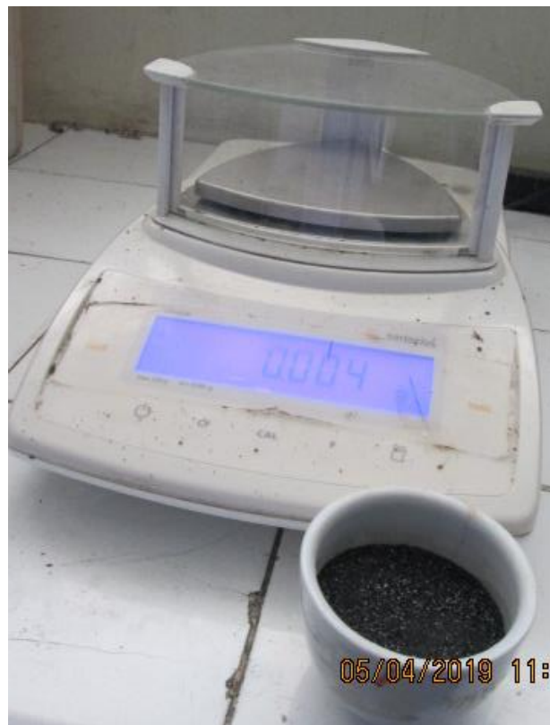
Foto 9: Balanza de precisión CPA623S
