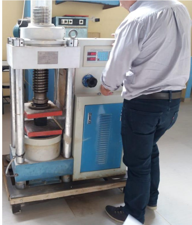
Foto 30: Dando inicio el rompimiento de la roca
