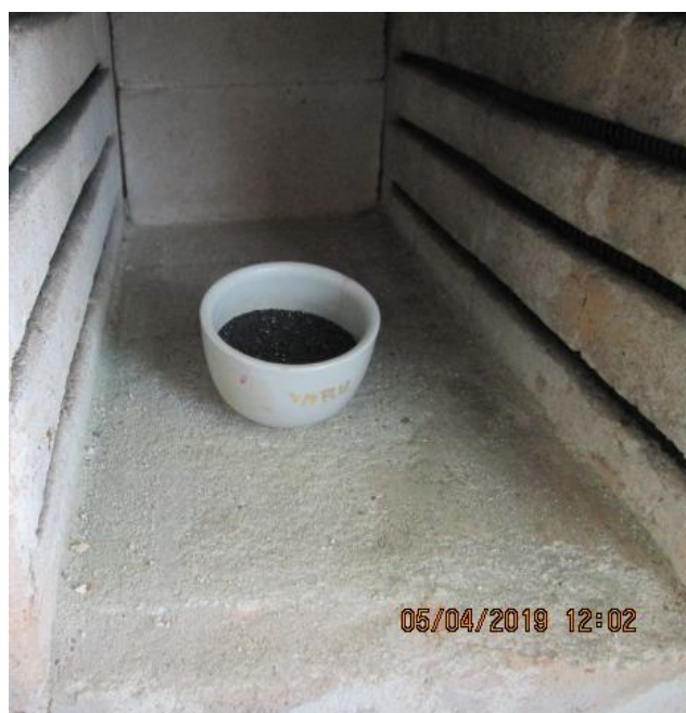
Foto 11: Muestra en la estufa del carbón antracítico.
