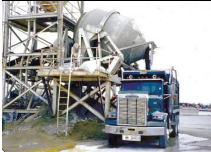
Figura N° 3: Método discontinuo con Tambores Mezcladores Inclínados Fuente: Portland Cement Association – PCA (2006)
