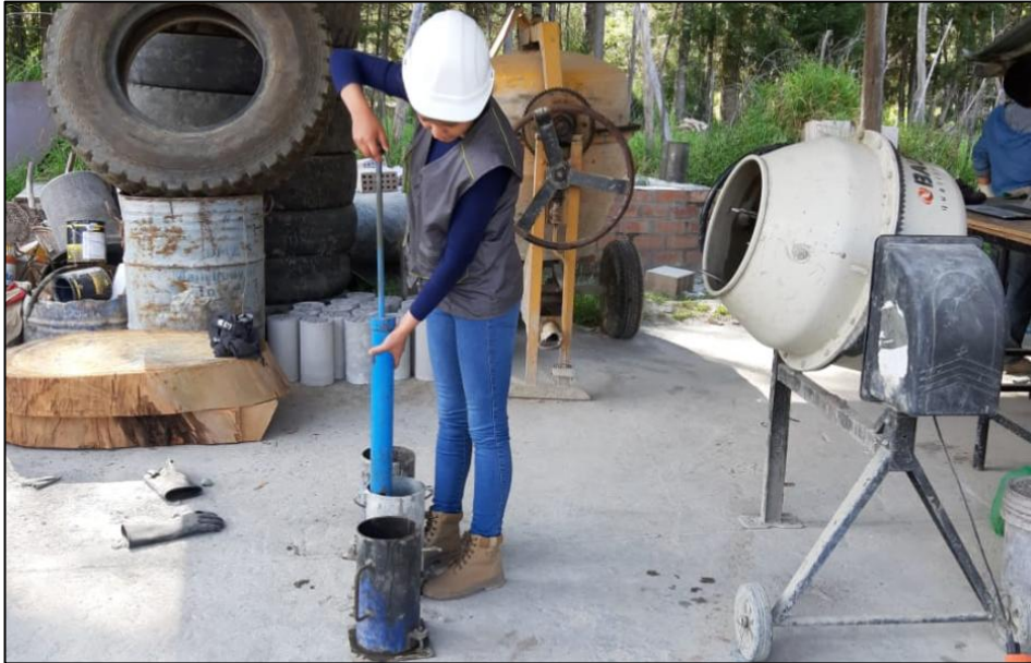
Fotografía N° 19: Elaboración y compactación de los especímenes de concreto..
