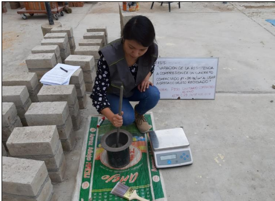
Fotografía N° 11: Ensayo de Peso unitario compactado del agregado fino
