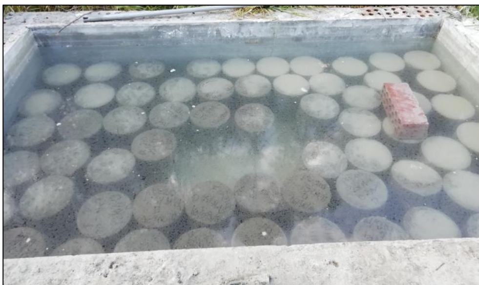
Fotografía N° 23: Curado de probetas de concreto con cal
