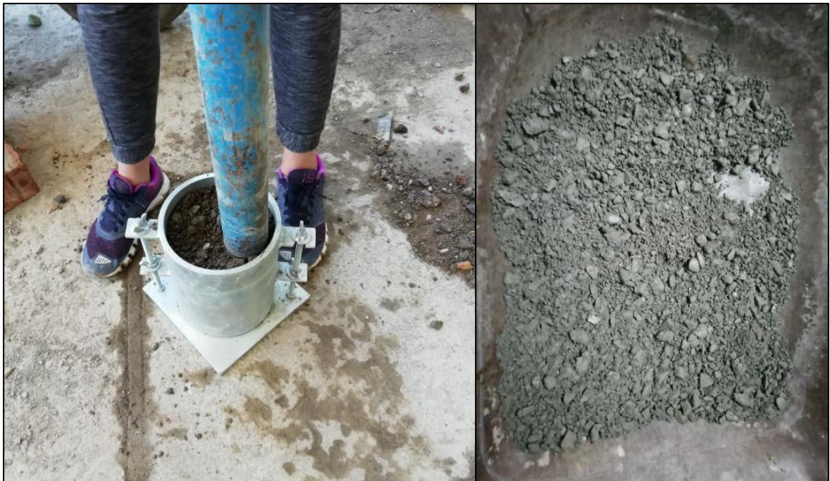
Fotografía N° 14: Determinación del contenido de humedad mediante el ensayo Proctor Modificado
