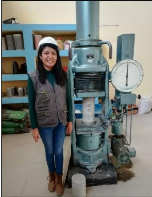
Fotografía N° 25: Máquina Universal para determinar resistencia a la compresión
