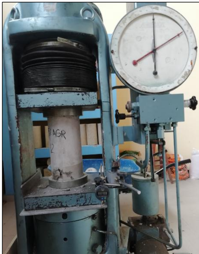
Fotografía N° 26: Ensayo de resistencia a la compresión
