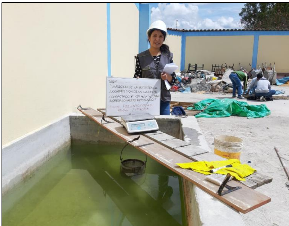
Fotografía N° 8: Ensayo de Peso específico del agregado grueso
