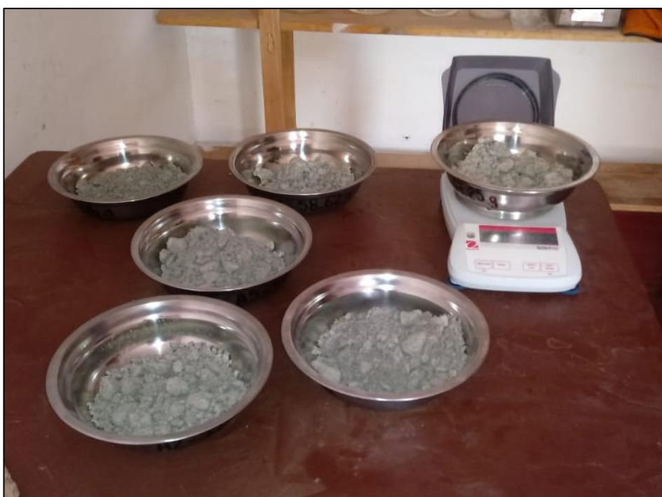
Fotografía N° 16: Toma de muestras representativas para la obtención del contenido de humedad
