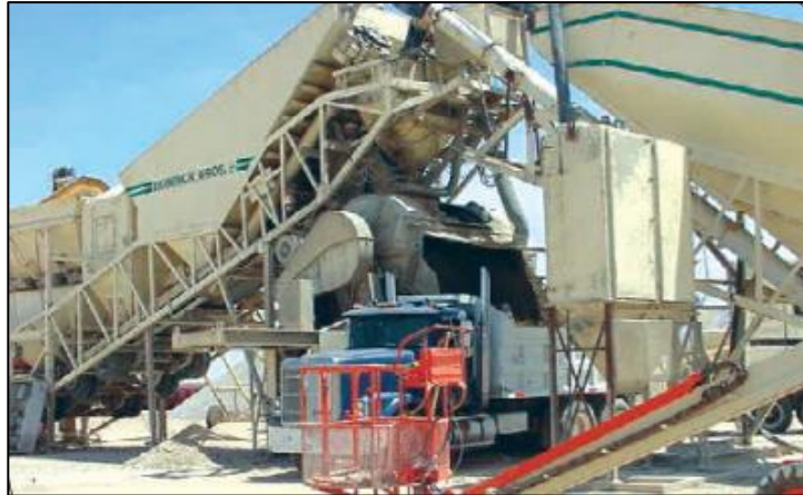
Figura N° 5: Método continuo con Mezclador de eje horizontal Fuente: Portland Cement Association – PCA (2006)
