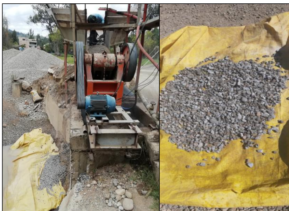
Fotografía N° 4: Trituración de concreto reciclado para obtener agregado grueso reciclado
