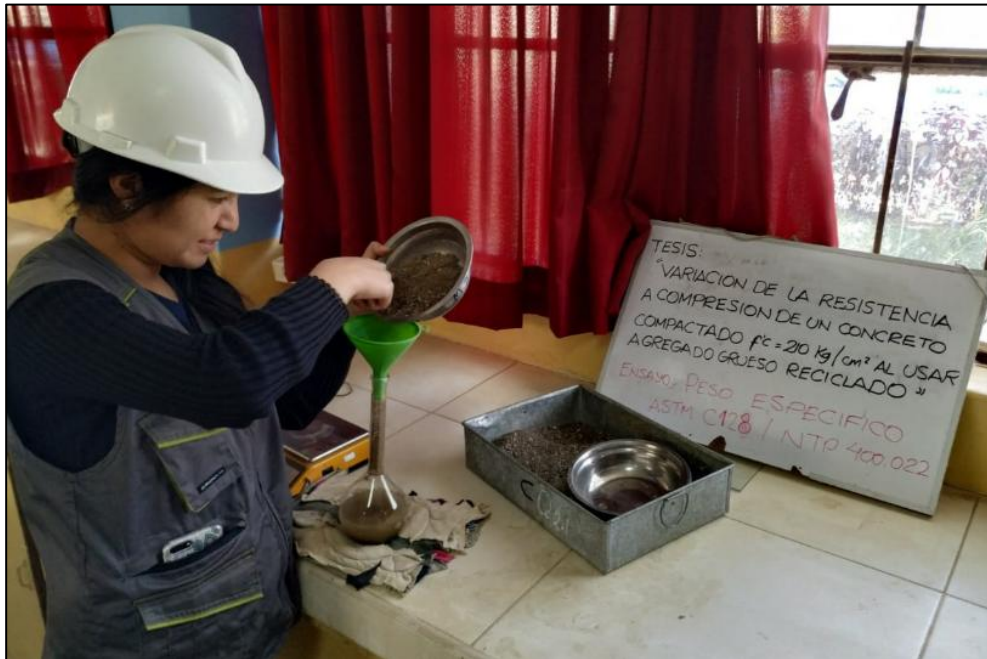
Fotografía N° 7: Ensayo de peso específico de agregado fino
