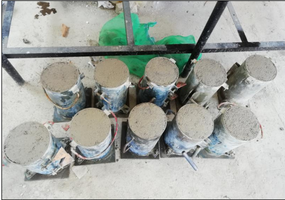
Fotografía N° 21: Probetas de concreto compactado elaboradas con reemplazo de agregados grueso por agregado grueso reciclado
