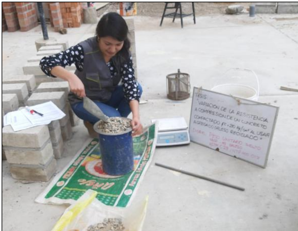
Fotografía N° 10: Ensayo de Peso unitario suelto del agregado grueso
