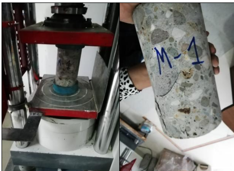
Fotografía N° 3: Determinación de la resistencia a compresión del núcleo de concreto endurecido
