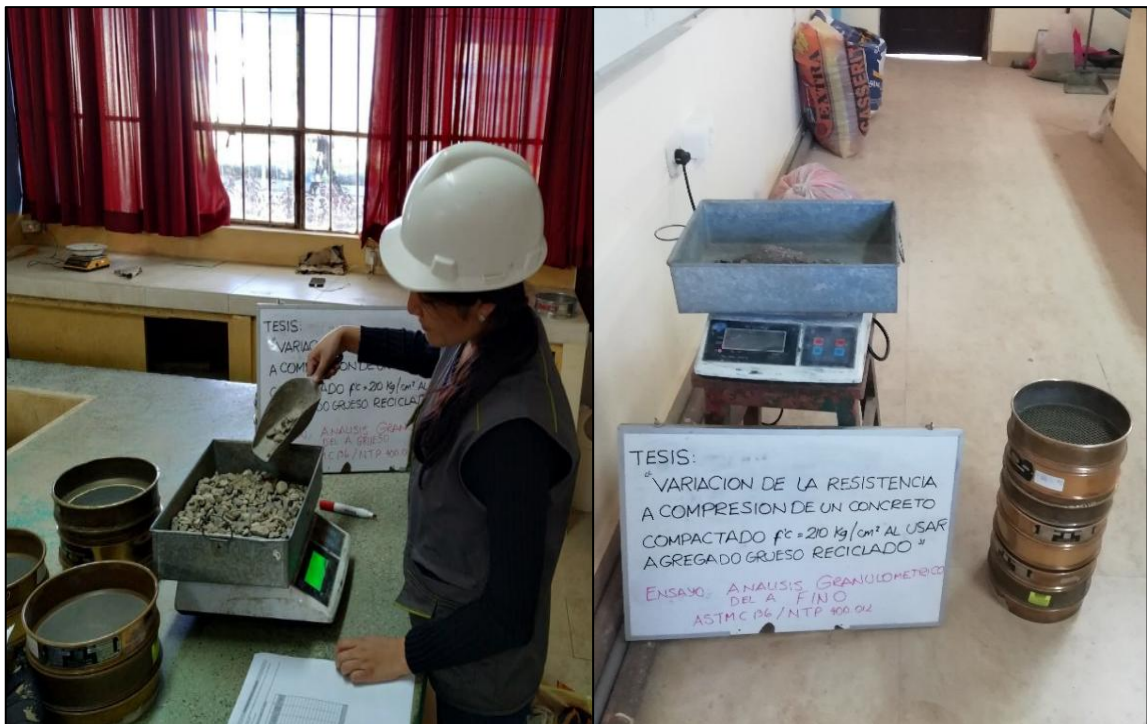
Fotografía N° 6: Ensayo de análisis granulométrico de agregados
