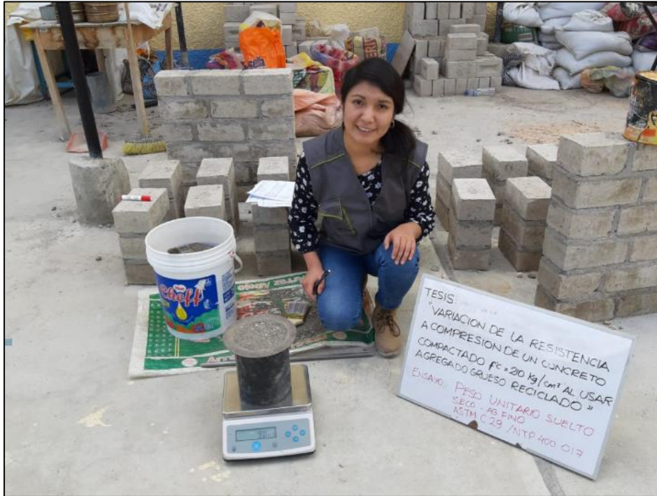
Fotografía N° 9: Ensayo de Peso unitario suelto del agregado fino
