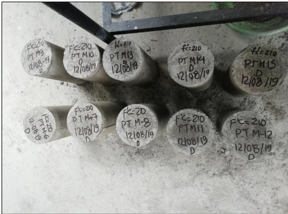
Fotografía N° 22: Identificación y codificación de probetas de concreto
