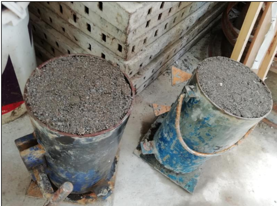
Fotografía N° 20: Probetas de concreto compactado elaboradas con agregados naturales
