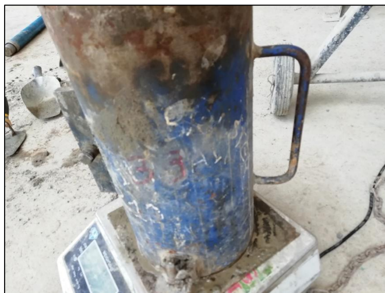
Fotografía N° 24: Determinación del peso de probetas, para calcular el peso unitario del concreto fresco
