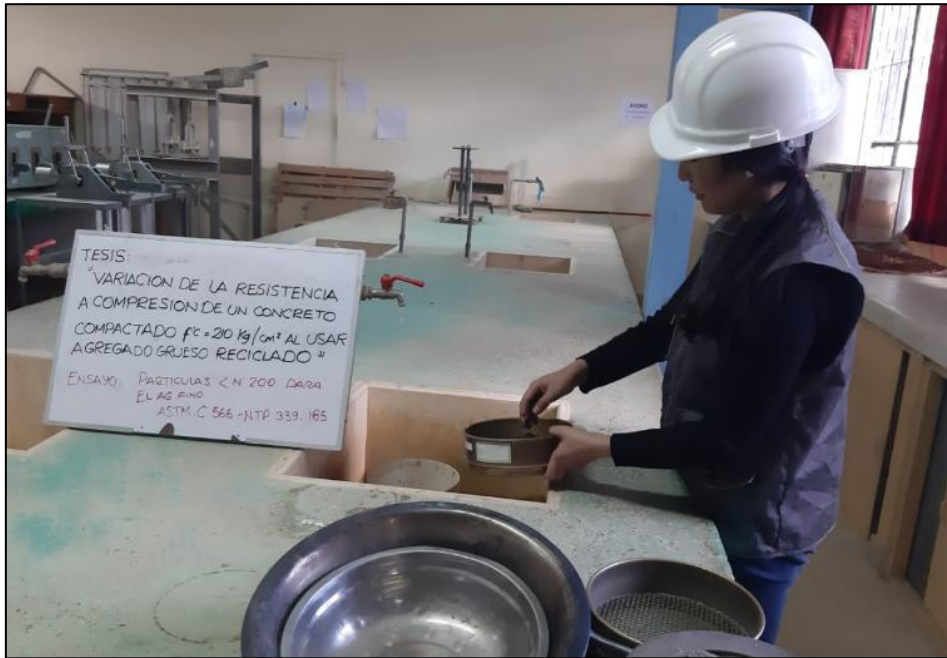
Fotografía N° 13: Ensayo de porcentaje de finos que pasan el tamiz N°200.
