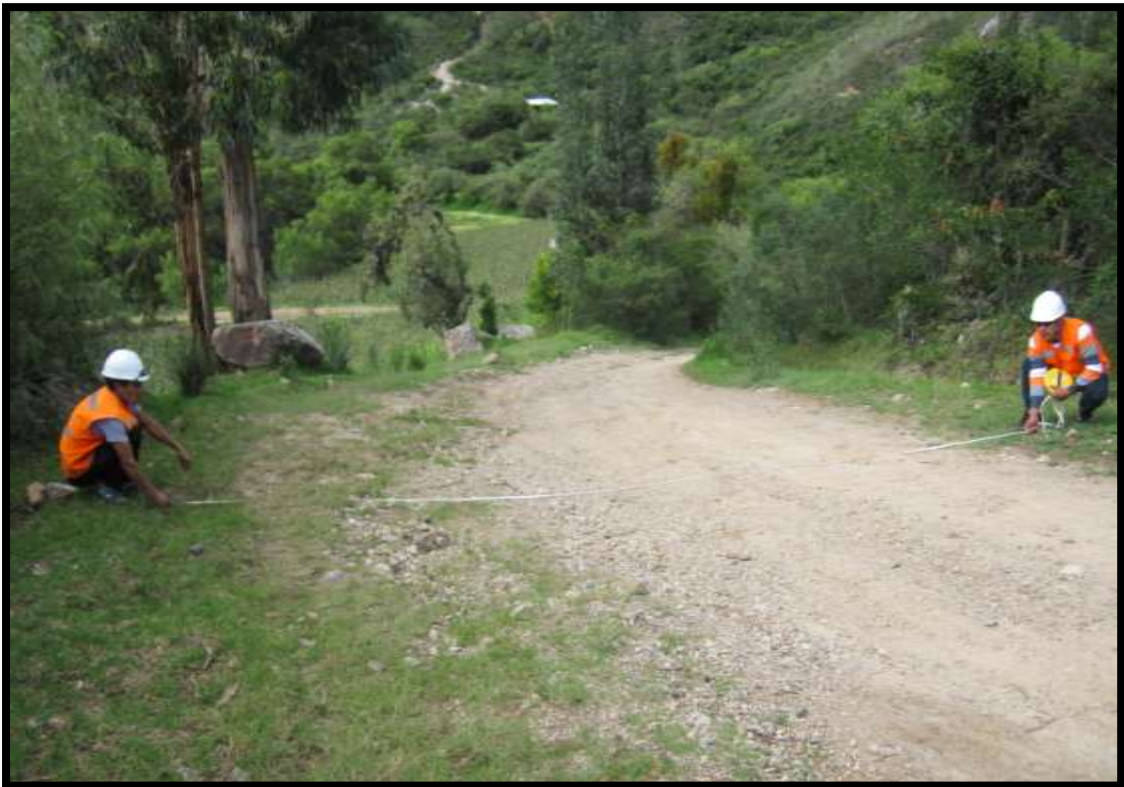
Fotografía N° 18: Toma de datos del ancho de plataforma.
