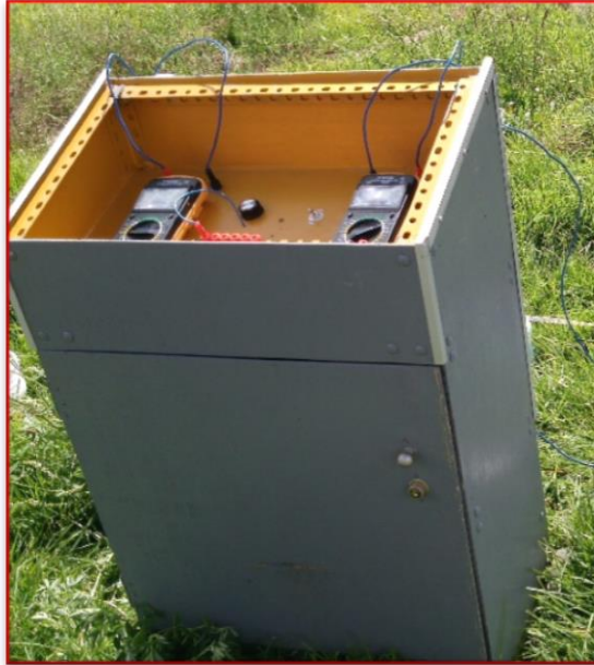
Fotografía 2: Equipo para medir resistividad eléctrica de suelos.
