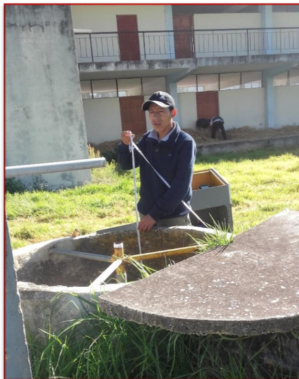
Fotografía 6: Toma de dato del nivel estático en el pozo del Fundo La Victoria.
