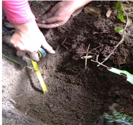
Figura 34. Medición de la profundidad de la semi - calicata.
