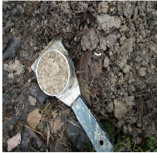
Figura 16. Cilindro con muestra de suelo para determinar densidad aparente.
