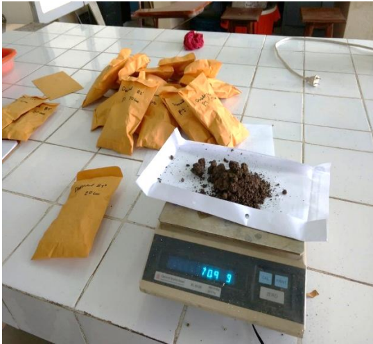
Figura 19. Pesado del suelo seco para determinar densidad aparente.
