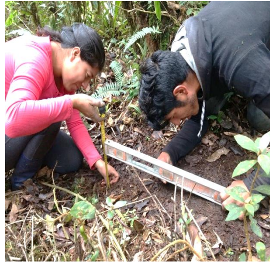
Figura 30. Mediciones para determinar la pendiente de la parcela.
