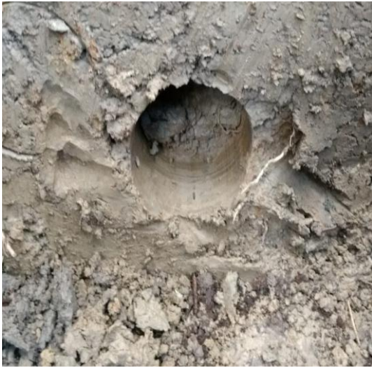
Figura 15. Marca del cilindro en la recolección de muestras de suelo para determinar densidad aparente.
