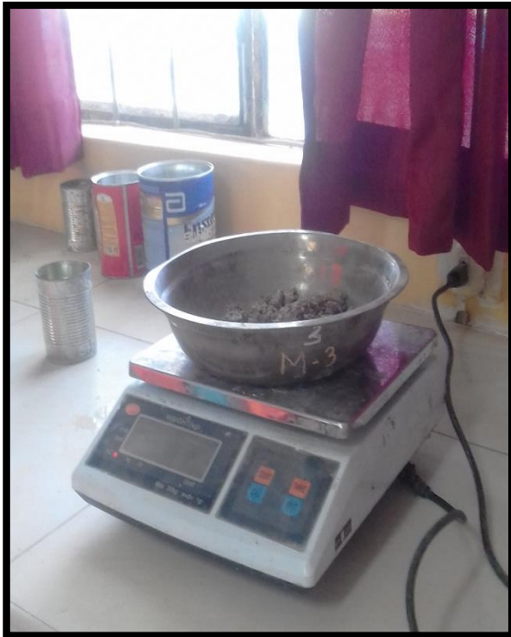
Figura 25: Contenido de humedad (próctor modificado).
