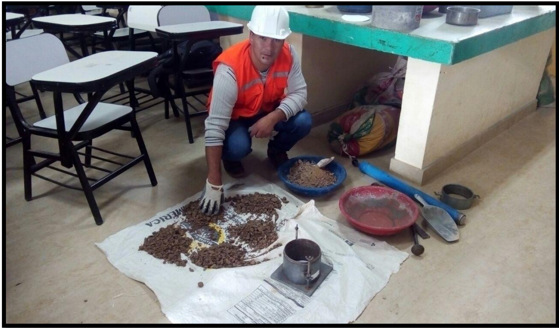
Figura 23: Separación de material en 5 partes, para próctor modificado.
