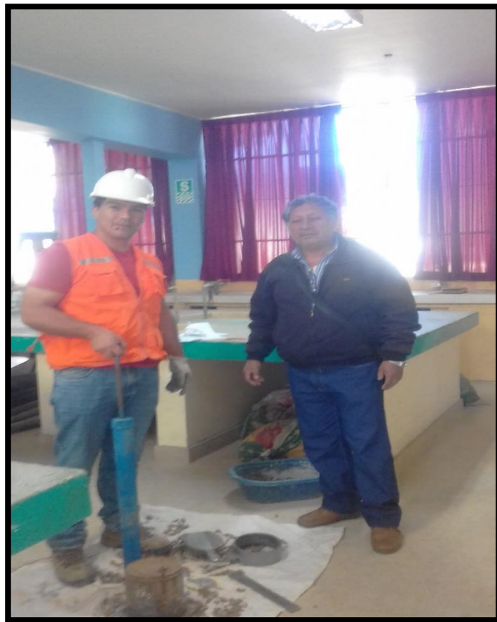
Figura 27: Asesor y tesista realizando la compactación para el ensayo de CBR.
