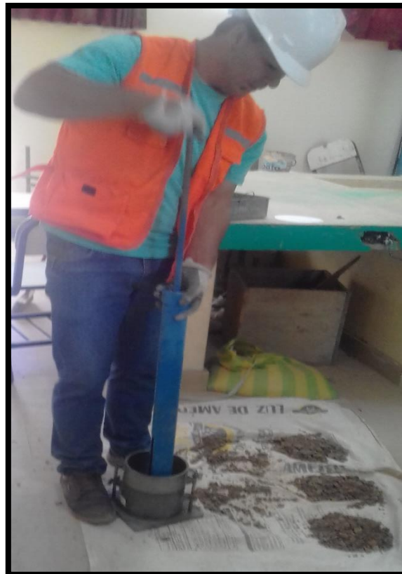
Figura 24: Compactación de material en 5 capas, con 56 golpes por capa, para próctor modificado.
