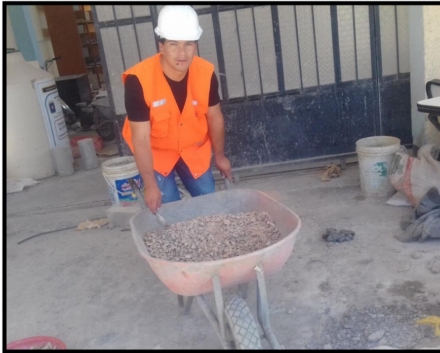
Figura 21: Material resultante de la mezcla de los materiales de la cantera El Guitarrero con piedra chancada del Río Chonta para próctor Modificado.
