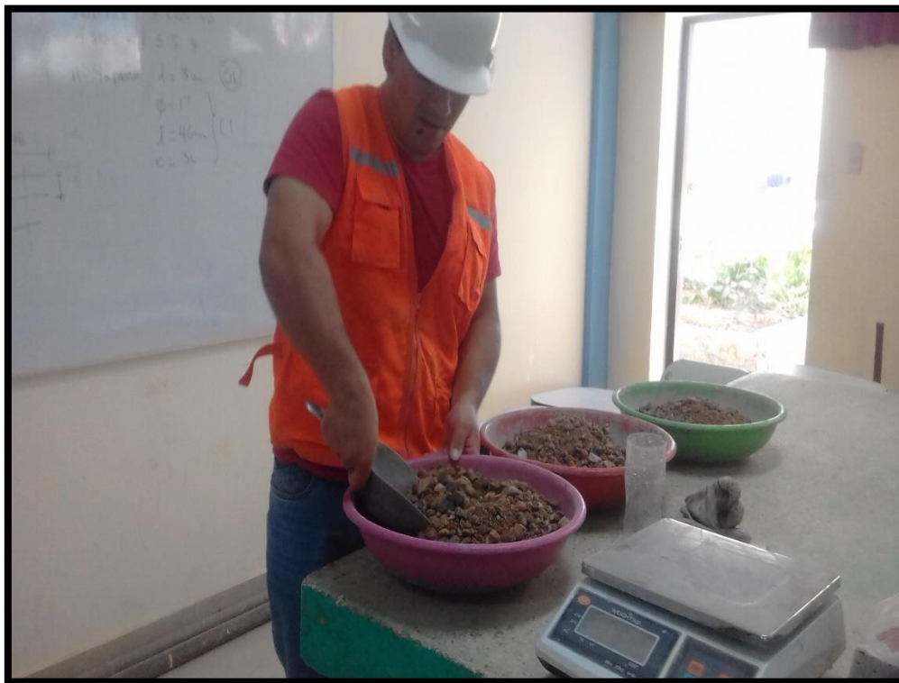
Figura 26: Preparación de muestras de material para el ensayo de CBR (Ensayo de Relación de Soporte de California).
