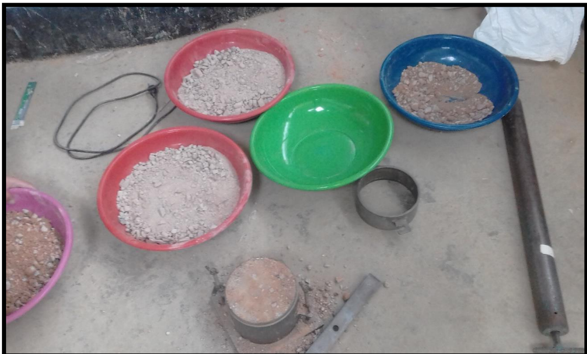
Figura 22: Preparación de muestras de material para la compactación con diferentes humedades (próctor modificado).
