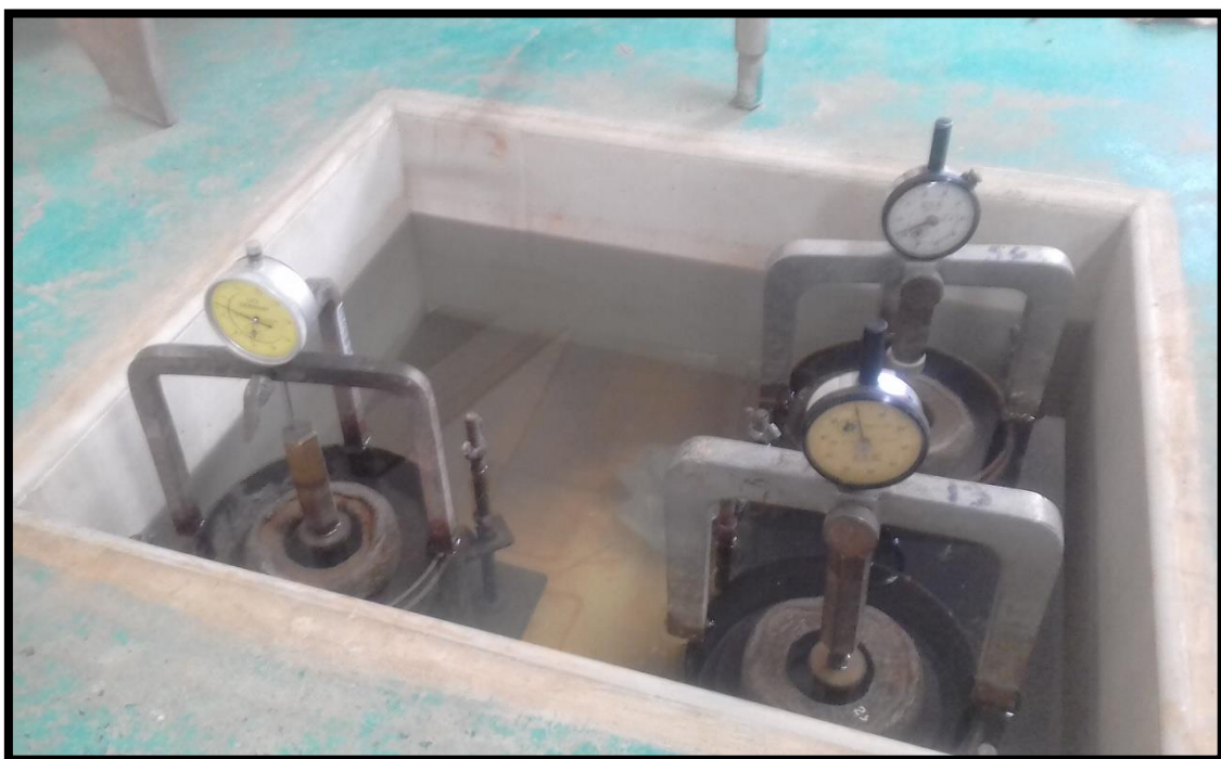
Figura 28: Saturación de muestras durante 96 horas para la medición de la expansión.
