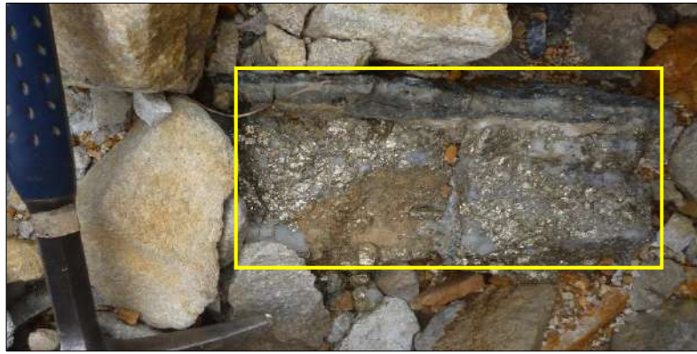
Figura 63. Afloramiento de veta de alta sulfuración constituido por pirita, cuarzo, enargita y alrededor circundante por bloques, cantos, gravas, arenas, limos de diferente composición; ubicado en el cauce de la zanja de drenaje Qda. C o Jesús al lado NW.
