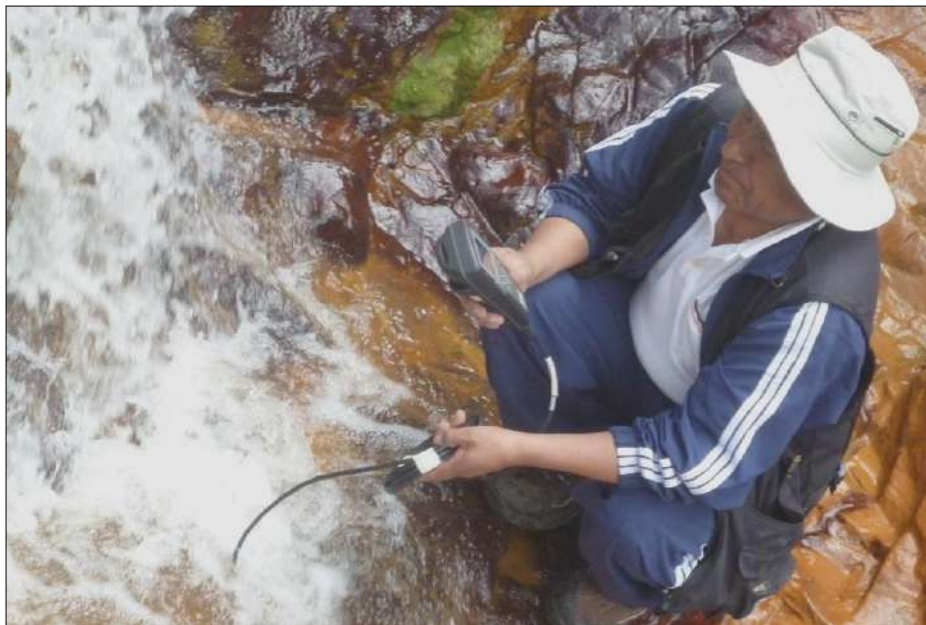
Figura 51. El equipo de pH, digital en la determinación del valor en el campo in situ , sin variación alguna, para elaboración de los cuadros estadísticos.
