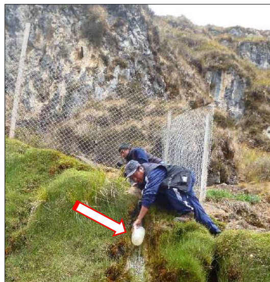
Figura 71: Determinación del volumen por el método volumétrico en los puntos MP-1 Qda. Pozo Ricos -Corona (Izq.) y MP-4 Bocamina la Zarza (Dech.)
