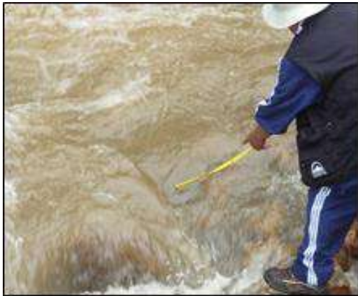
Figura 73. Se observa medida de la profundidad (h) en la sección del río Hualgayoc MP-7, para calcular el área del canal.
