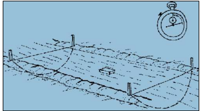
Figura 72. Se observa medida de longitud, ancho y profundidad en el río Hualgayoc, para calcular el flujo por el método del flotador ubicado en el punto de monitoreo MP-7 . Equivalente al punto permanente ALA. RHual2
