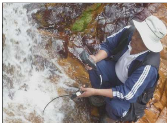
Figura 54. Se observa el muestreo de agua ácida en MP-1 y la determinación del pH. en la Qda. de Pozo Ricos- Corona, ubicado en la intersección de la trocha carrozable a Hualgayoc, Pozo Ricos -las Coloradas.
