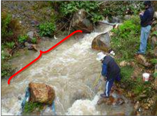
Figura 72. Se observa medida de longitud, ancho y profundidad en el río Hualgayoc, para calcular el flujo por el método del flotador ubicado en el punto de monitoreo MP-7 . Equivalente al punto permanente ALA. RHual2
