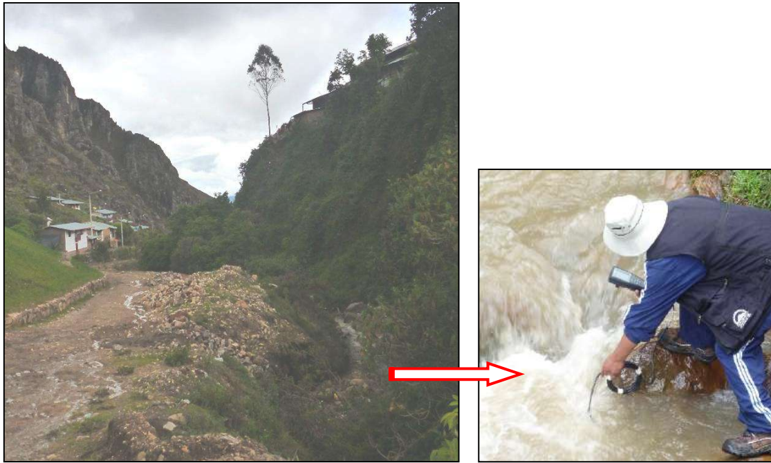
Figura 52. Se aprecia el cañón del río Hualgayoc después de la confluencia con la Qda. Mesa de Plata, realizando la medición del pH. in situ (MP-7)
