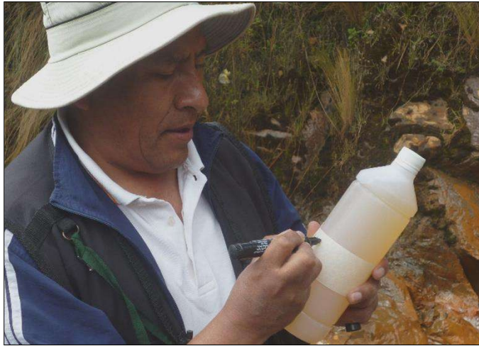
Figura 50. Etiquetado muestras de agua realizados en los drenajes de PAM's en la microcuenca Mesa de Plata.
