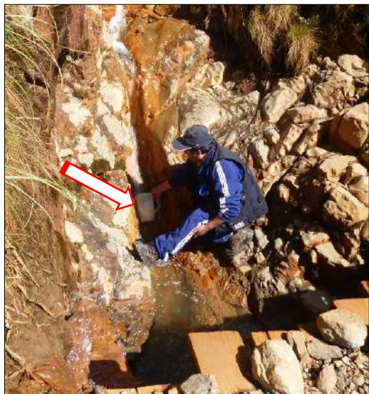
Figura 71: Determinación del volumen por el método volumétrico en los puntos MP-1 Qda. Pozo Ricos -Corona (Izq.) y MP-4 Bocamina la Zarza (Dech.)
