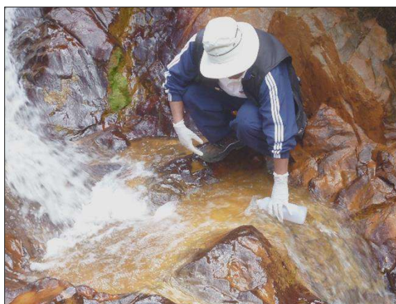
Figura 55. Se aprecia muestreo de agua ácida en MP-2 y la determinación del pH. con Peachímetro digital con protocolo establecido; en la Qda. C o Jesús -Hualgayoc.
