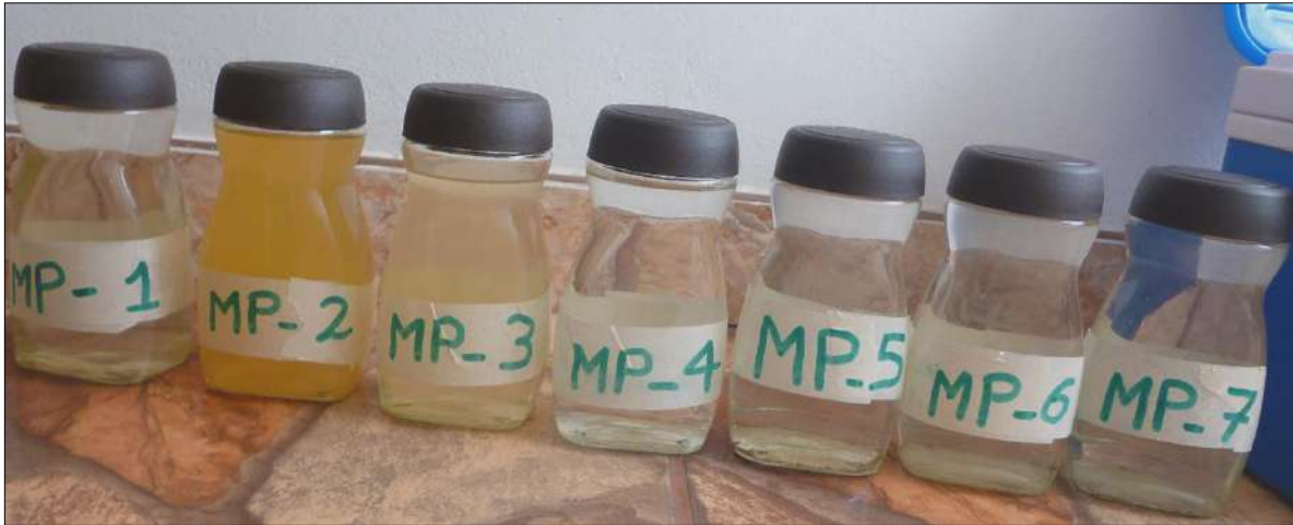
Figura 16. Muestras de agua realizadas en los drenajes de PAM's. en la microcuenca Mesa de Plata, MP1 al MP7, para él envío al laboratorio.
