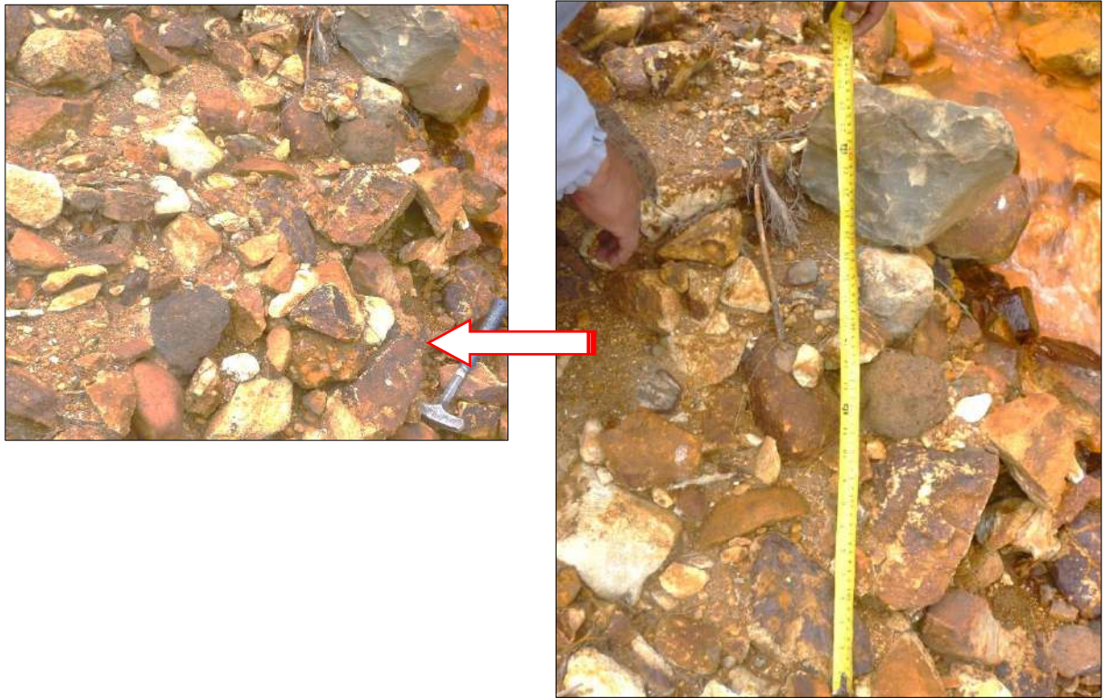
Figura 47. Pasivo Ambiental (sólido) bloques, cantos, gravas, arena, limos y arcillas en el lecho de la zanja de drenaje, ubicado en la Qda. del Cerro Jesús.
