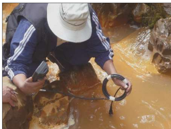
Figura 55. Se aprecia muestreo de agua ácida en MP-2 y la determinación del pH. con Peachímetro digital con protocolo establecido; en la Qda. C o Jesús -Hualgayoc.
