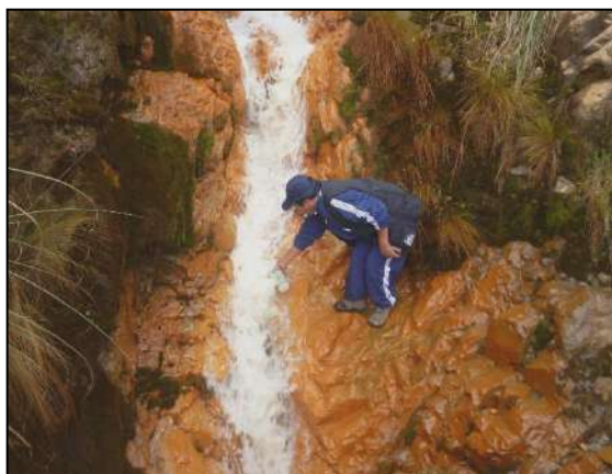
Figura 54. Se observa el muestreo de agua ácida en MP-1 y la determinación del pH. en la Qda. de Pozo Ricos- Corona, ubicado en la intersección de la trocha carrozable a Hualgayoc, Pozo Ricos -las Coloradas.
