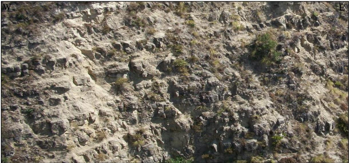
*Foto N° 26. Afloramiento del macizo rocoso de la Formación Mujarrum, mostrando una blocosidad irregular por múltiple fracturamiento.*
