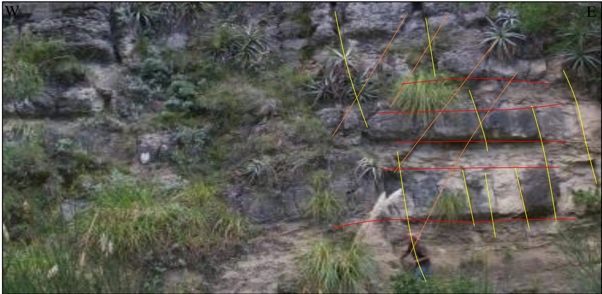
*Foto N° 25. Afloramiento del macizo rocoso de la Formación Yumagual, mostrando los sets de fracturas principales.*
