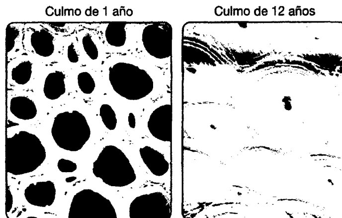
Figura N° 14: Lignificación de las fibras de un culmo de Guadua
