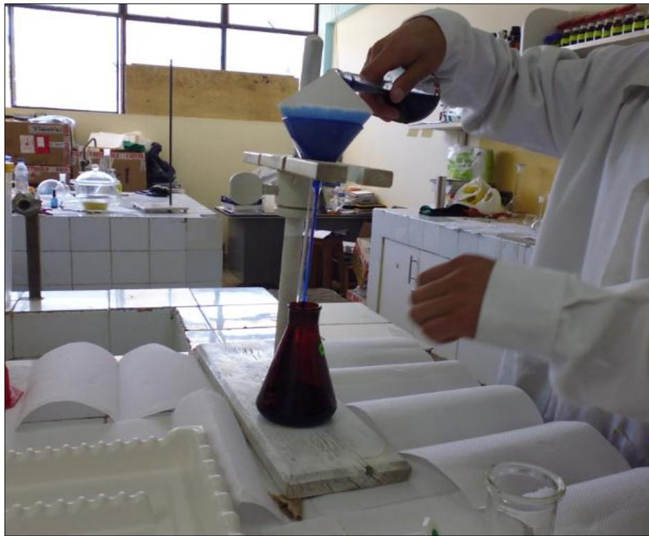
**Figura 22.** Preparación del 2,6-diclorofenol-indofenol
