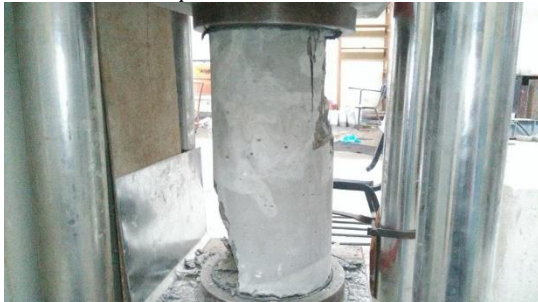
Figura N° 22: Vista posterior de la falla típica de espécimen de concreto.
