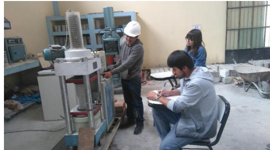
Figura N° 23: Ensayo a compresión de los especímenes de concreto.
