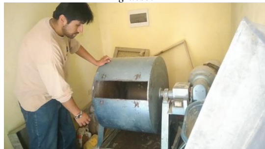
Figura N° 11: Resistencia a la abrasión del agregado grueso.
