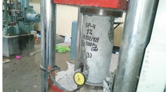
Figura N° 21: Falla típica del espécimen de concreto.
