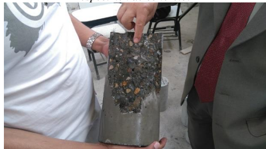
Figura N° 19: Vista de agregado grueso dentro del espécimen de concreto.
