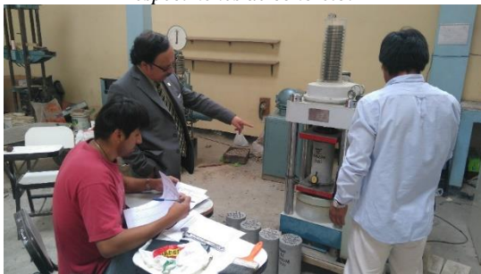
Figura N° 18: Ensayos a compresión de los especímenes de concreto.
