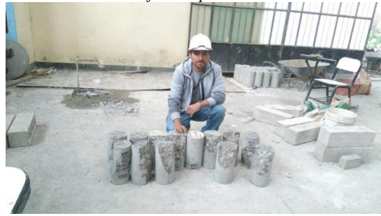
Figura N° 25: Especímenes ensayados con vista de fallas típicas.
