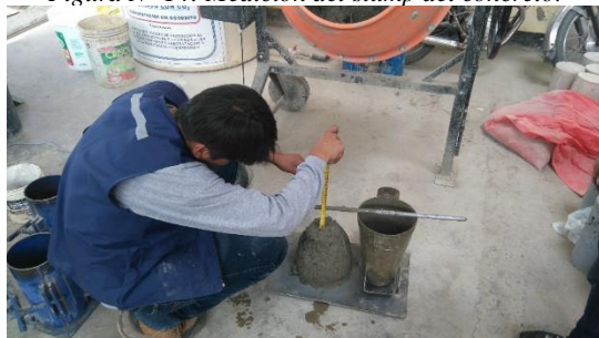
Figura N° 14: Medición del slump del concreto.
