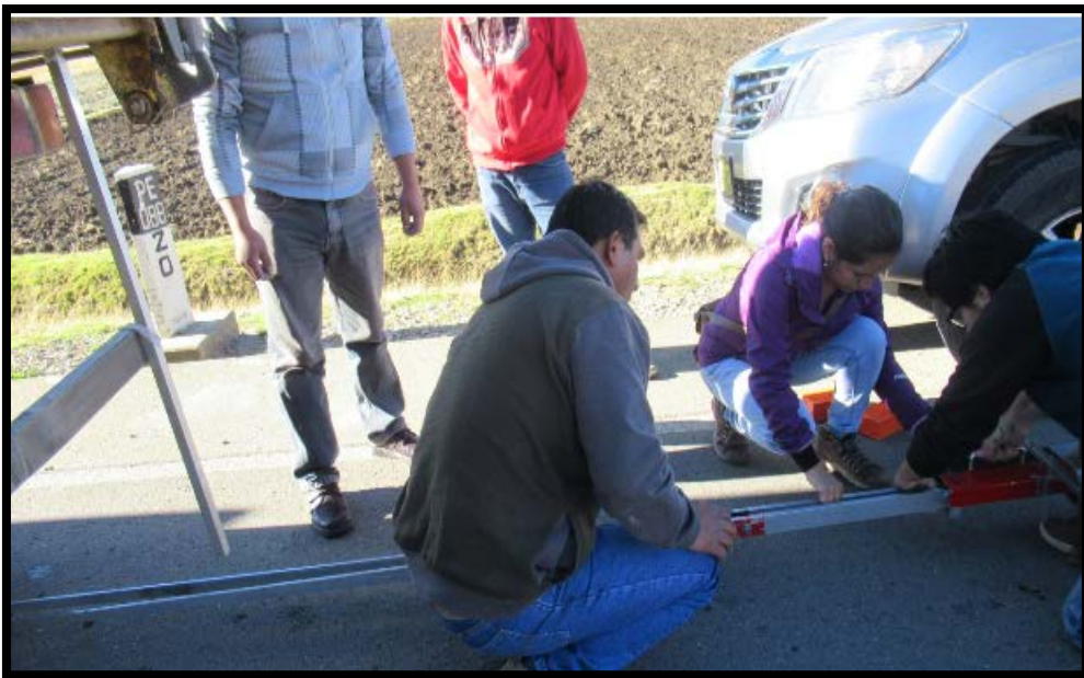
Figura 0.2. Armado de la Viga Benkelman.
