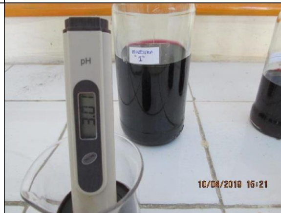
Medición de pH en muestras M1 y M2
