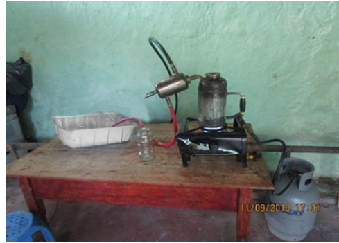
Figura 23. Recolección y destilación de la segunda muestra
