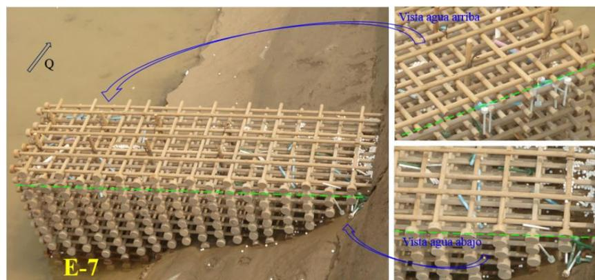
**Imagen 32.** Disposición final de las clavijas atascadas dentro del entramado del espigón 7, ensayo 2.
