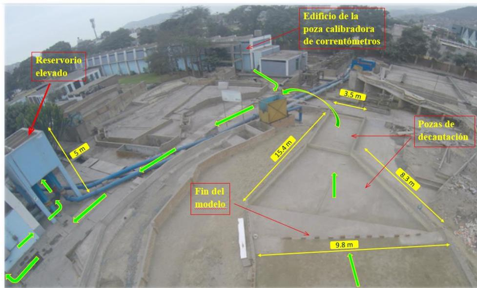
**Imagen 14.** Vista del final del modelo. Las flechas verdes indican la recirculación del flujo.
