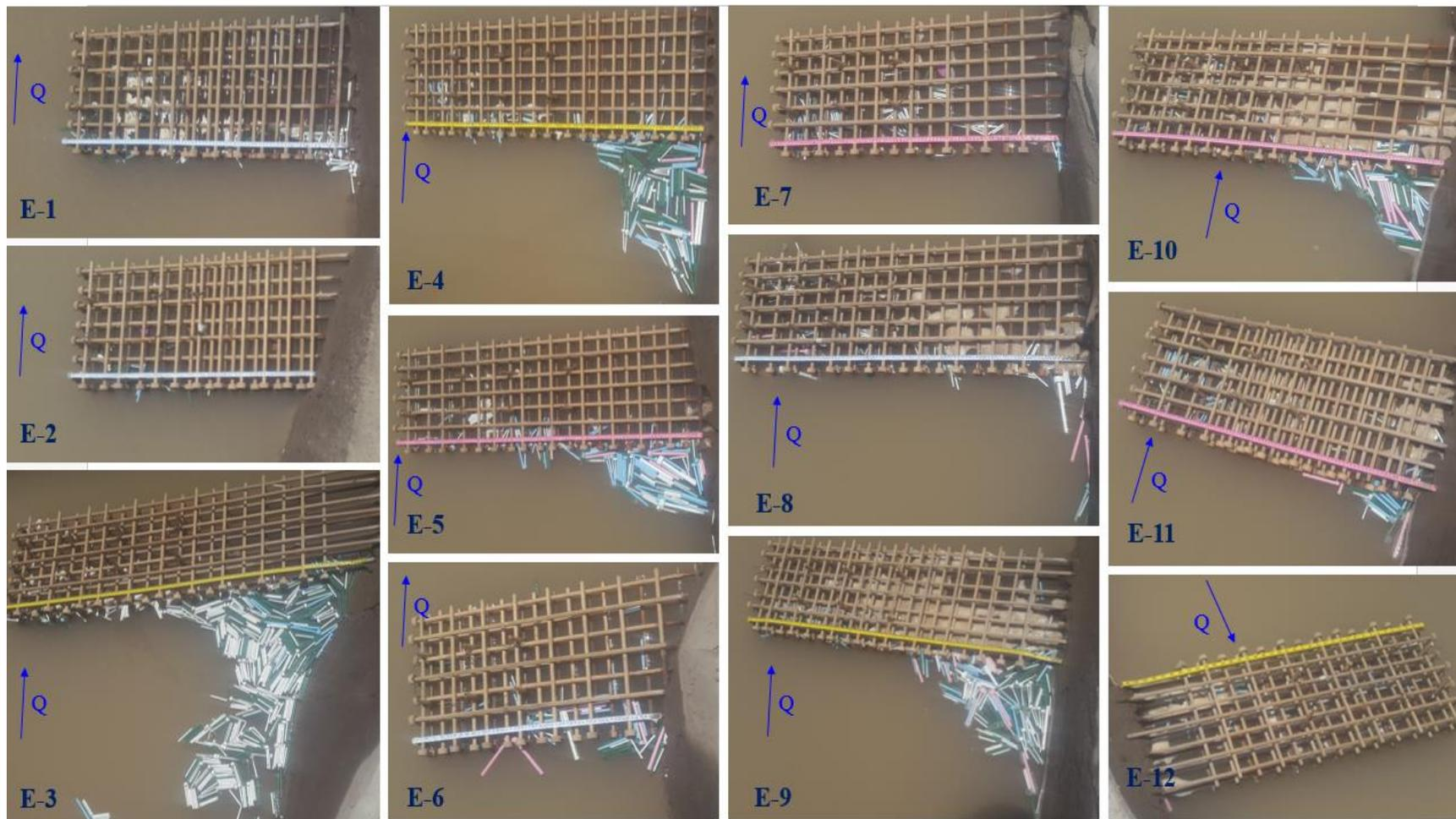
**Imagen 35.** Acumulaciones de clavijas en las zonas de empotramiento y laterales aguas arriba de los espigones ELJ, ensayo 4.
