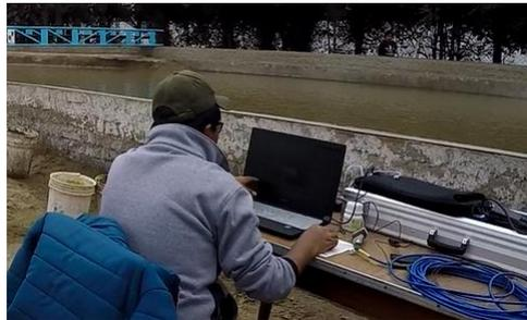
**Imagen 18.** Laptop conectada ADV mediante un cable azul de 30 metros.
