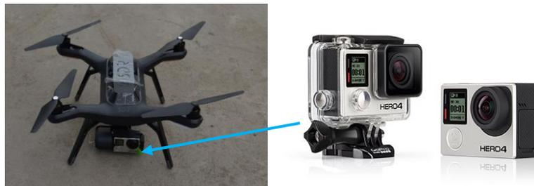
**Imagen 21.** Cámara filmadora Gopro Hero 4 montada en un dron 3DR-Solo.
