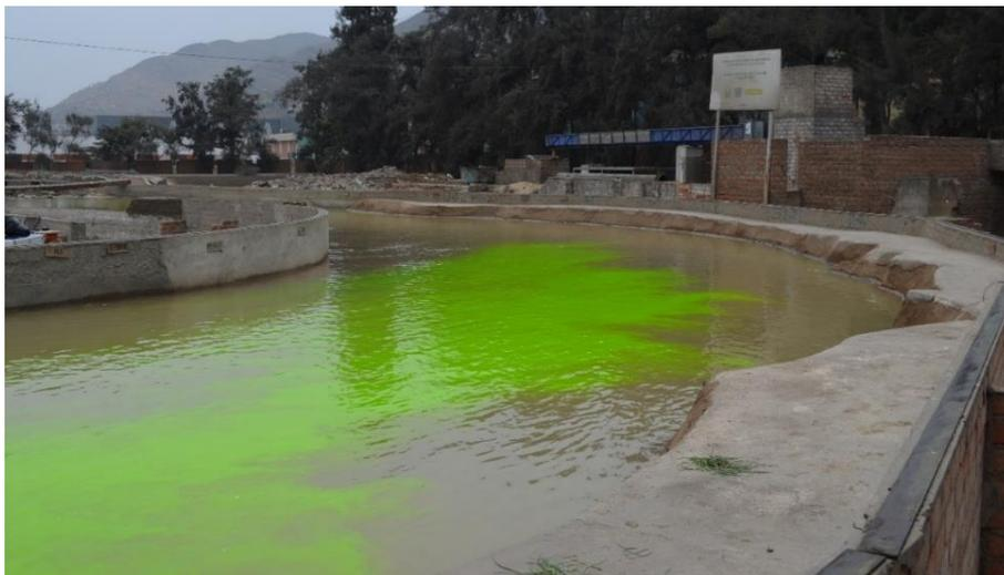
Ingreso a la curva del canal experimental de la fluoresceína arrojada para diferentes propósitos.
