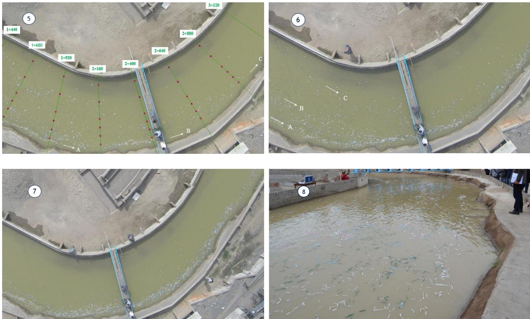
**Imagen 29.** Vista en planta del proceso de transporte de clavijas durante el ensayo 1 (fotografía 1-7). Vista del ingreso de las clavijas flotantes al tramo curvo (fotografía 8).
