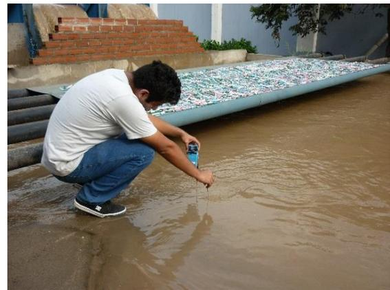
Imagen Izq. Colapso por socavación del banco externo al final de la curva en la sección estrecha. Imagen Der. Distribución de las clavijas de forma desordenada y medición de la temperatura del agua.
