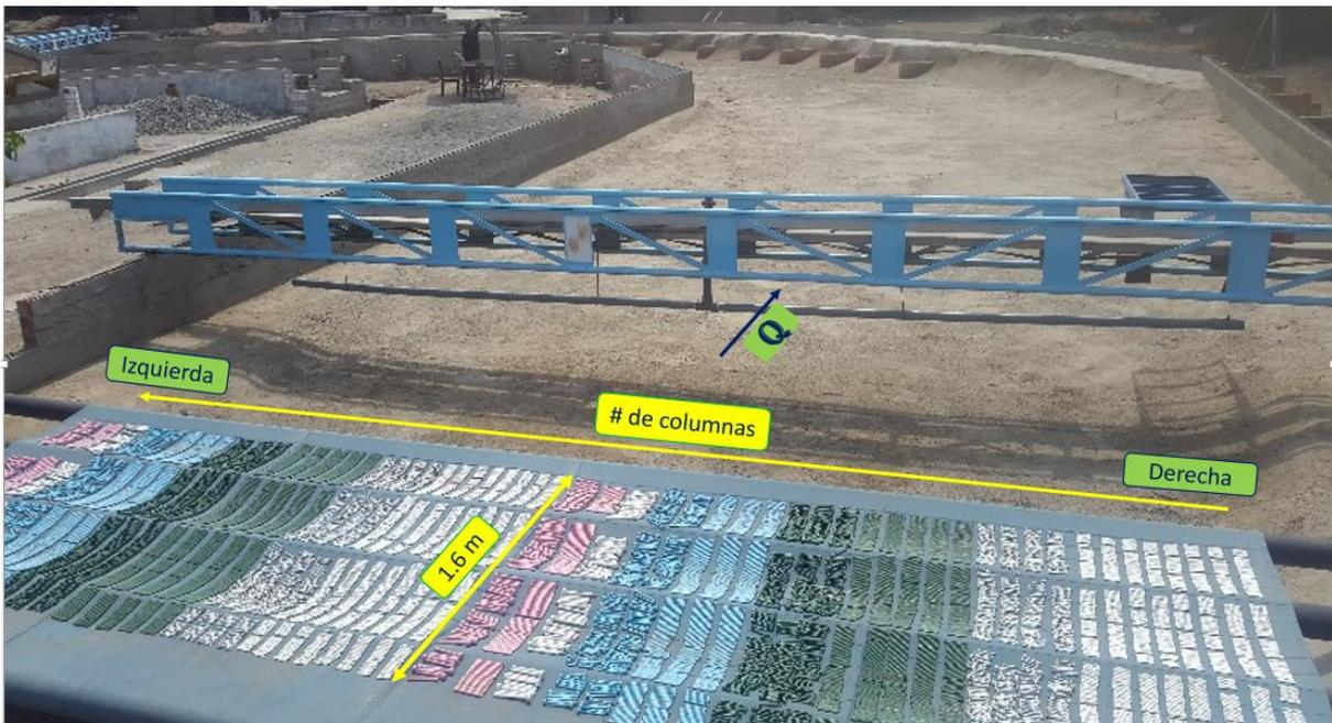
**Imagen 28.** Clavijas distribuidas en 56 columnas sobre la faja.
