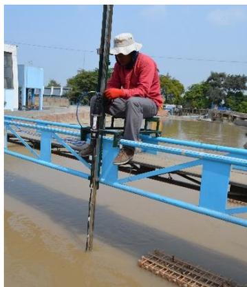
**Imagen 19.** Soporte Metálico móvil del ADV construido por el LNH.
