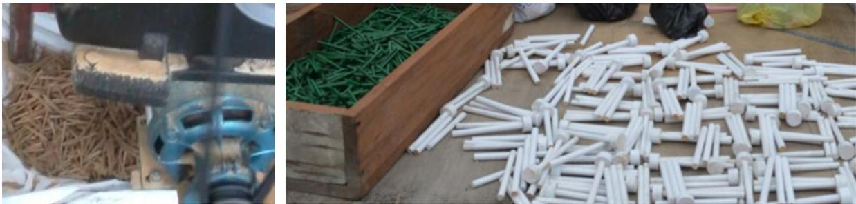
**Imagen 24.** Corte a longitudes determinadas de las clavijas en la maquina cortadora y su respectivo pintado en el taller de carpintería.
