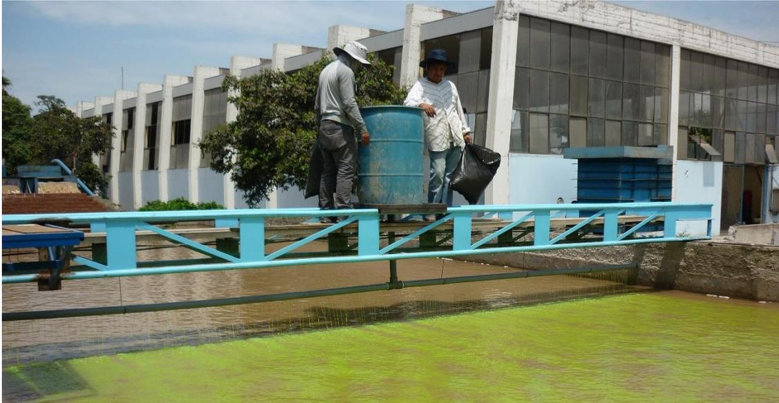
Apertura de la válvula globo para la inyección de la fluoresceína al canal experimental.
