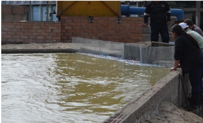
Malla metálica colocada al final del modelo para la retención de las clavijas.
