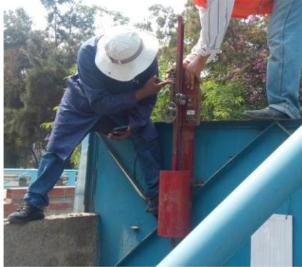
**Imagen 20.** Limnómetro para la medición de caudales en el vertedero izquierdo.
