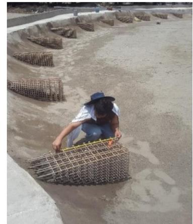
**Imagen 13.** Vista de la permeabilidad y empotramiento y distribución de los espigones ELJ en el modelo.
