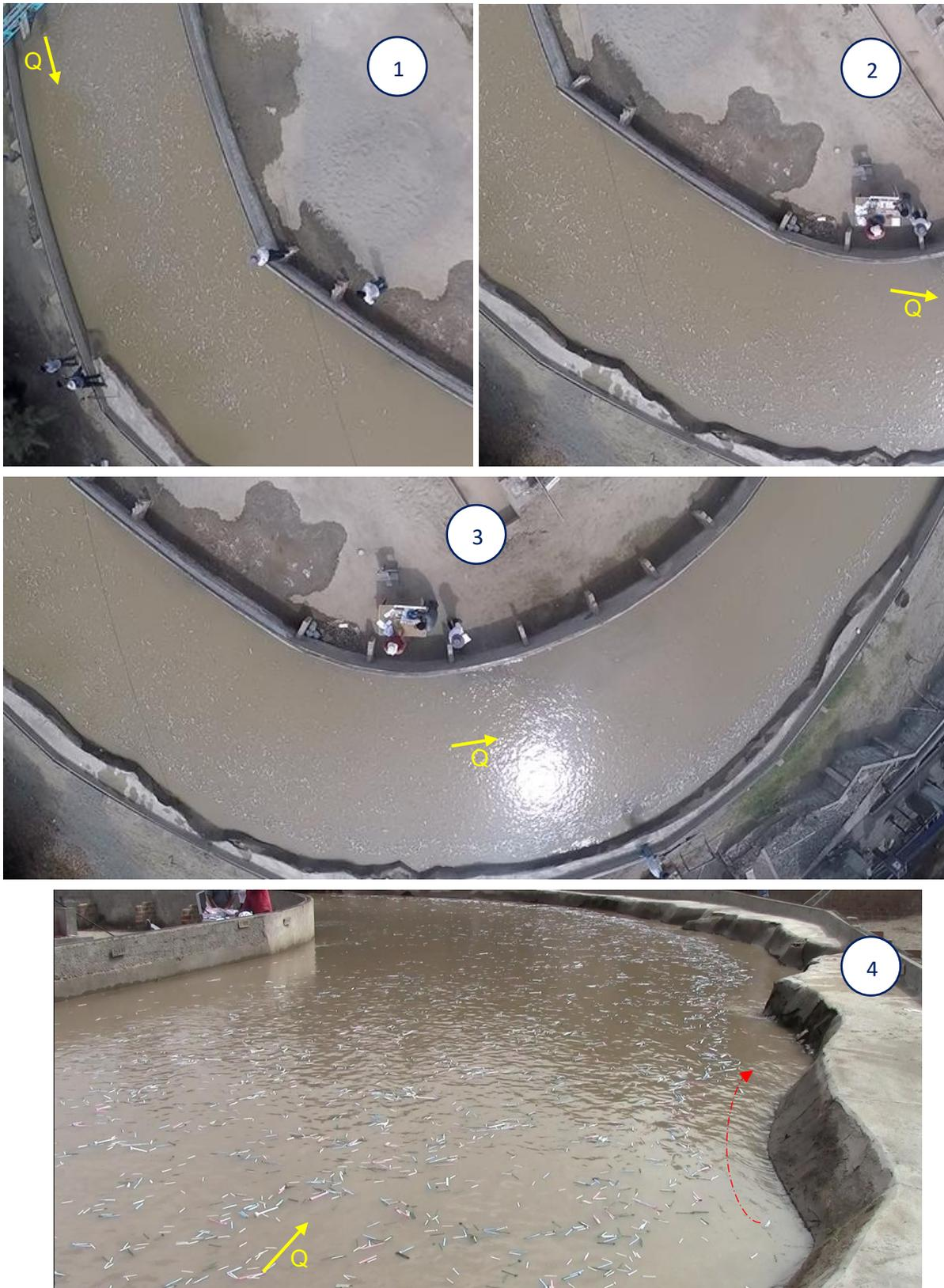
**Imagen 33.** Vista en planta del proceso de transporte de clavijas (fotografía 1-3). Formación del pasillo libre de clavijas a lo largo de la orilla curva (ver flecha roja en la fotografía 4). Ensayo 3.
