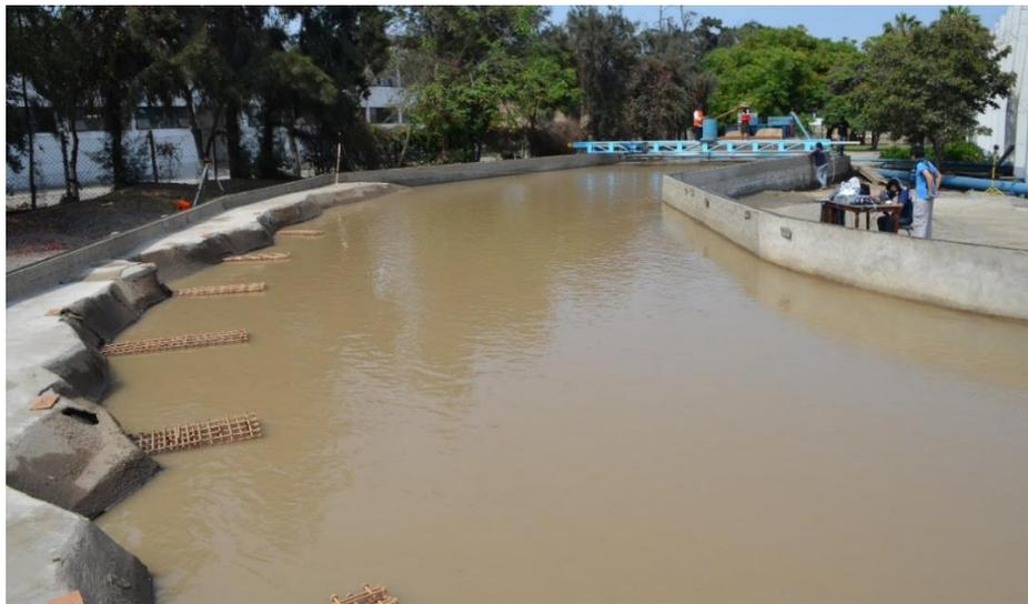
Nivel máximo del agua en este ensayo con espigones ELJ.
