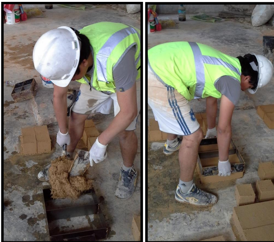
Figura N°57: Moldaje y des moldaje de testigos de adobe a flexión.
