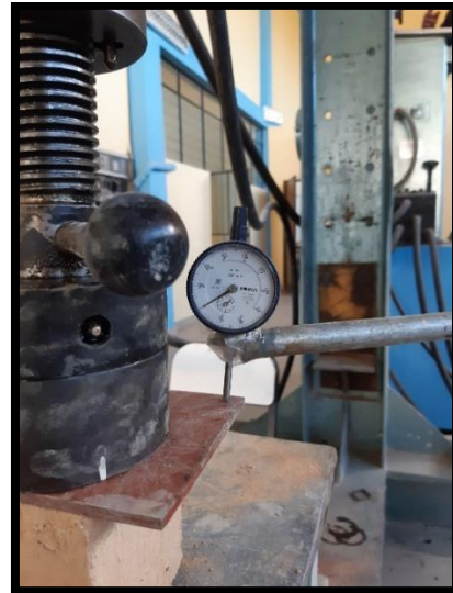
Fotografía N°21: Deformímetro durante el proceso del ensayo.
