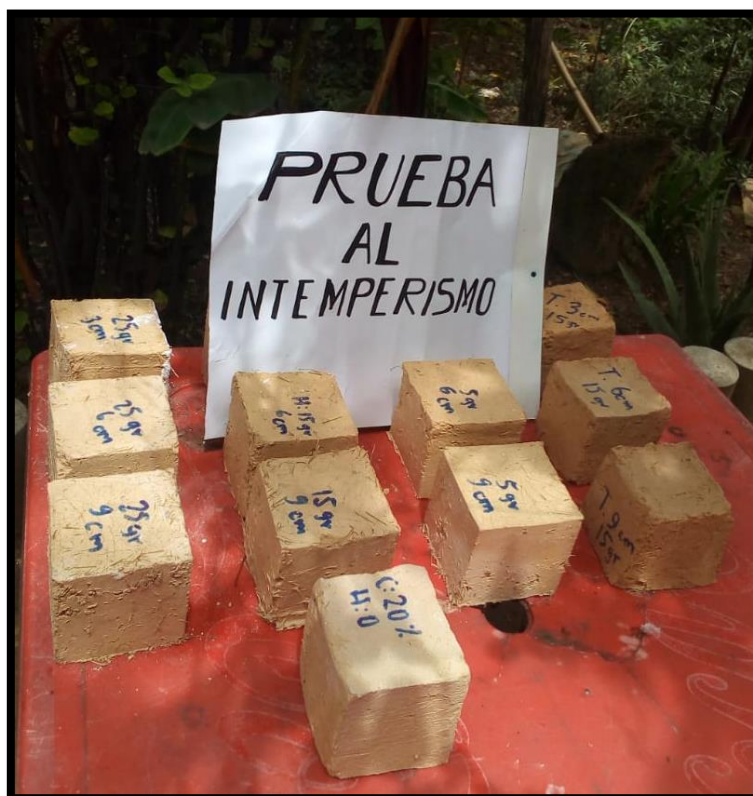
Figura N°59: Adobes para prueba de interperismo.
