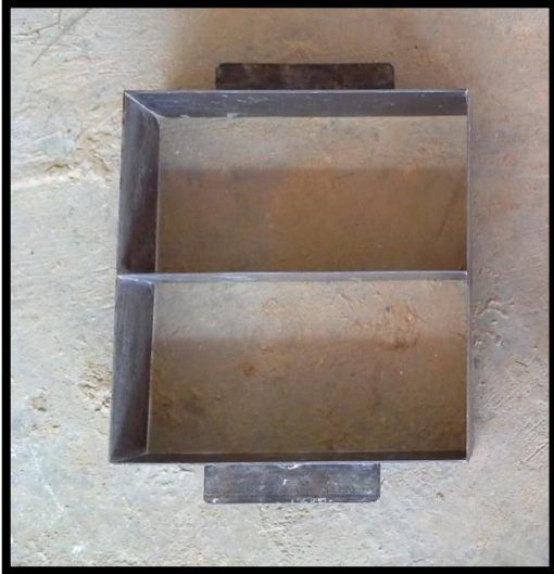
Figura N°21: Molde metálico de 30 cm x 15 cm x 8 cm
