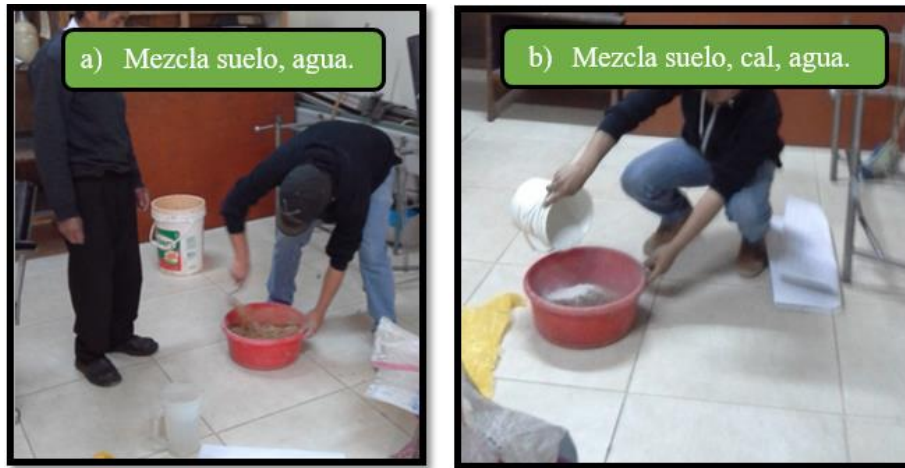
Figura N°25: Mezcla y batido del suelo según el tratamiento requerido: a) Mezcla de suelo con agua; b) Mezcla de suelo con cal y agua
