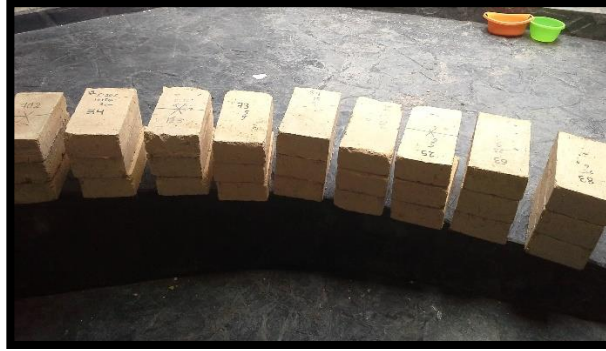
Fotografía 23: Adobes para ensayo a flexión.
