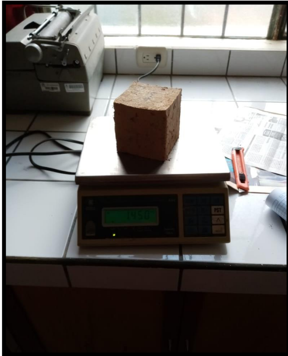
Fotografía 32: Pesaje de probetas para ensayo de absorción.
