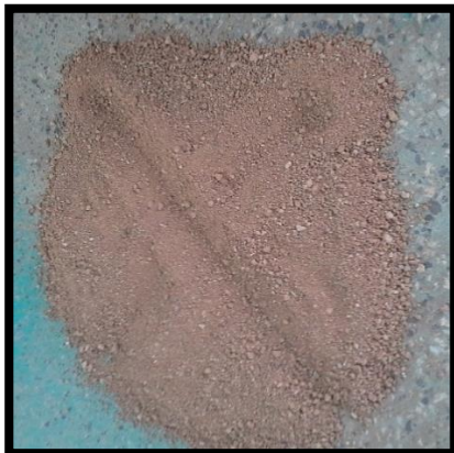
Fotografía N°09: Método del cuarteo
