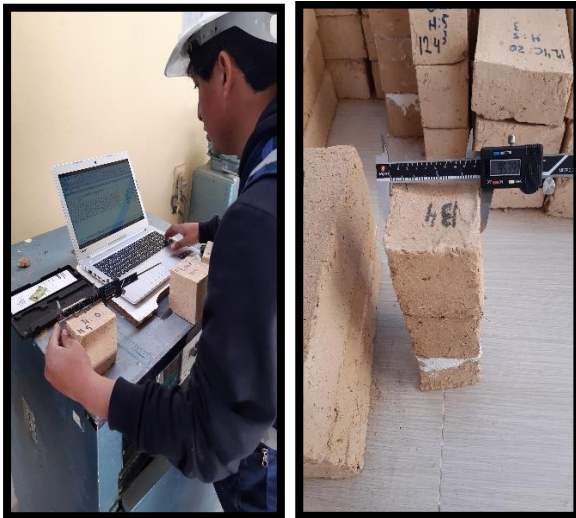
Fotografía N°18: Medida con vernier de adobes para compresión.
