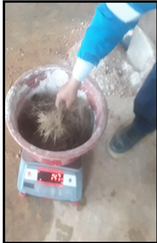
Figura N°51: Pesaje de ichu para adobes estabilizados con cal más ichu.
