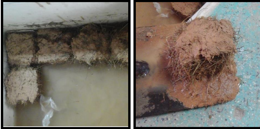
Fotografía 37: Adobes tradicionales luego de la saturación.
