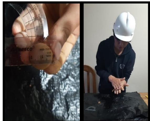
Fotografía N°06: Ensayo de Consistencia
