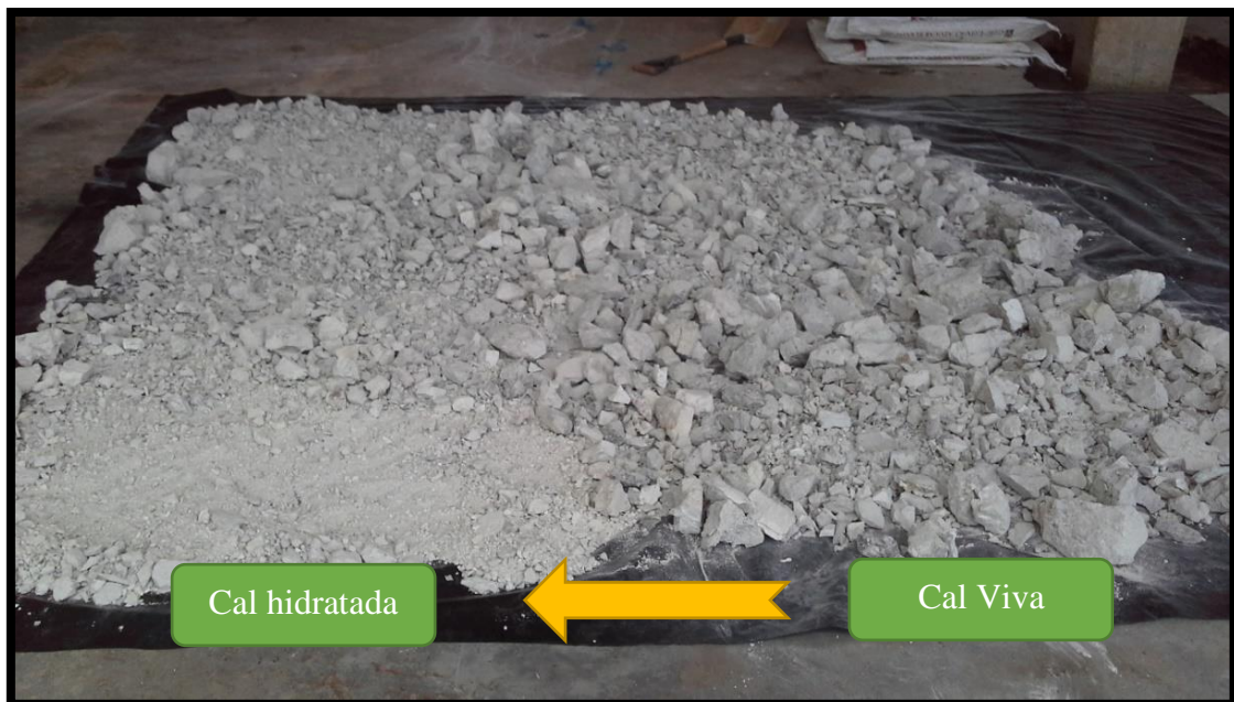
Figura N°35: Transformación de cal viva a cal hidratada
