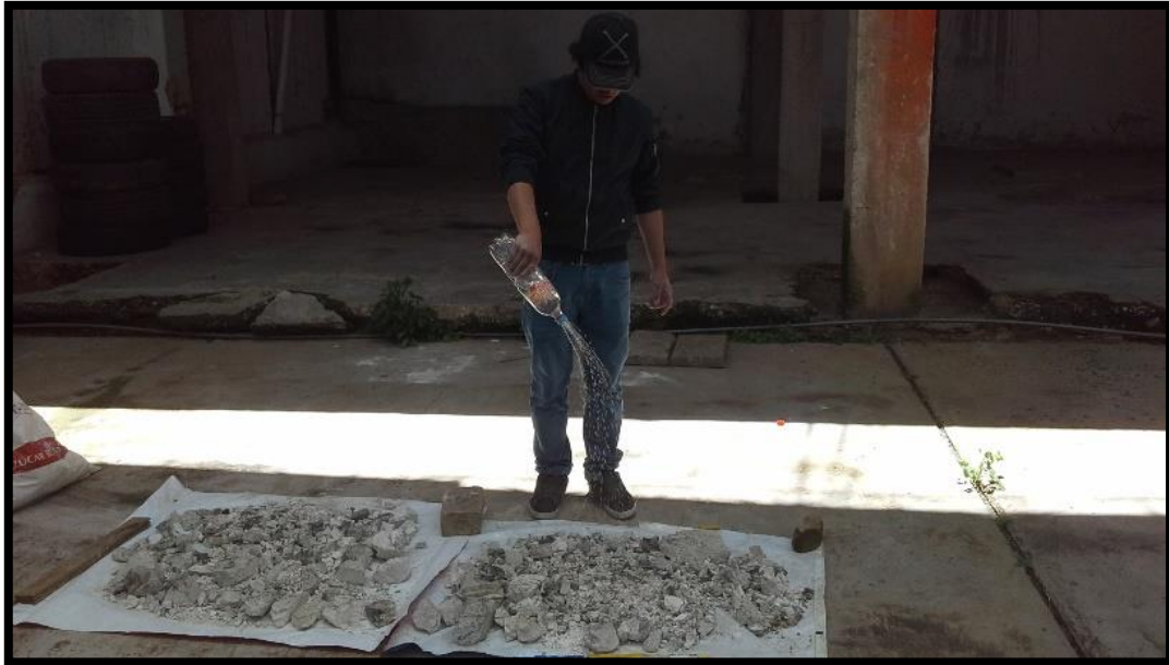
Figura N°34: Agregado de agua a la cal viva
