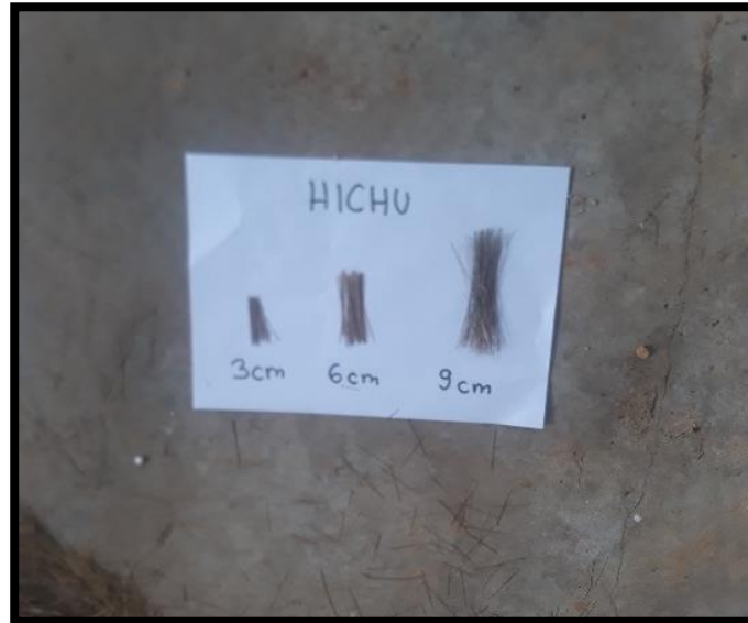
Figura N°36: Corte de ichu en 3, 6 y 9 cm.
