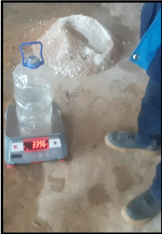
Figura N°50: Pesaje de agua para adobes estabilizados con cal más ichu.
