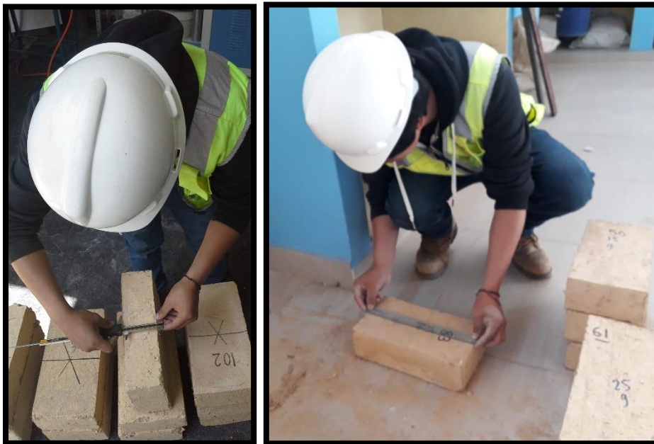
Fotografía 24: Toma de dimensiones de adobes para ensayo a flexión.
