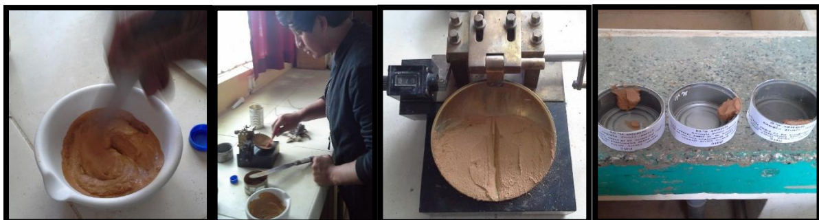
Fotografía N°14: Límites de consistencia – Límite líquido
