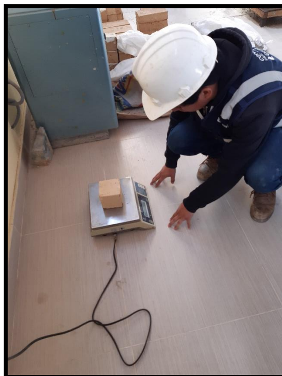
Fotografía N°17: Pesaje de unidades de adobe para compresión.
