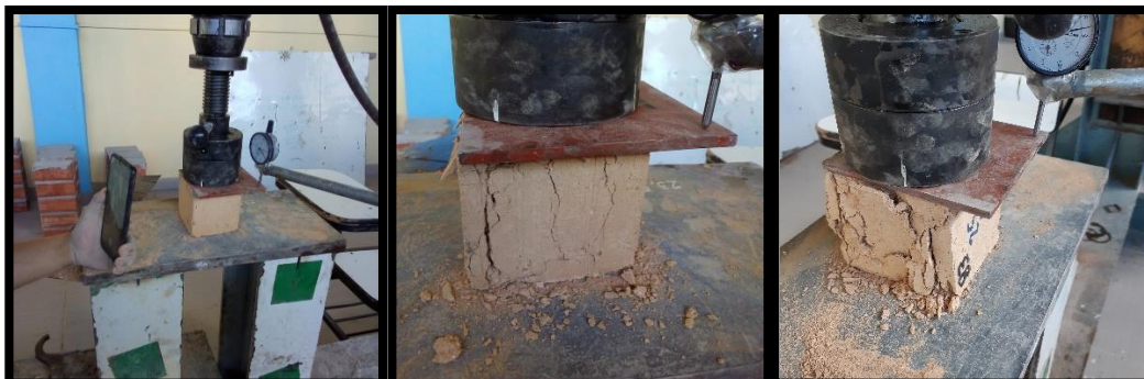
Fotografía 22: Adobe antes, durante y luego del ensayo.
