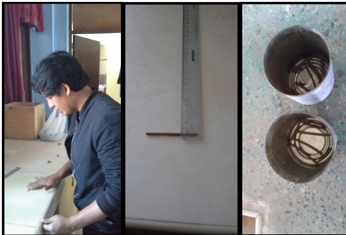
Fotografía N°15: Límites de consistencia – Límite plástico
