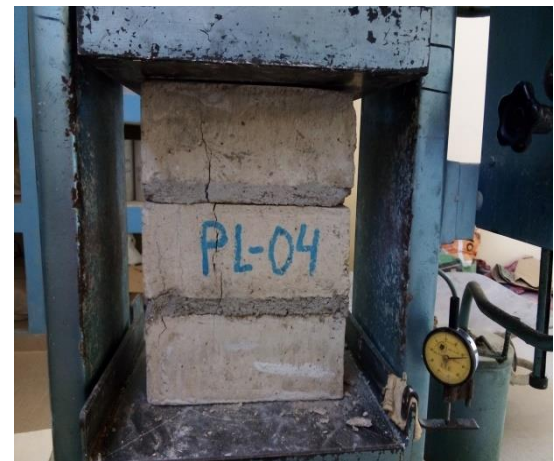
Figura 40. Modo de falla en pila PL-04.
