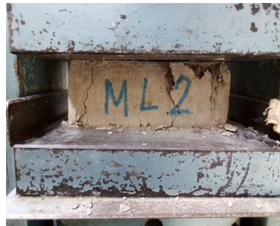
Figura 22. Modo de falla a compresión axial del espécimen ML2.
