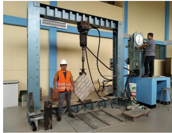
Figura 44. Inicio del ensayo a compresión diagonal para muretes.
