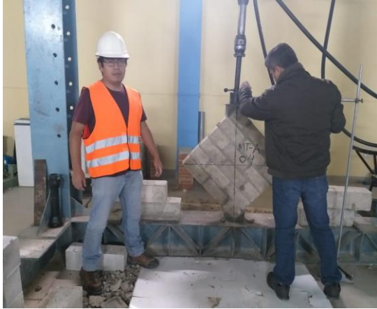
Figura 47. Preparación de murete MT-A4 para ensayo a compresión diagonal.
