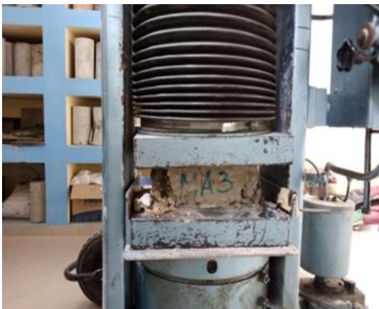
Figura 21. Modo de falla a compresión axial del espécimen MA3.
