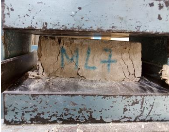
Figura 23. Modo de falla a compresión axial del espécimen ML7.
