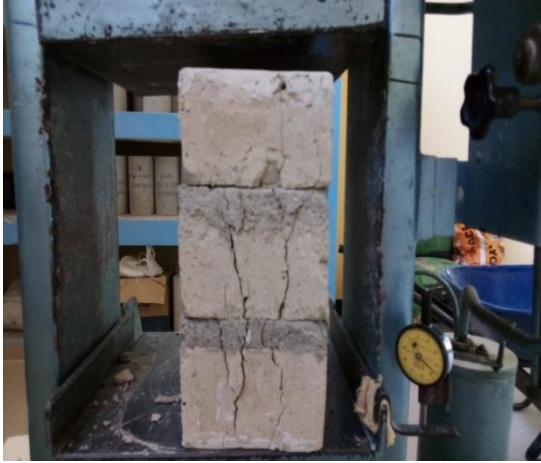
Figura 41. Modo de falla ideal en pila PL-06.
