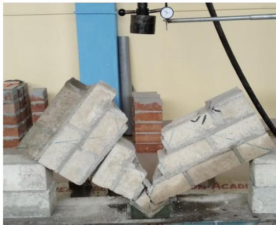
Figura 49. Falla mixta por tracción diagonal y corte escalonado en murete MT-L1.
