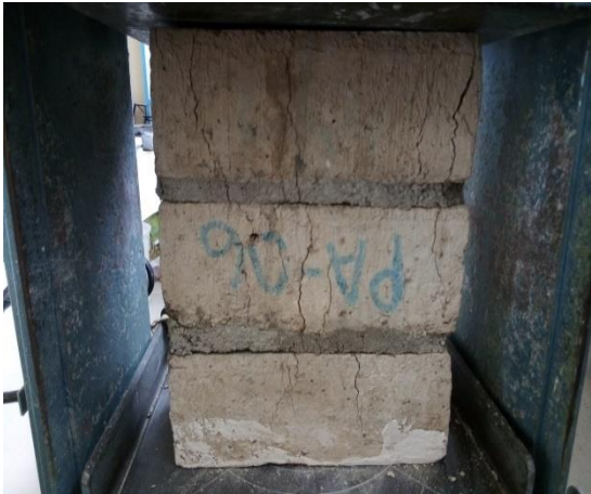
Figura 37. Modo de falla en pila PA-06.
