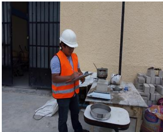
Figura 19. Peso de los especímenes de ambas ladrilleras.
