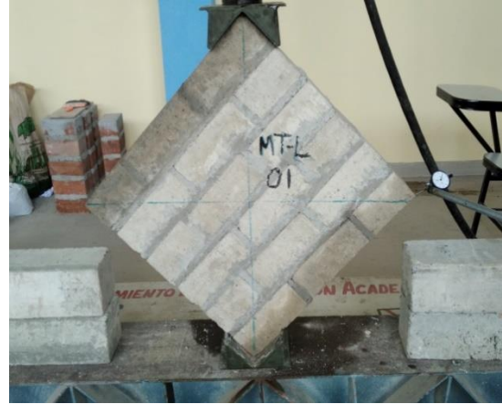
Figura 48. Preparación de murete MT-L1 para ensayo a compresión diagonal.
