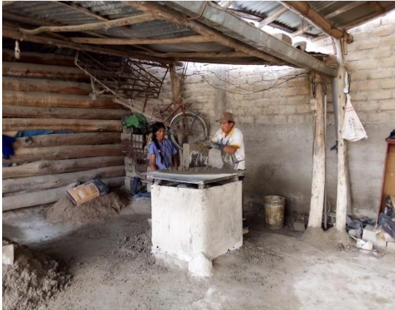
Figura 11. Fabricación de unidades de concreto en la ladrillera Aguilar.
