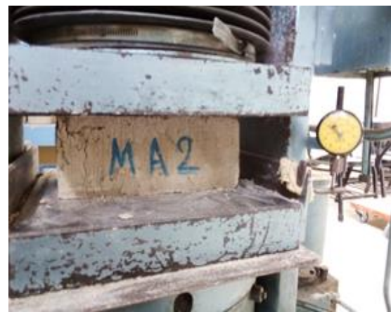
Figura 20. Modo de falla a compresión axial del espécimen MA2.
