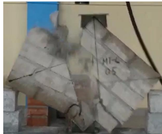
Figura 50. Falla por tracción diagonal y corte en murete MT-L5.
