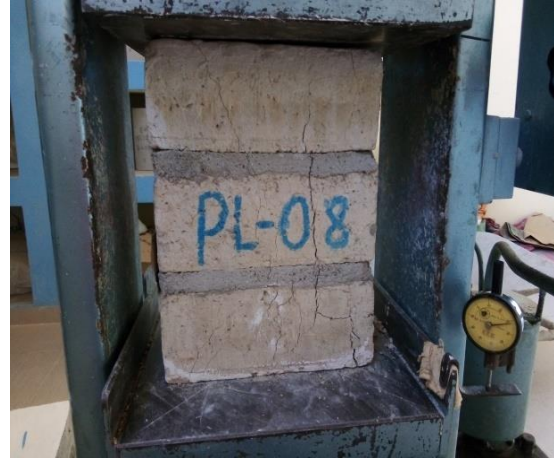
Figura 42. Modo de falla en pila PL-08.
