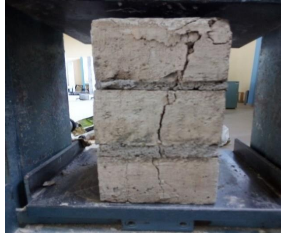
Figura 36. Modo de falla ideal en pila PA-01.
