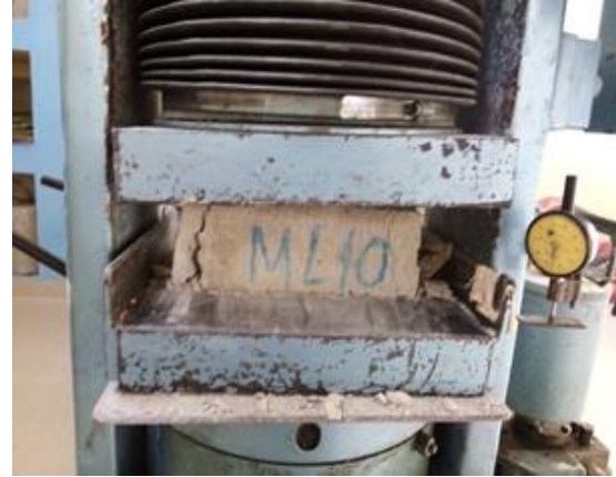
Figura 24. Modo de falla a compresión axial del espécimen ML10.
