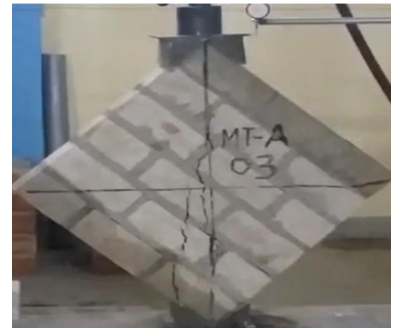
Figura 46. Falla mixta por corte y tracción diagonal en murete MT-A3.
