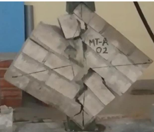
Figura 45. Falla mixta por tracción diagonal y corte escalonado en murete MT-A2.
