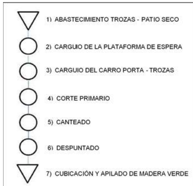
Figura 5. Flujo de producción de un aserradero estacionario
