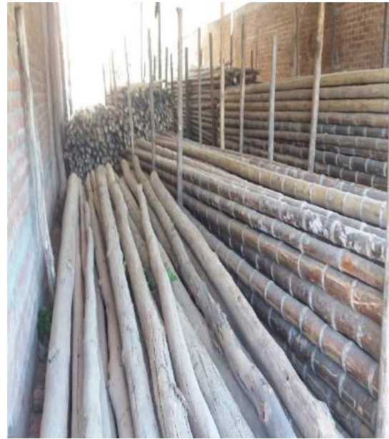
Foto 8. Caña de Guayaquil y postes para instalación eléctrica
