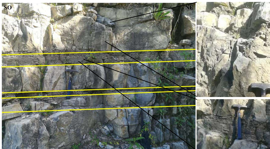
Foto 9. Intercalación de calizas gris-parduzcas y arcillitas calcáreas formando una estratificación paralela. Coordenadas E: 793549, N: 9216240.
