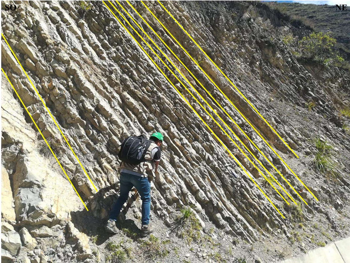
Foto 16. Intercalaciones de calizas gris-parduzcas y margas de la Fm. Pariatambo del miembro superior, formando una secuencia rítmica, estratos de calizas de 32 cm. aproximadamente.
