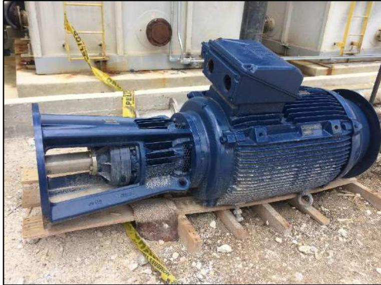
Figura 37. Bomba turbina vertical HMSS. Visitada el 23/05/2018
