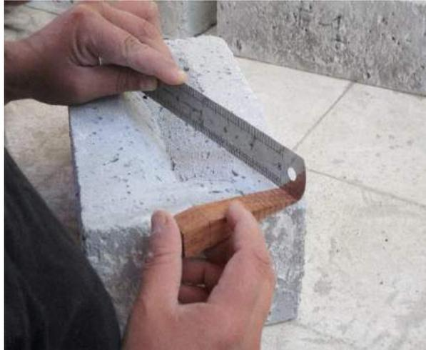
**Figura 22:** Variación dimensional de ladrillos de concreto
