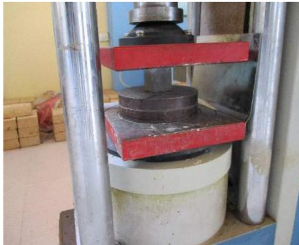
**Figura 26:** Ensayo a compresión de ladrillos
