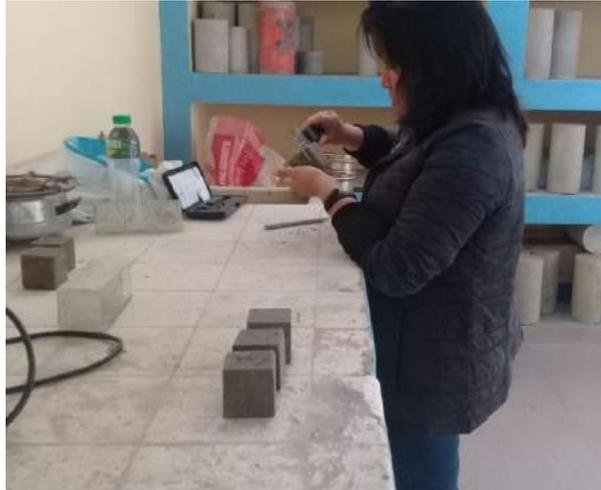
**Figura 25:** Ensayo a compresión de probetas de mortero
