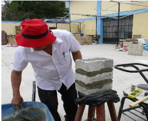
**Figura 28:** Curado de pilas
