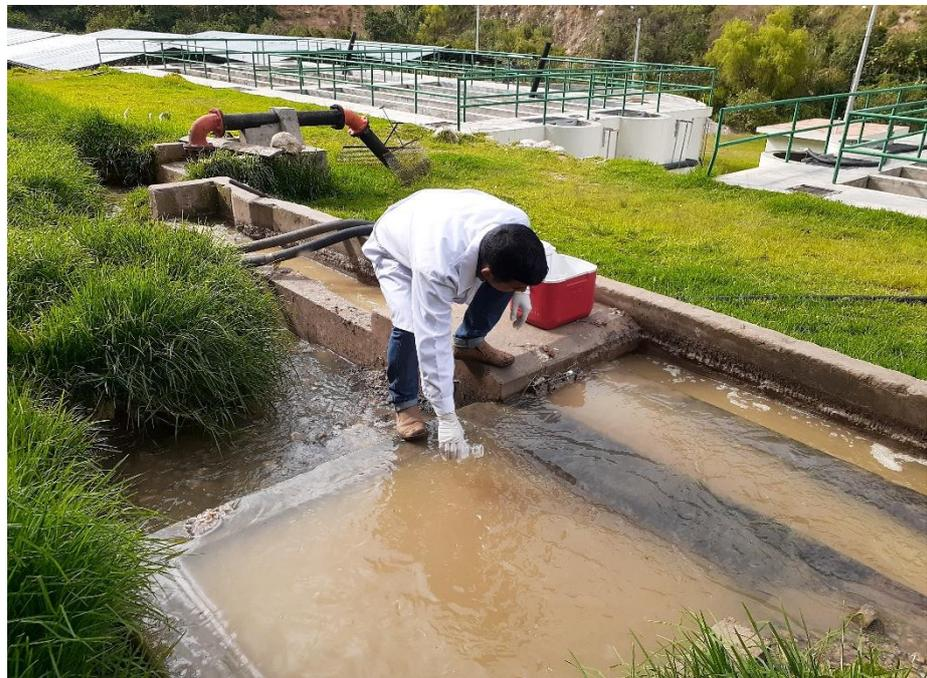
**Figura 16.** Toma de muestras en el afluente (PT-01) de la PTAR Cajabamba
