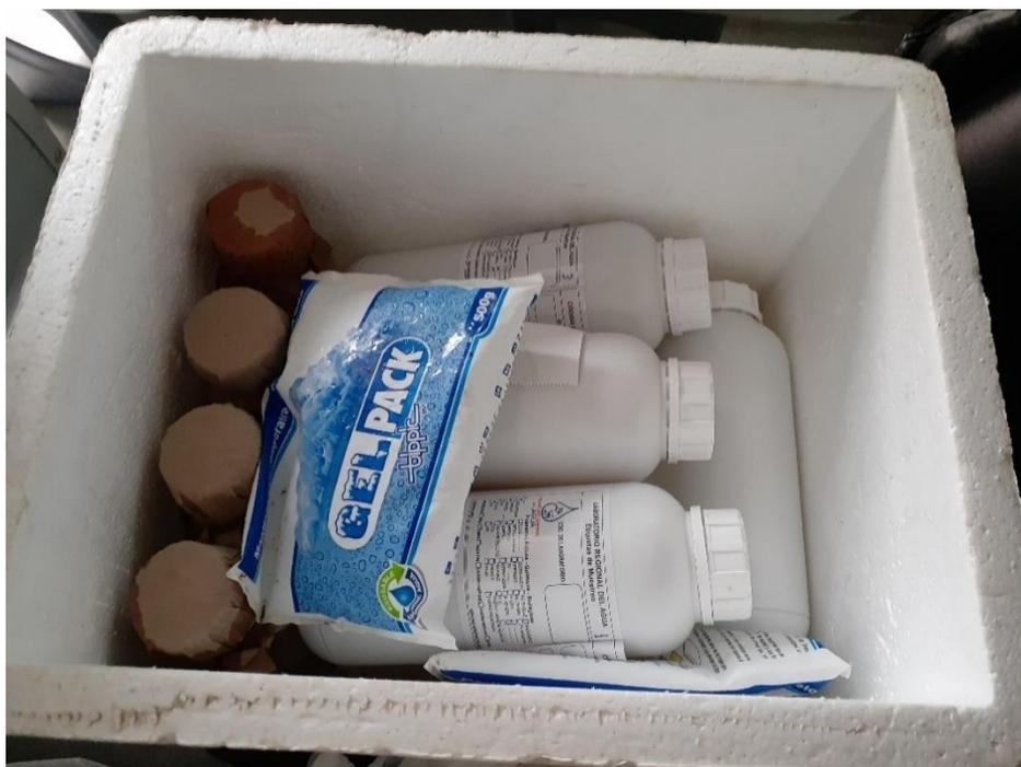
**Figura 21.** Refrigeración in-situ de las muestras tomadas en la PTAR
