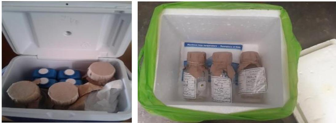
**Figura 23.** Muestras recolectadas de coliformes termotolerantes recolectadas para envió al laboratorio
