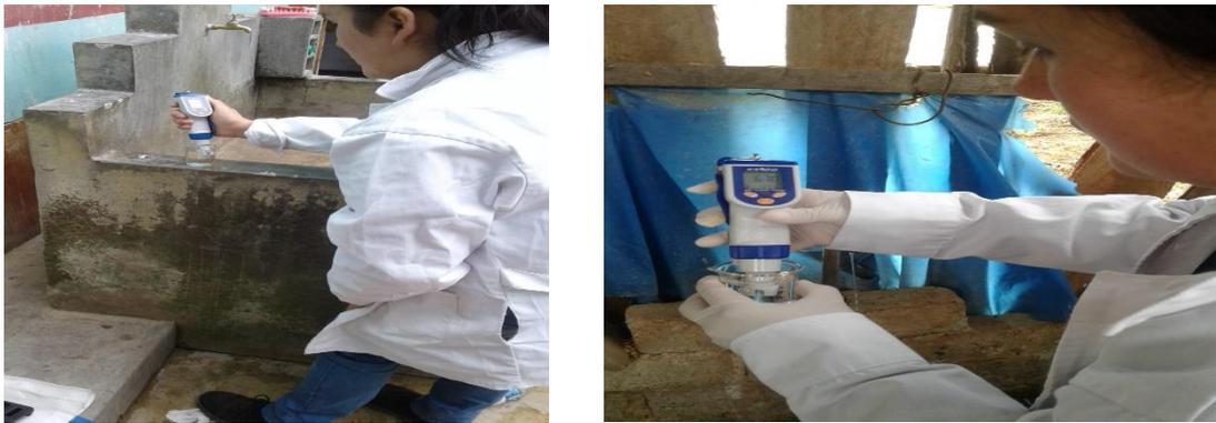
**Figura 22.** Medición de los parámetros de pH y temperatura con el equipo pHmetro con función de medición de temperatura.
