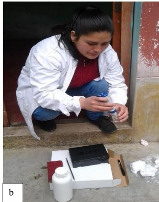
**Figura 20.** a) grifo abierto para la eliminación de impurezas. b) Limpieza del electrodo del pHmetro
