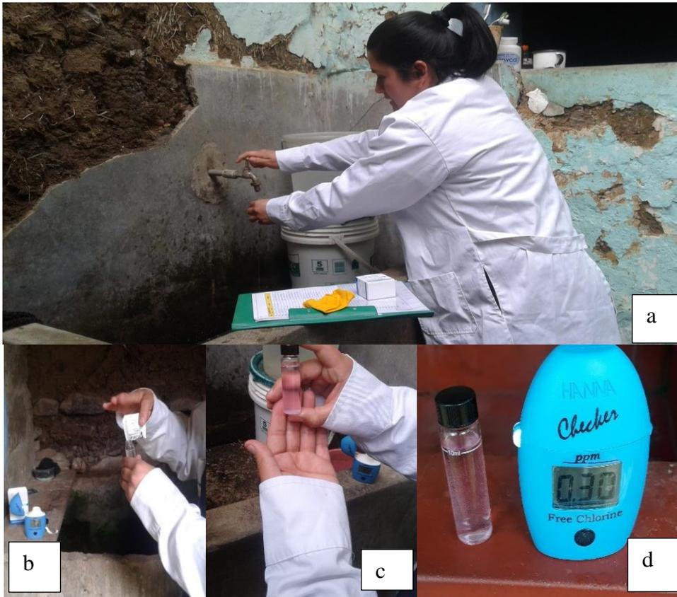
**Figura 16.** Procedimiento para la medición de cloro residual. a) Llenado de agua potable la cubeta. b) Se añade el reactivo DPD. c) se agita la cubeta. d) Se coloca la cubeta en la celda del equipo fotómetro y medición de la muestra.
