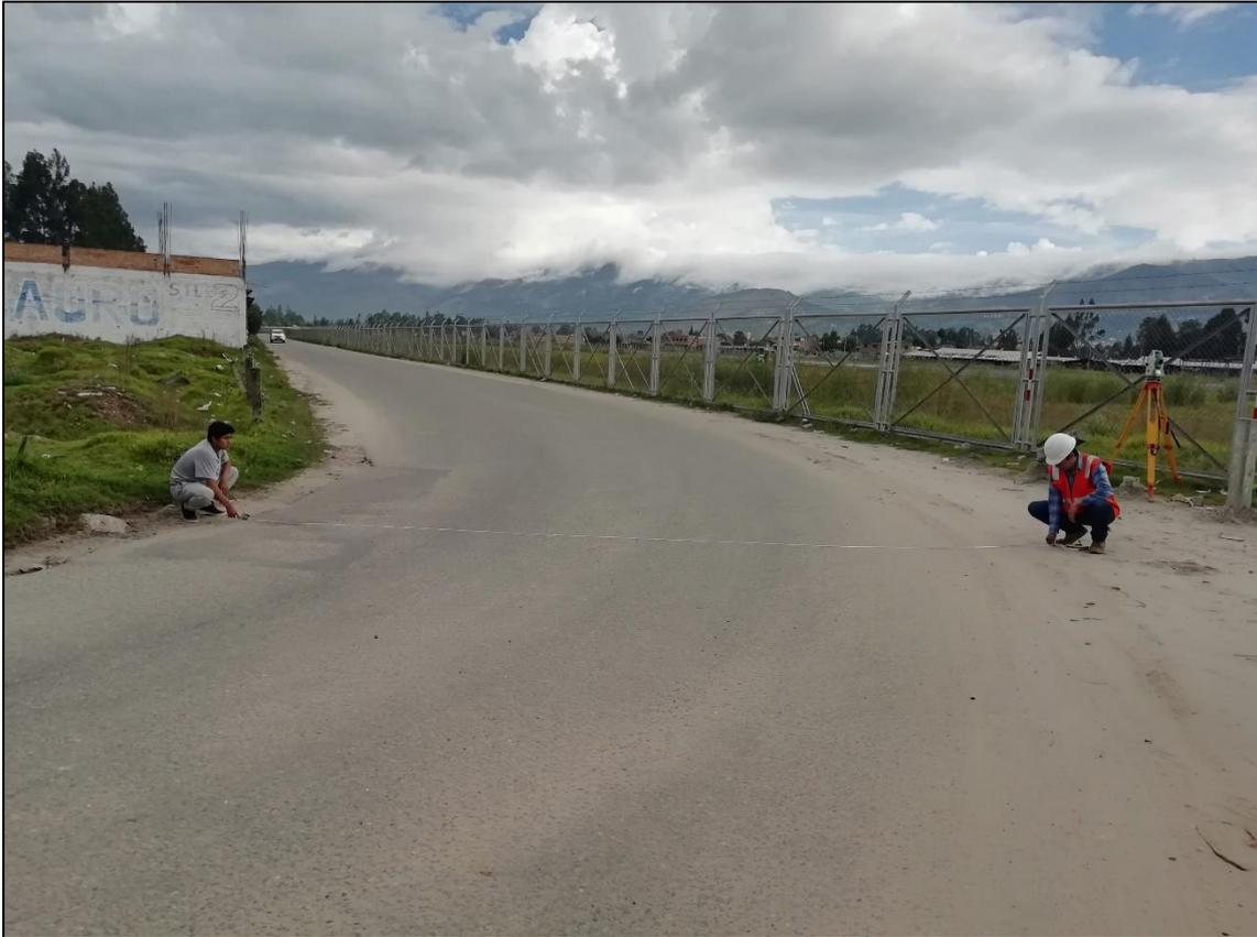
**FOTOGRAFÍA N°05:** Medición de ancho de calzada en curvas C-11.
