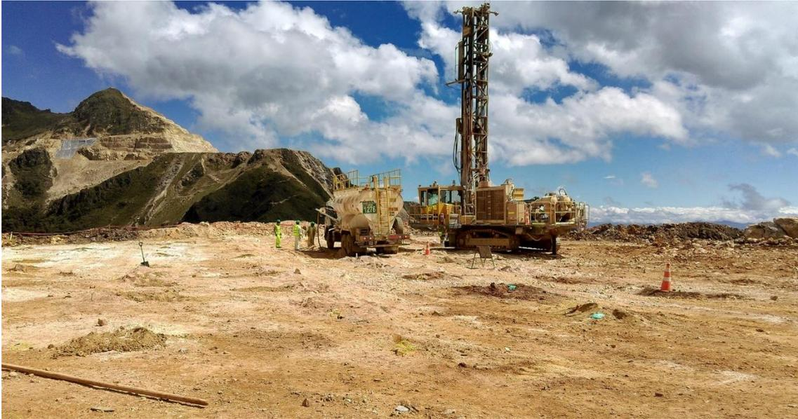
Figura N°13: Perforadora DM45 y Camión Fábrica, perforando y cargando taladros, en el nivel 3504 del tajo San Pedro.
