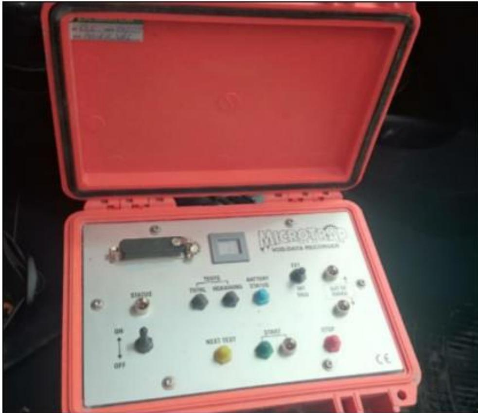
Figura N°40: Equipo Microtrap, para medición de VOD
