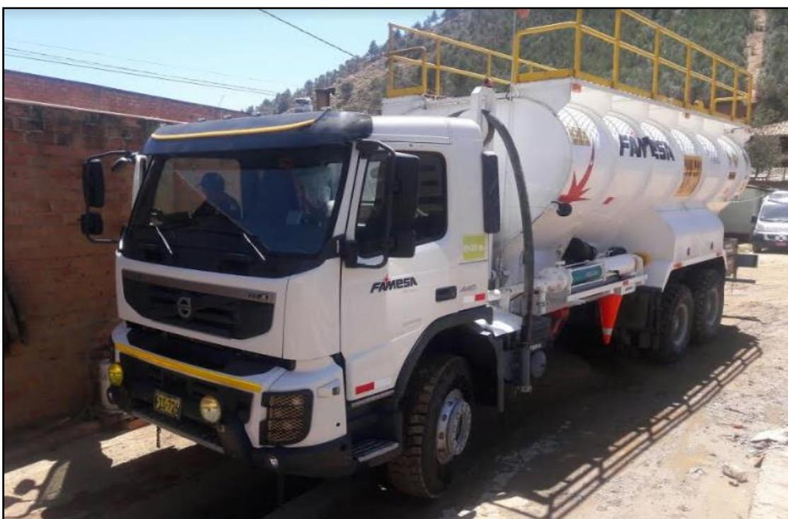
Figura N° 14: Camión fábrica F1S-726 de 24 toneladas.
