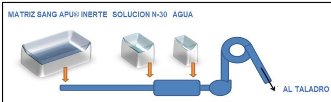
Figura N° 8: Proceso de fabricación en camión fábrica (Famesa, 2019)
