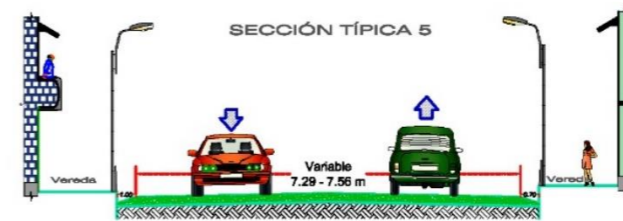
SECCION TÍPICA - Av. Independencia (Km 2+170 - 2+356)
