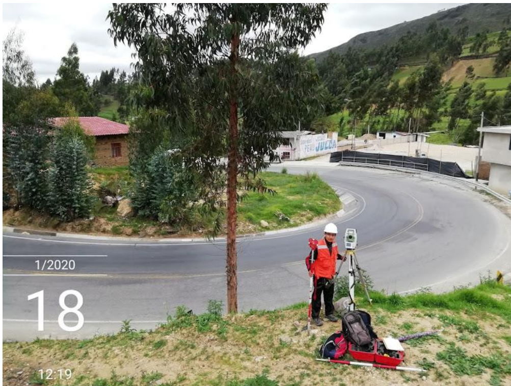
Fotografía N° 14: Estación en una curva de vuelta
