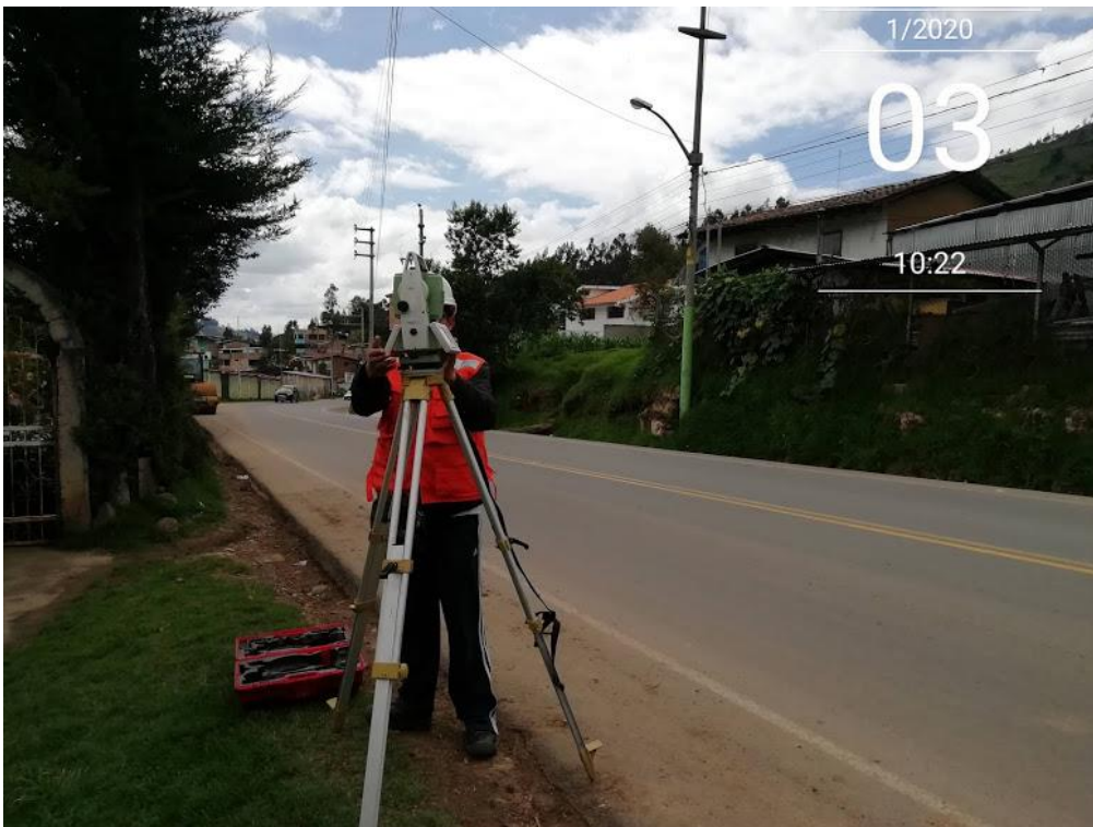
Fotografía N° 8: Nivelación de estación total Leica TS- 09 Plus
