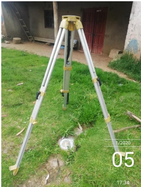
Fotografía N° 4: Trípode usado durante el levantamiento
