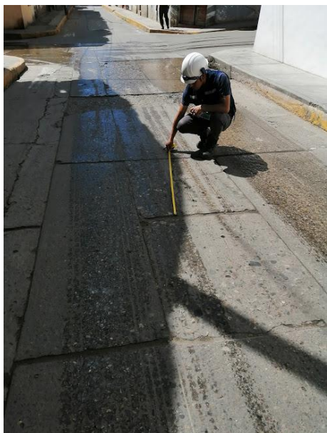
Foto N° 39: toma de datos de grietas lineales de severidad media (M)
