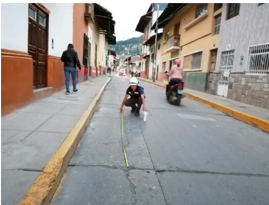
Foto N° 43: Se están tomando datos de grietas lineales de severidad media (M)
