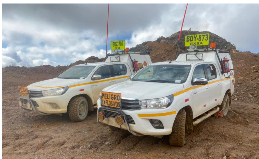
Figura 27. Camionetas furgon de transporte de accesorios de voladura.
