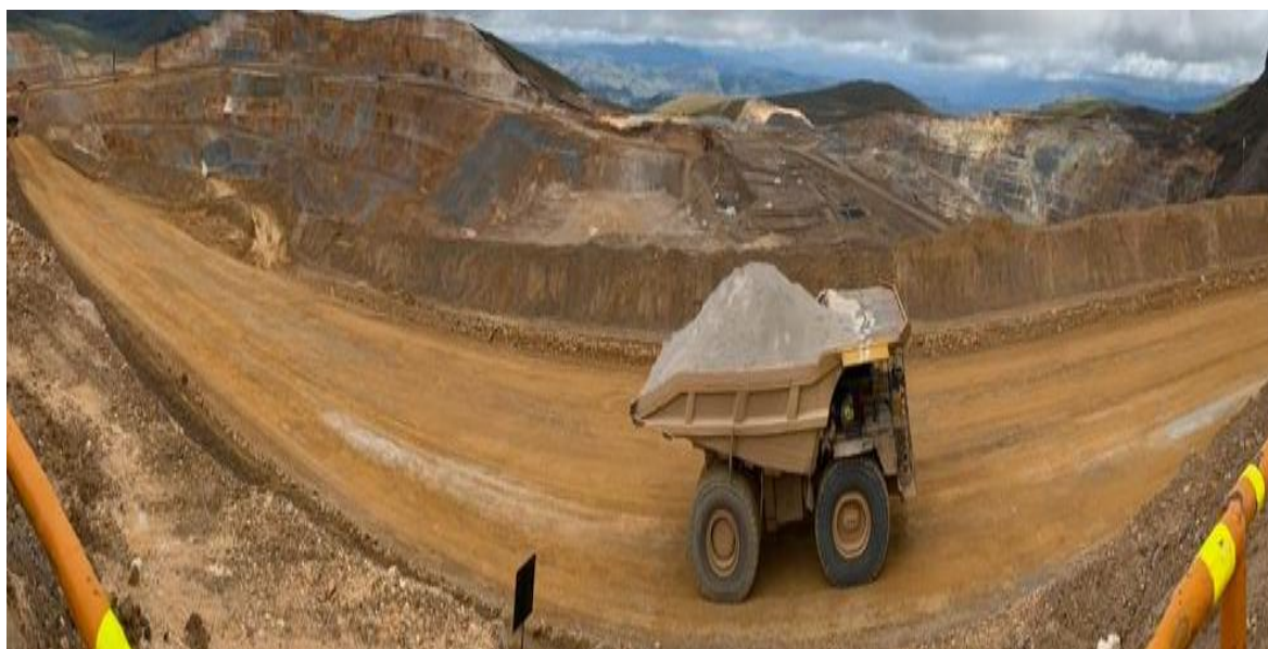
Figura 32. Camión gigante Cat 793 en la vía de acarreo del tajo Quecher main
