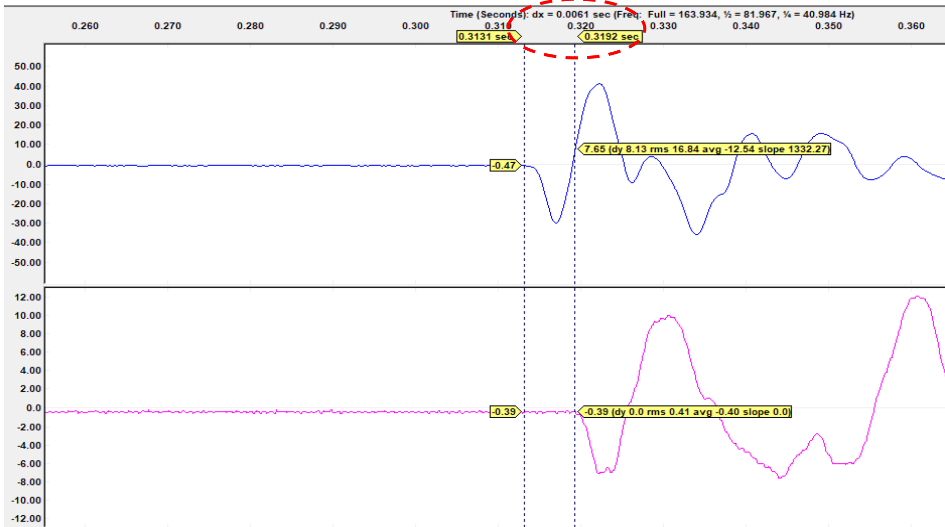
Figura 51. Registro de llegada de ondas del taladro N° 1 a los geófonos (G1-G2)
