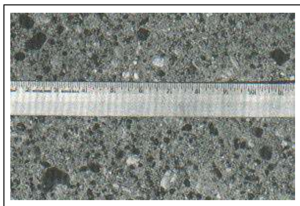
Figura N° 19: Pulimento de agregados.
