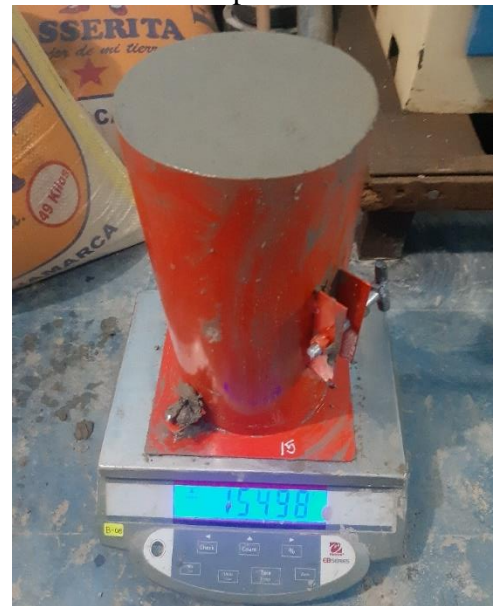
Fotografía N°16: obtención de pesos de probetas en estado fresco.
