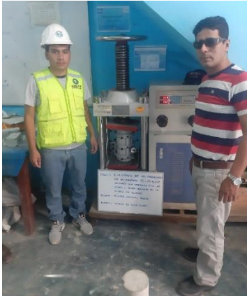
Fotografía N°38: Ensayo de Módulo de Elasticidad y relación de Poisson.
