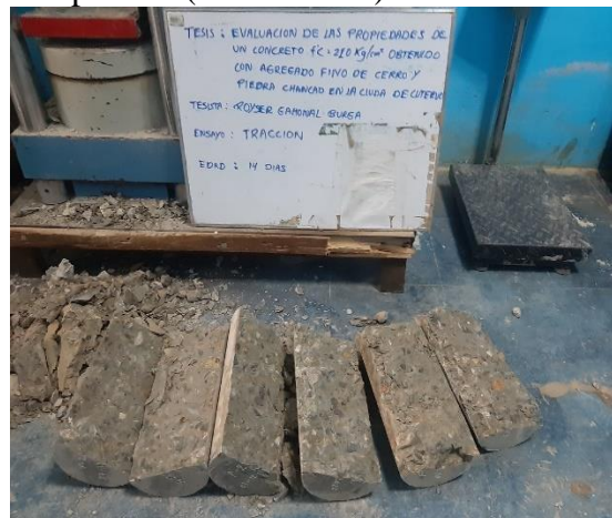
Fotografía N°27: Fallas de probetas resistencia a la tracción, edad 14 días.
