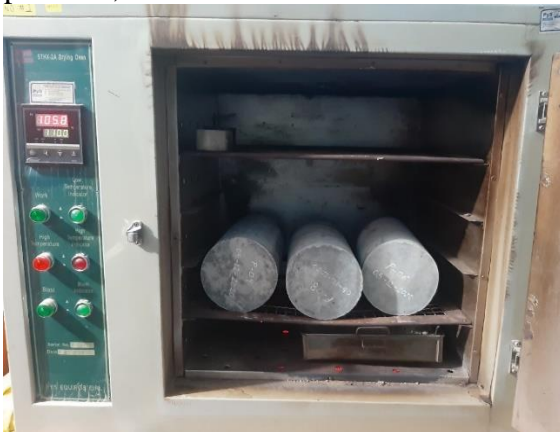
Fotografía N°32: Secado al horno de probetas para determinar su porcentaje de vacíos.
