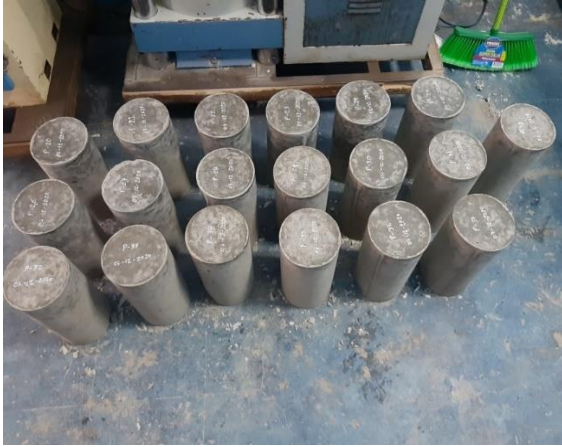
Fotografía N°19: Identificación de probetas.
