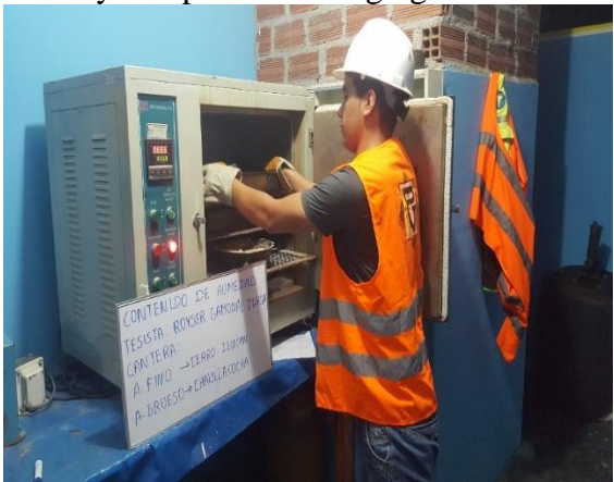
Fotografía N°09: Ensayo del contenido de humedad de los agregados.
