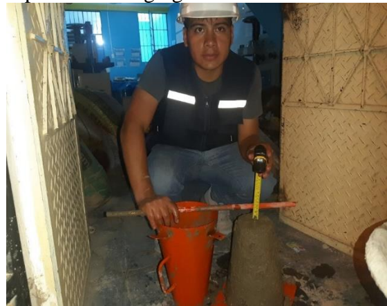
Fotografía N°10: Medición slump de mezcla de prueba.
