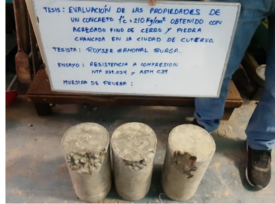
Fotografía N°14: Fallas obtenidas en muestras de prueba luego de ensayo de resistencia a la compresión.
