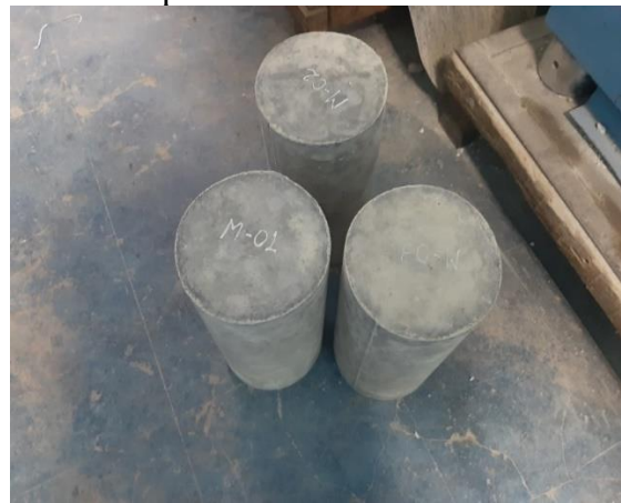
Fotografía N°12: Preparación de muestras de prueba (M-01, M-02, M-03) para ensayo de rotura.
