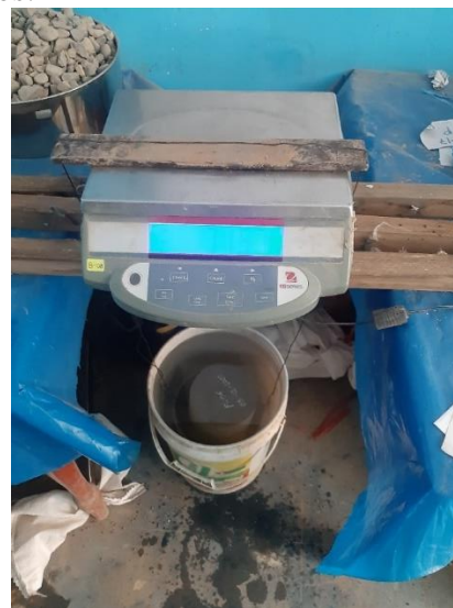
Fotografía N°35: Peso sumergido de probetas.
