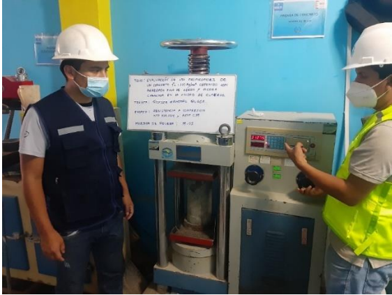
Fotografía N°13: Ensayo de resistencia a la compresión de probetas de prueba (M-01, M-02, M-03).
