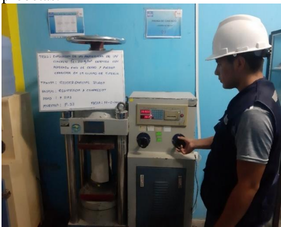
Fotografía N°21: Ensayo de resistencia a la compresión (7 días)
