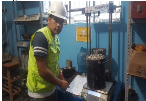
Fotografía N°06: Ensayo de peso unitario suelto y compactado del agregado grueso.
