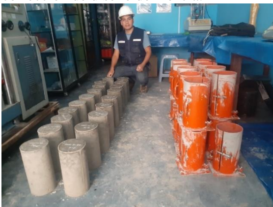
Fotografía N°17: Desmolde e identificación de probetas (P-01, P-02, ....., P-19)
