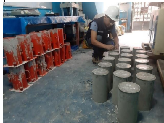
Fotografía N°18: Desmolde e identificación de probetas (P-20, P-21, ....., P-38)
