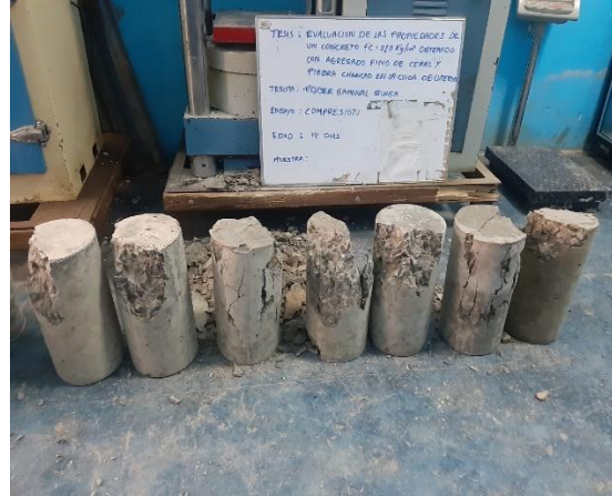
Fotografía N°25: Fallas de ensayo a la compresión (edad 14 días)
