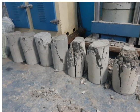
Fotografía N°22: Fallas de ensayo a la compresión (edad 7 días)
