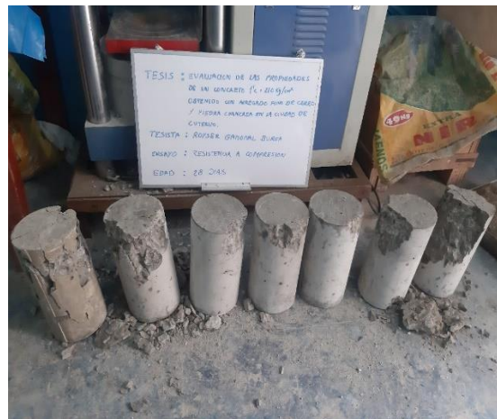
Fotografía N°29: Fallas de ensayo a la compresión (edad 28 días)
