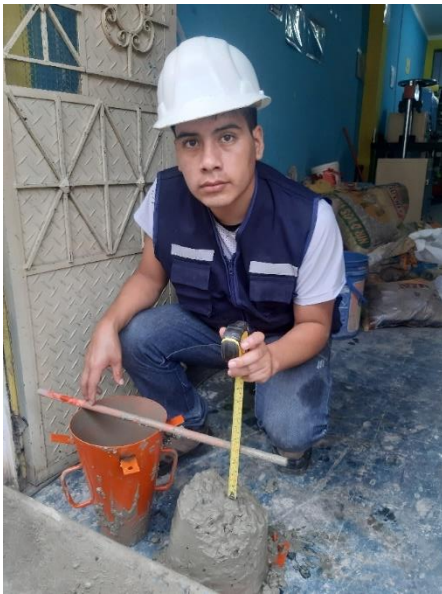
Fotografía N°15: Ensayo Slump luego de corrección de diseño de mezcla.
