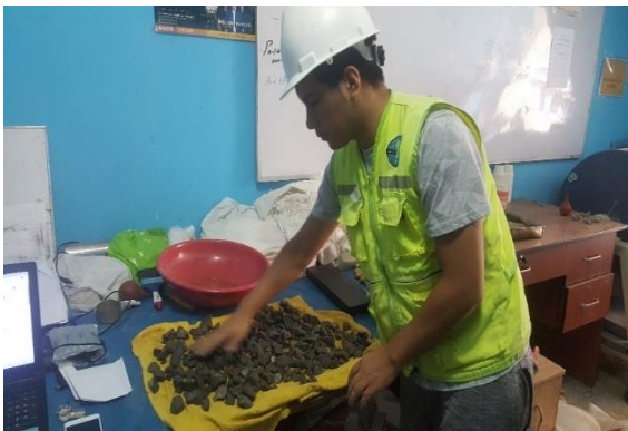
Fotografía N°05: Secado de muestra para peso SSS y Pe del agregado grueso.
