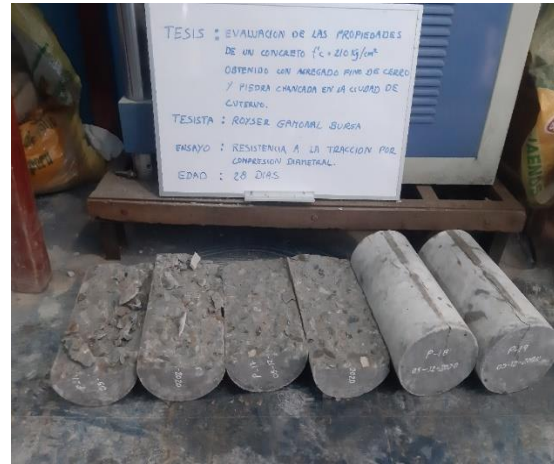
Fotografía N°31: Fallas de probetas resistencia a la tracción, edad 28 días.
