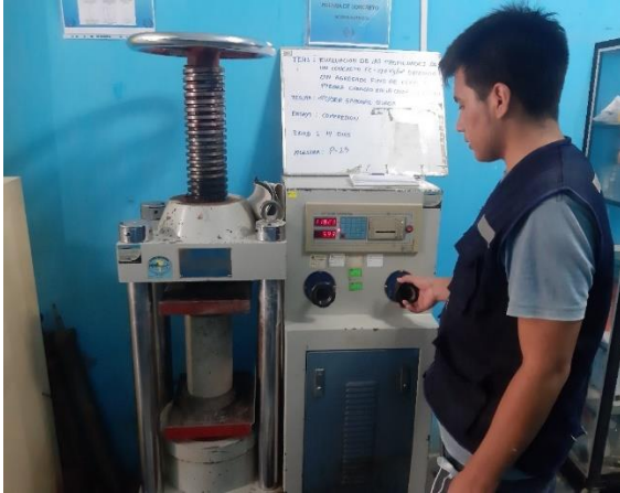
Fotografía N°25: Ensayo de compresión de probetas, edad 14 días.
