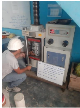
Fotografía N°37: Colocación de equipo y probeta para ensayo de Módulo de Elasticidad.
