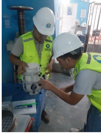
Fotografía N°36: Preparación de equipo para ensayo de Módulo de Elasticidad y relación de Poisson.
