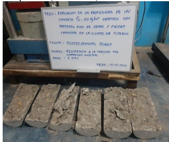
Fotografía N°24: Fallas de probetas resistencia a la tracción, edad 7 días.
