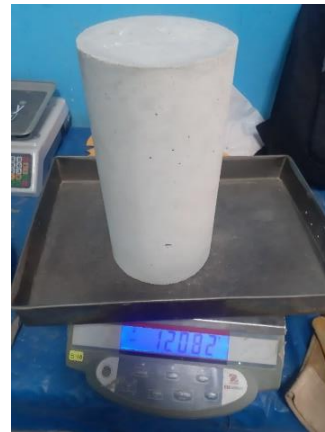
Fotografía N°33: Peso seco al horno de probetas para determinar su porcentaje de vacíos.
