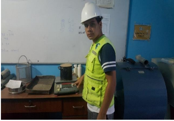
Fotografía N°07: Ensayo de peso unitario suelto y compactado del agregado fino.
