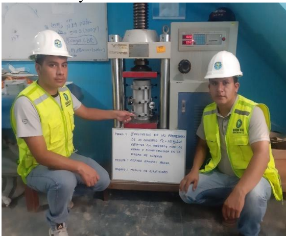
Fotografía N°38: Ensayo de Módulo de Elasticidad y relación de Poisson.
