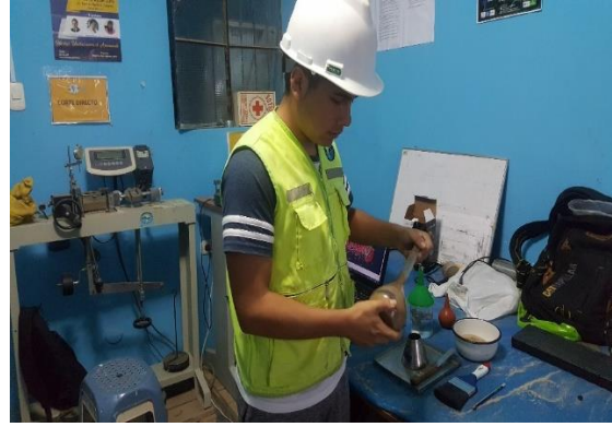
Fotografía N°08: Ensayo de peso específico del agregado fino.
