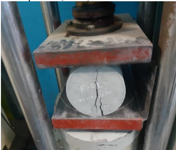
Fotografía N°23: Ensayo de resistencia a la tracción por compresión diametral (brasileño) probetas 7 días
