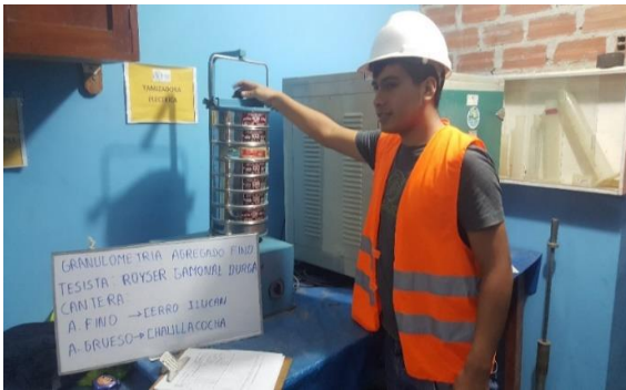
Fotografía N°03: Ensayo análisis granulométrico del agregado fino y grueso.
