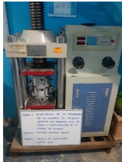
Fotografía N°41: Culminación de ensayo Módulo de Elasticidad hasta el 40% de la carga última.
