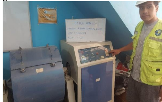
Fotografía N°04: Ensayo de abrasión del agregado grueso en la Máquina los Angeles.
