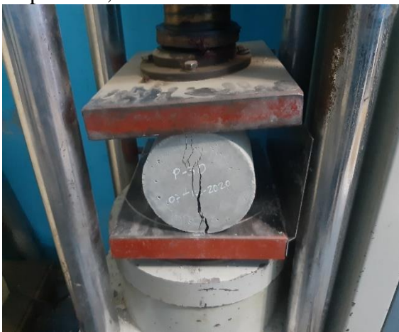
Fotografía N°26: Ensayo resistencia a la tracción por compresión diametral de probetas, edad 14 días.
