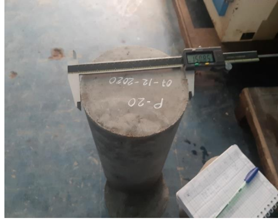
Fotografía N°20: Medición de probetas.
