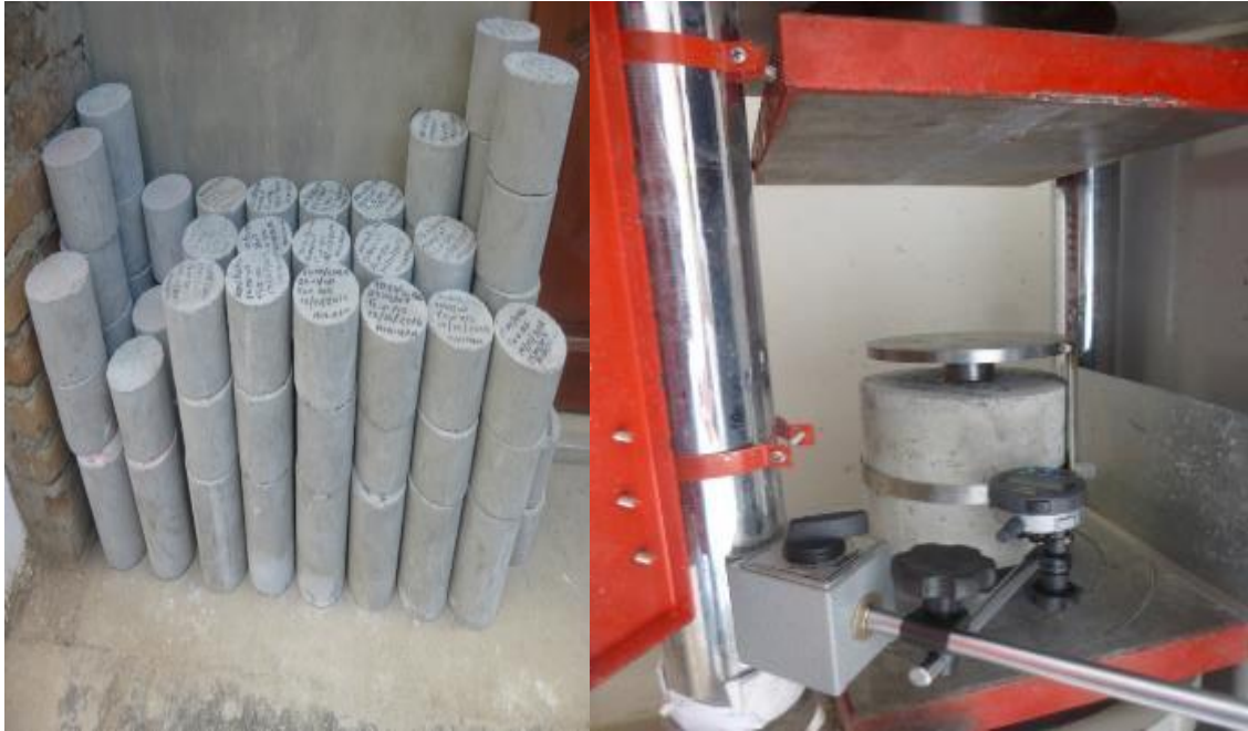
Figura 70–Probetas de CRFA de 30x15 y 15x15 cm, configuración del ensayo Barcelona.
