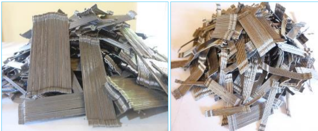
Figura 60– Fibras de acero Dramix 3D65/60BG y 4D55/60BG, encoladas en peines (fuente propia)
