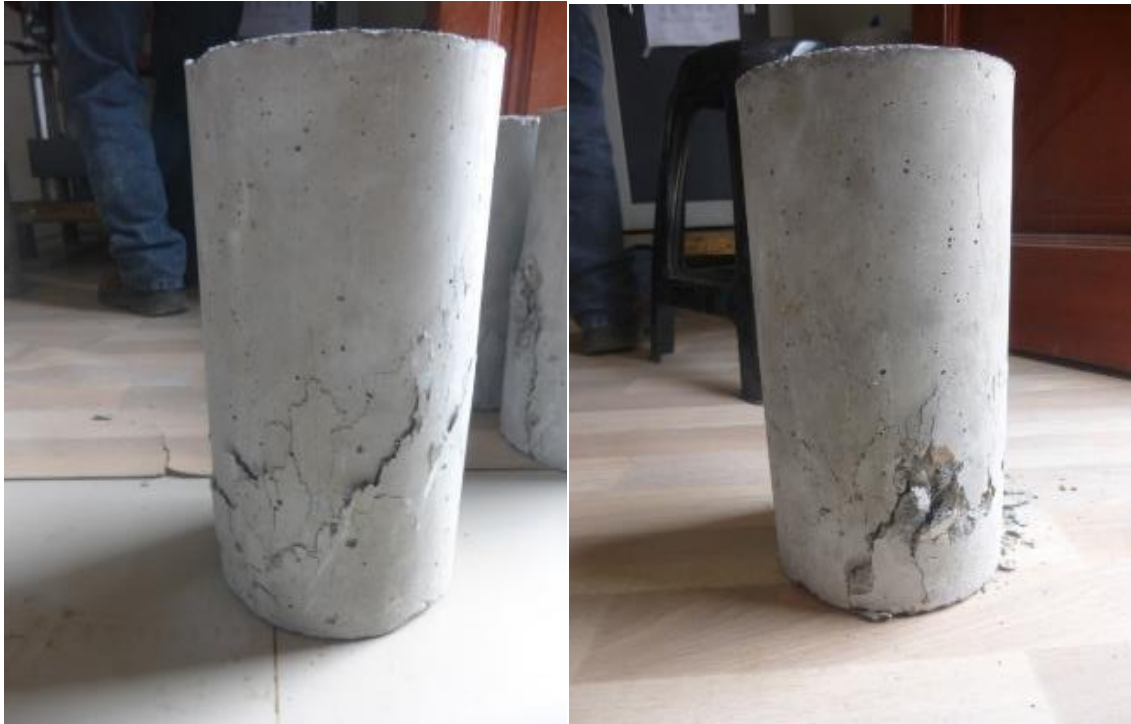
Figura 72–Fractura tipo V en los ensayos a compresión axial del CRFA
