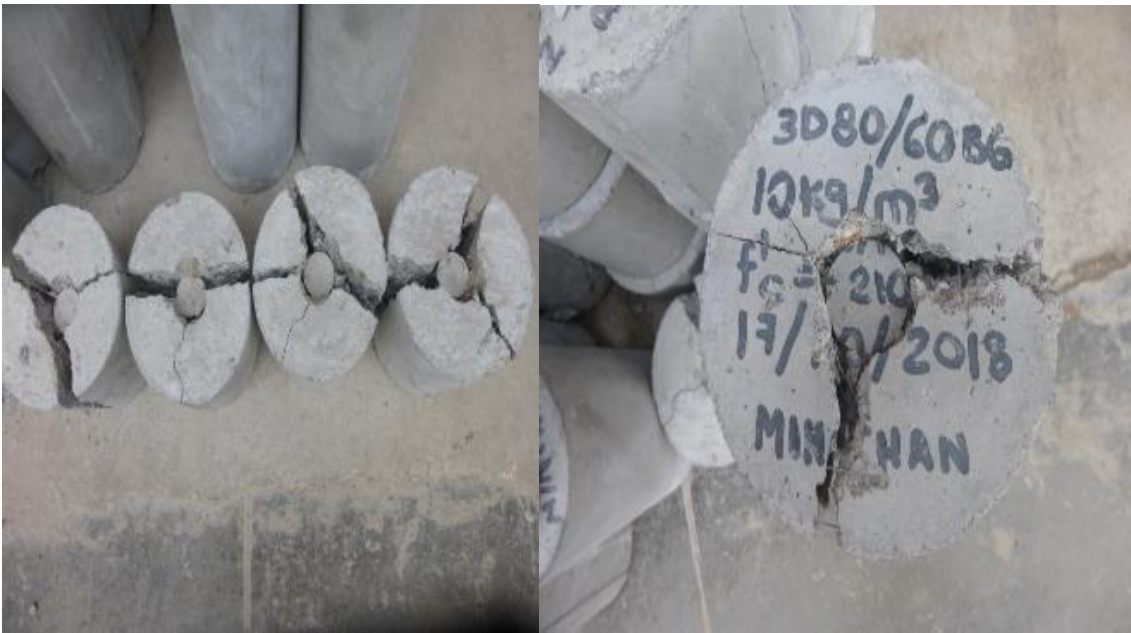
Figura 73–Formación de fallas cónicas y fisuras radiales en el ensayo Barcelona
