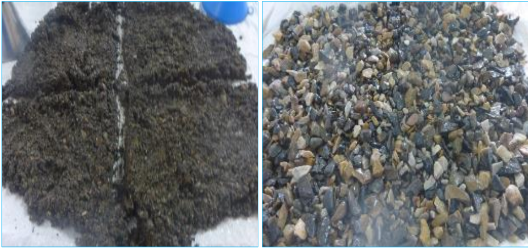
Figura 59–Agregado Fino y Grueso de la cantera rio chonta (fuente propia)
