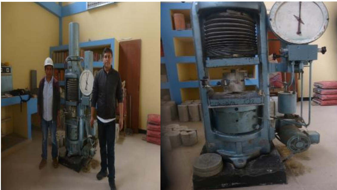
Figura 71–Ensayo Barcelona del concreto reforzado con fibras de acero (CRFA)
