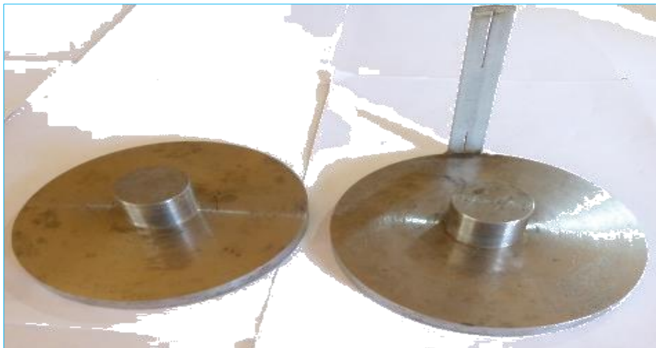
Figura 66–Punzones elaborados de acero (fuente propia)
