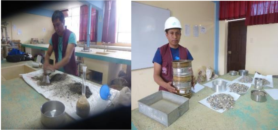
Figura 68–Determinación de las propiedades físico mecánicas del agregado Fino y Grueso.
