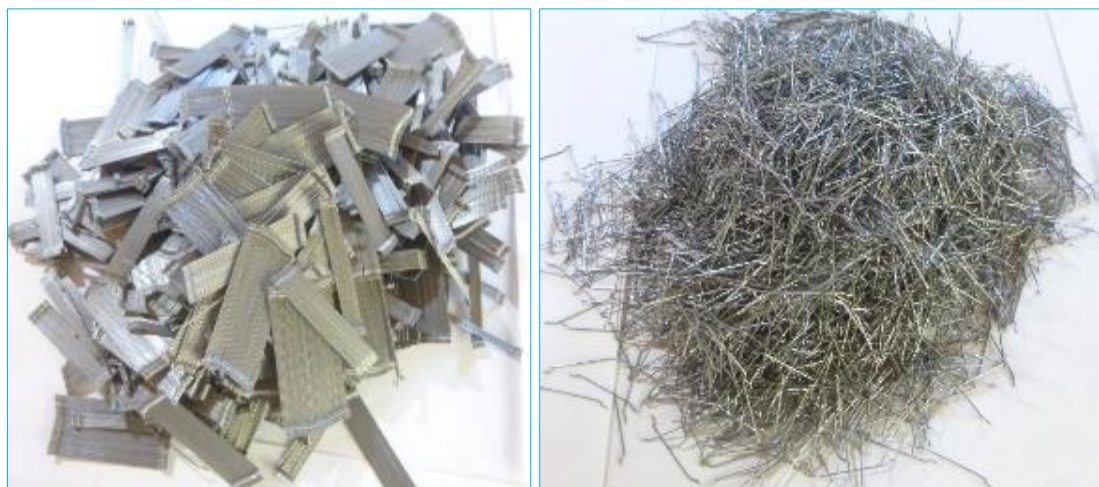
Figura 61–Fibras de acero Dramix 3D45/35BL y 3D80/60BG, sueltas y encoladas en peines
