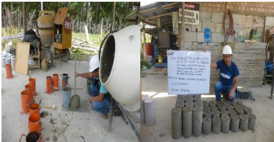
Figura 69–Ensayo de consistencia del CRFA, probetas elaboradas de CRFA de 15x30 y 15x15 cm.
