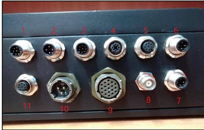
*Fig. 81: Conectores de la descripción del OpGuard*
