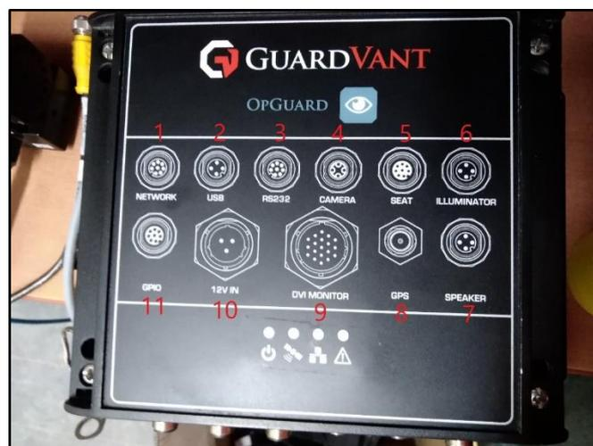
Fig. 80: Montura del OpGuard con la descripción de cada conector
