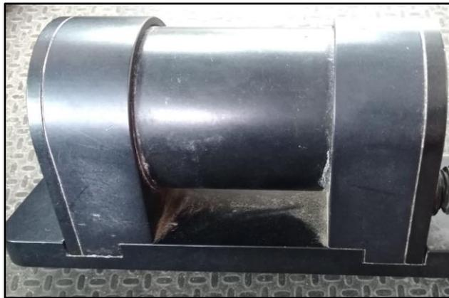
*Fig. 51: Vibrador para asiento*
