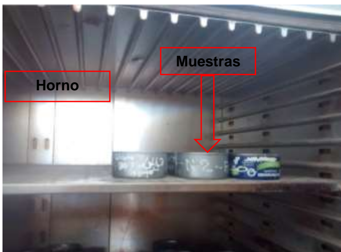
Foto 27: Muestras en el horno por un periodo de 24 horas.
