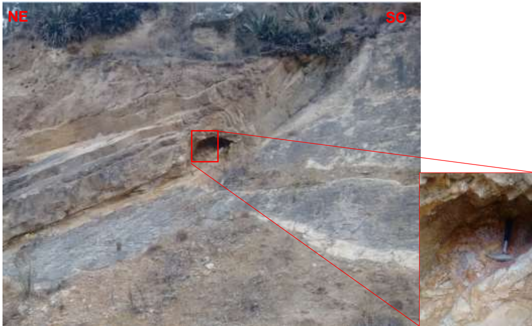
Foto 31: Depósito de arcillita limosa dentro de los estratos de calizas gris clara de la Formación Cajamarca. (Norte: 9257545, Este: 773125).
