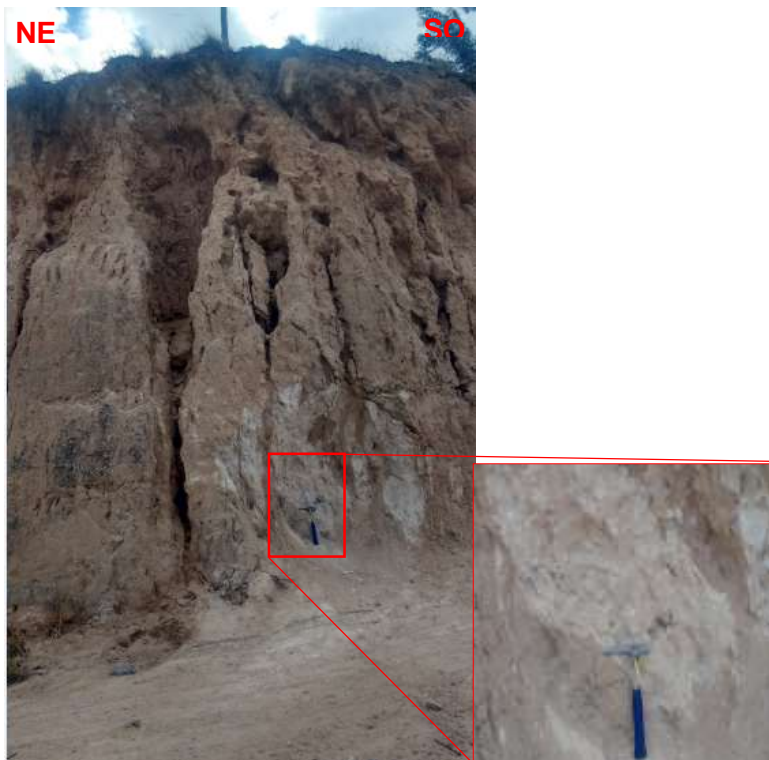
Foto 32: Depósitos de arcillita limosa en el Volcánico Huambos, ubicados en la carretera Mayhuasi - Shihua. (Norte: 9257259, Este: 773412).
