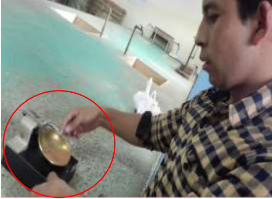
Foto 26: Golpeando la cuchara hasta que las mitades se junten en 12mm.
