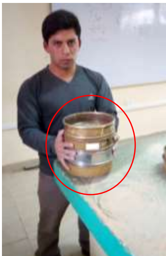
Foto 19: Tamizado de la muestra seca de arcilla en el laboratorio de mecánica de suelos.
