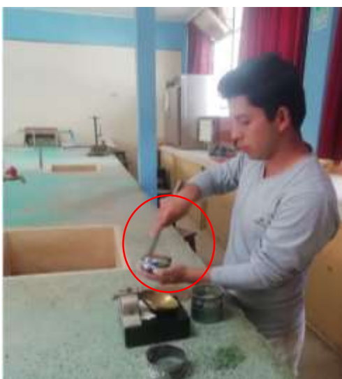
Foto 23: Homogenización de la muestra en el laboratorio de mecánica de suelos.
