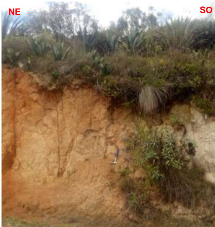
Foto 33: Depósitos de limolita arcillosa producto de la alteración de tobas del Volcánico Huambos en la carretera que une Chilcapampa - Shihua. (Norte: 9257789, Este: 772552).
