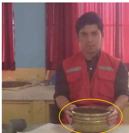
Foto 22: Tamizado de la muestra seca por el tamiz N° 40, en el laboratorio de mecánica de suelos.
