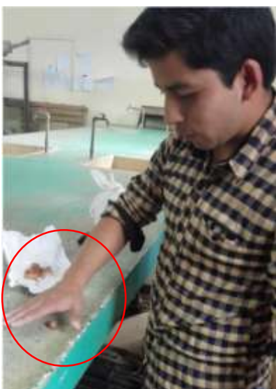
Foto 29: Presión a la muestra para reducir su tamaño.
