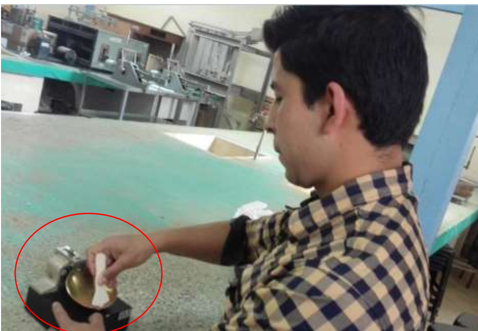
Foto 25: División de la muestra homogenizada con ayuda del ranurador.
