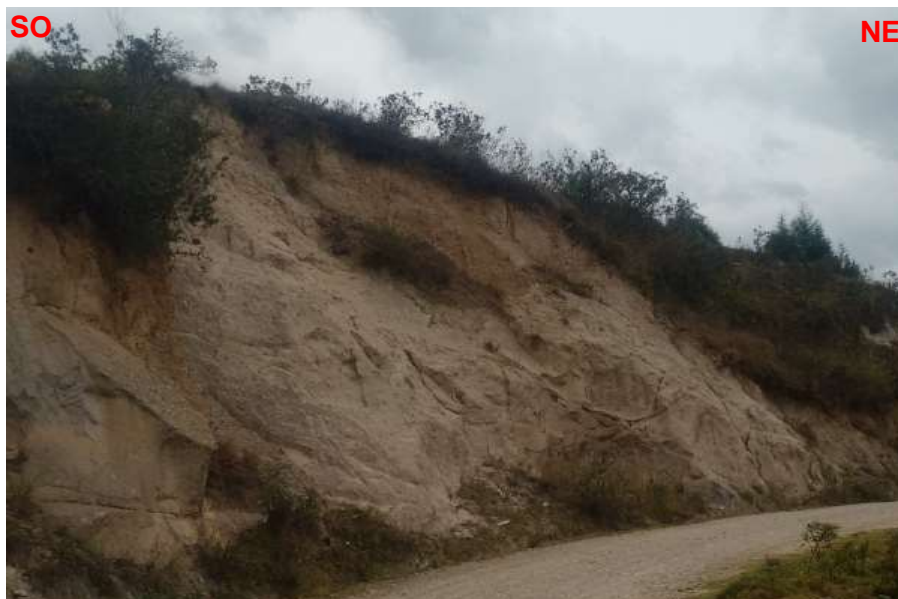
Foto 10: Deslizamiento planar en el Volcánico Huambos en el caserío Chilcapampa. (Norte: 9257819, Este: 772554).
