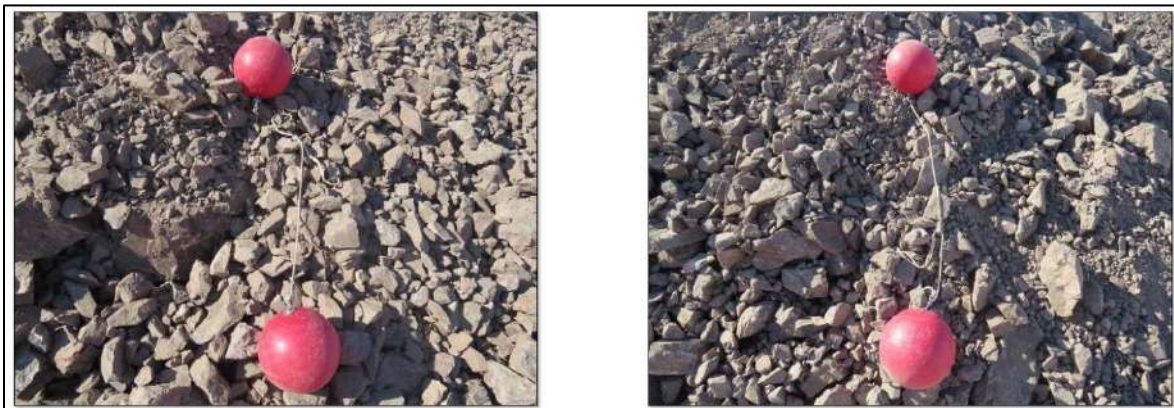
Figura 41: Sistema de medición de fragmentación. (DaveyBickford, 2017)
