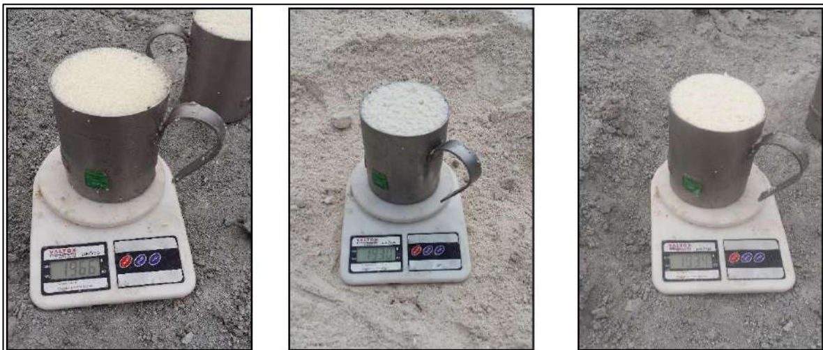
Figura 36: Toma y pesado de muestra de la mezcla explosiva para verificar su densidad
