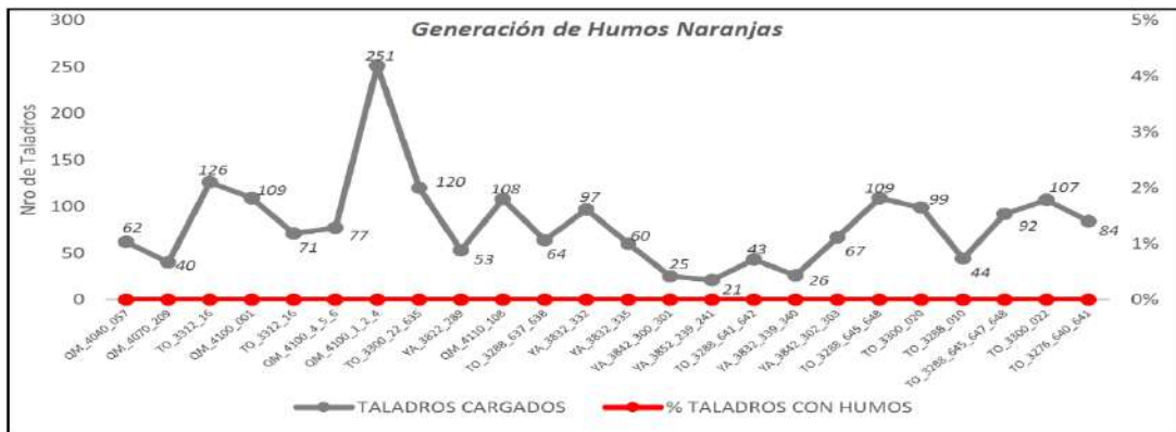
Figura 55: Resultado de emisión de humos naranjas en voladuras.
