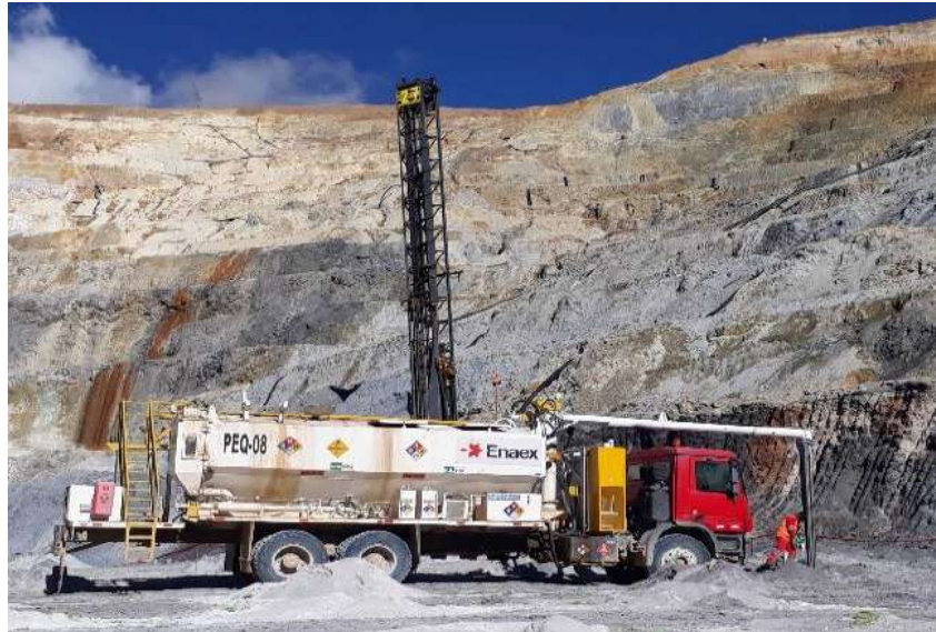
Figura 35: Camión fábrica (Cuadra), cargando con Anfo Pesado al taladro.
