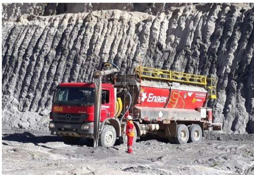
Figura 34: Camión fábrica (Milodón), cargando con Anfo Pesado al taladro.
