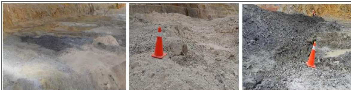
Figura 56: Fotografías de la fragmentación después de la voladura.
