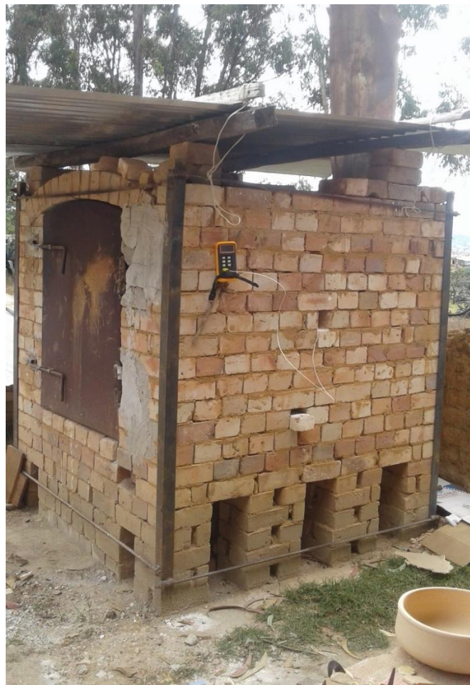
Figura 30. Horno cerámico a gas controlado con termocupla digital.
