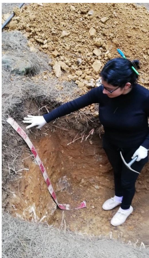
Figura 26. Examinación del suelo en la calicata S – 01.
