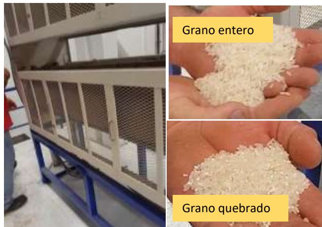
Máquinas clasificadoras. Separan el grano entero del quebrado (Molino Parker's).
