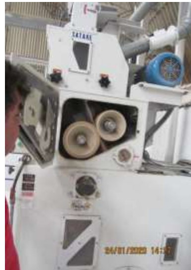
Descascaradora, máquina brasileña, marca Satake (Molino Parcker's).
