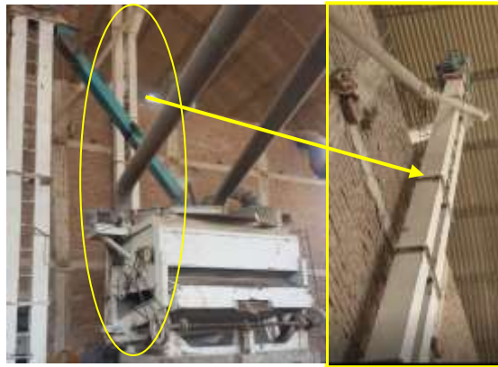
Elevador del arroz en cáscara limpio hacia la descascaradora (Molino San Francisco).
