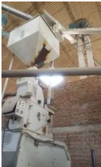
Descascaradora, máquina alemana, marca Buhler (Molino San Francisco).
