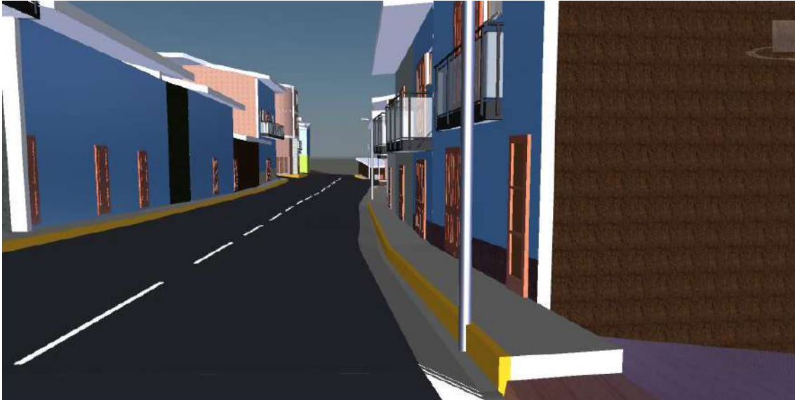
Figura N° 40: Realización de una cuneta debido a la altura de la vereda, dado que esta viene siendo la misma cota que la calzada. Fuente: Naviswork (2021)
