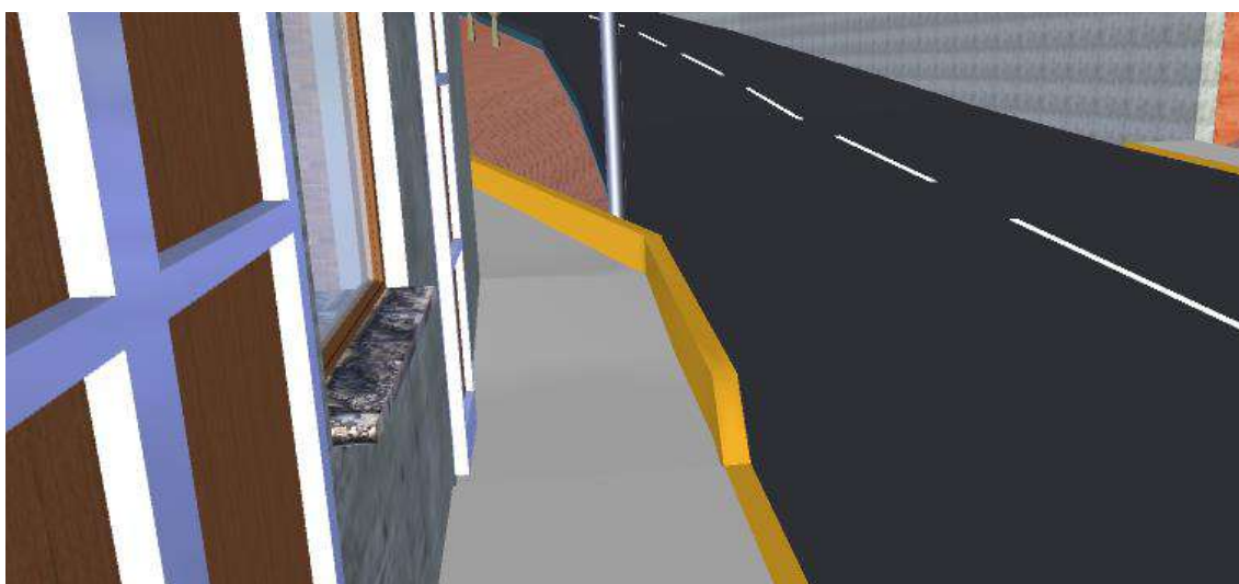
Figura N° 38: Realización de un sardinel con desnivel respecto a la vereda. Fuente: Naviswork (2021)
