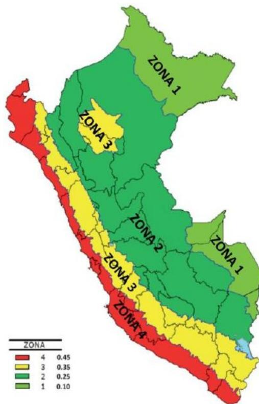
Fuente: Norma E.030 Diseño Sismorresistente, 2018.
