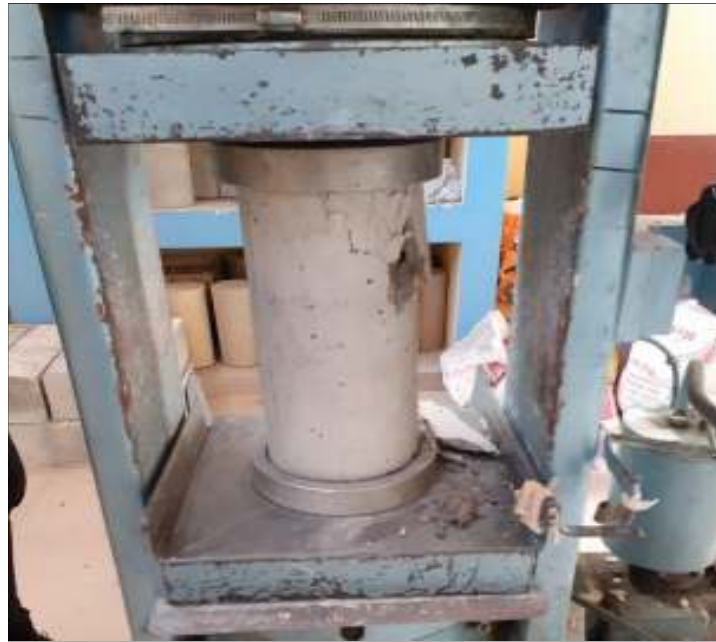
Figura 3.3. Ensayo a compresión de probetas cilíndricas de concreto a los 7 días.
