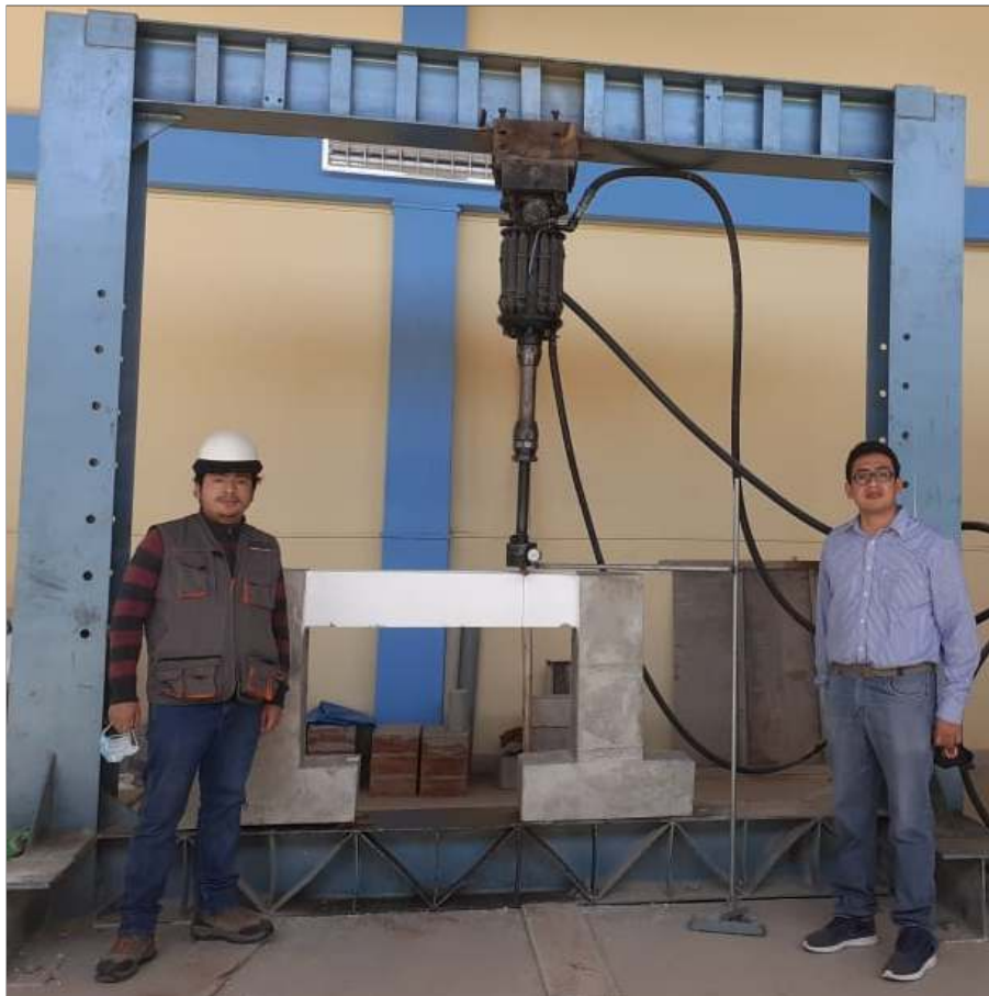
Fotografía N°13. Asesor y Tesista Post-Ensayo al Corte de Viga de Concreto Armado.
