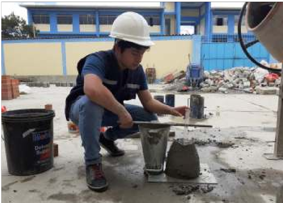
Figura 3.2. Verificación del Slump del diseño de mezcla.
