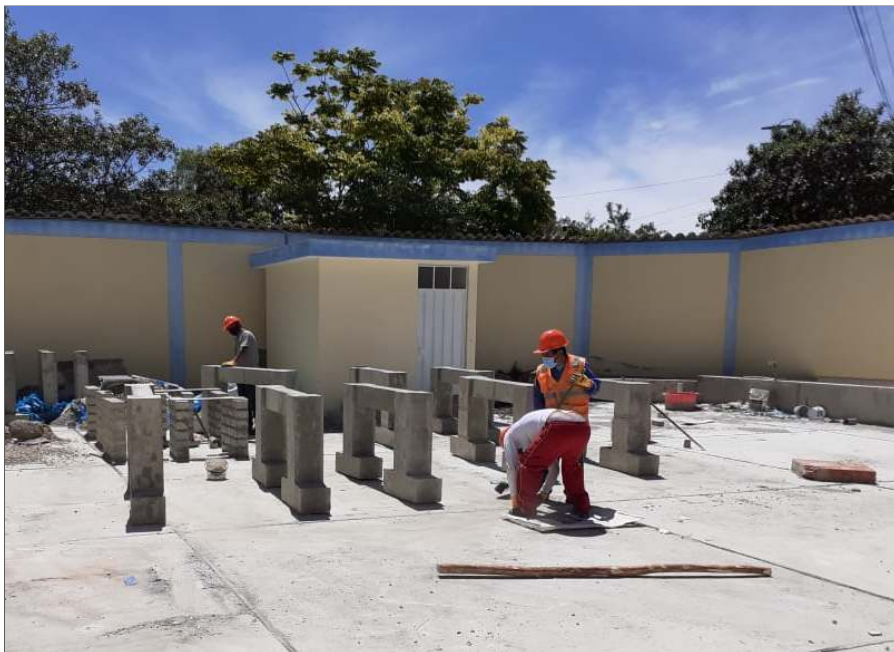
Fotografía N°9. Preparación de Pórticos Pre-Ensayo en la Maquina Universal de 100 ton del Laboratorio de Ensayo de Materiales de la Universidad Nacional de Cajamarca.
