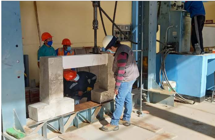
Fotografía N°12. Tesista verificando fisuras producidas por el esfuerzo cortante en las vigas de concreto armado.
