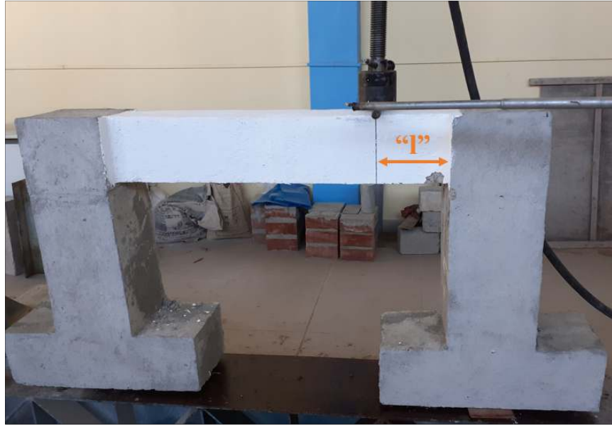
Figura 3.6. Distancia “l”, donde se aplicó la carga puntual en la Viga de concreto armado.
