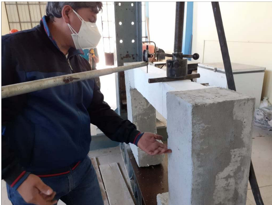
Fotografía N°11. Preparación de la Maquina Universal de 100 ton del Laboratorio de Ensayo de Materiales de la Universidad Nacional de Cajamarca, con ayuda del Técnico Ing. Edwin Germán Chaffo Mendoza
