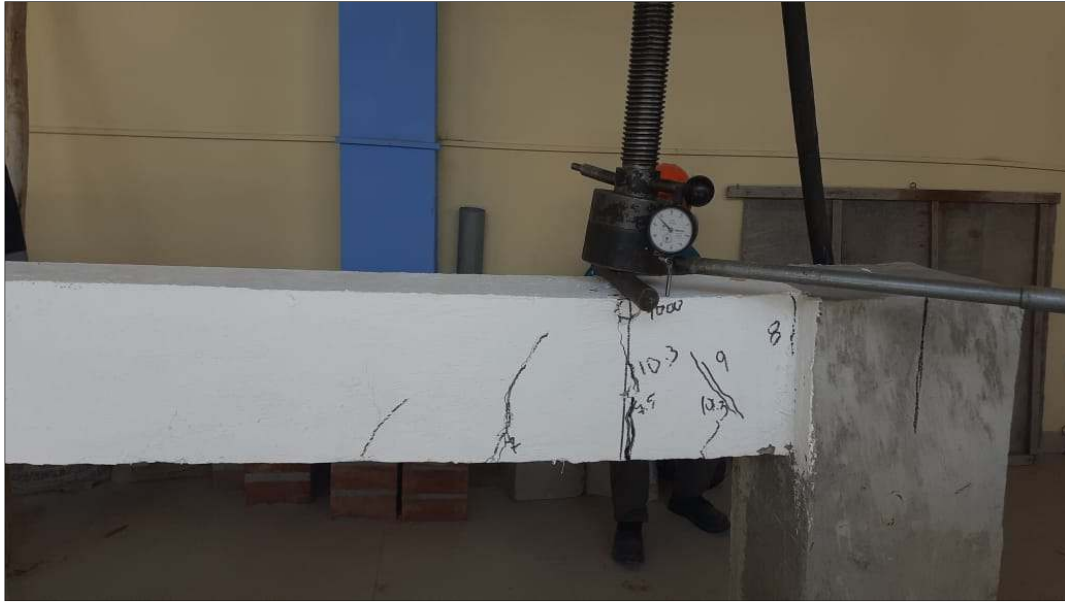
Fotografía N°16. Verificación del comportamiento de la Falla al corte de Viga de Concreto Armado.
