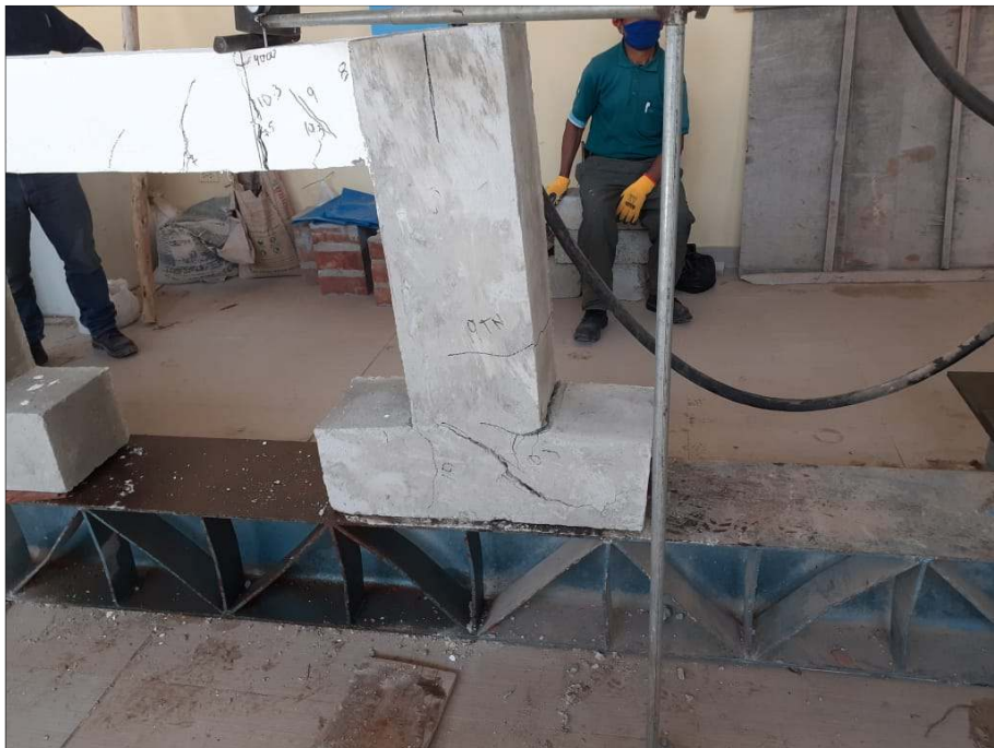
Fotografía N°15. Falla en Zapata de Pórtico de Concreto Armado.
