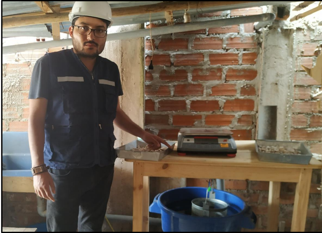
Fotografía 5: Ensayo de peso específico del agregado grueso
