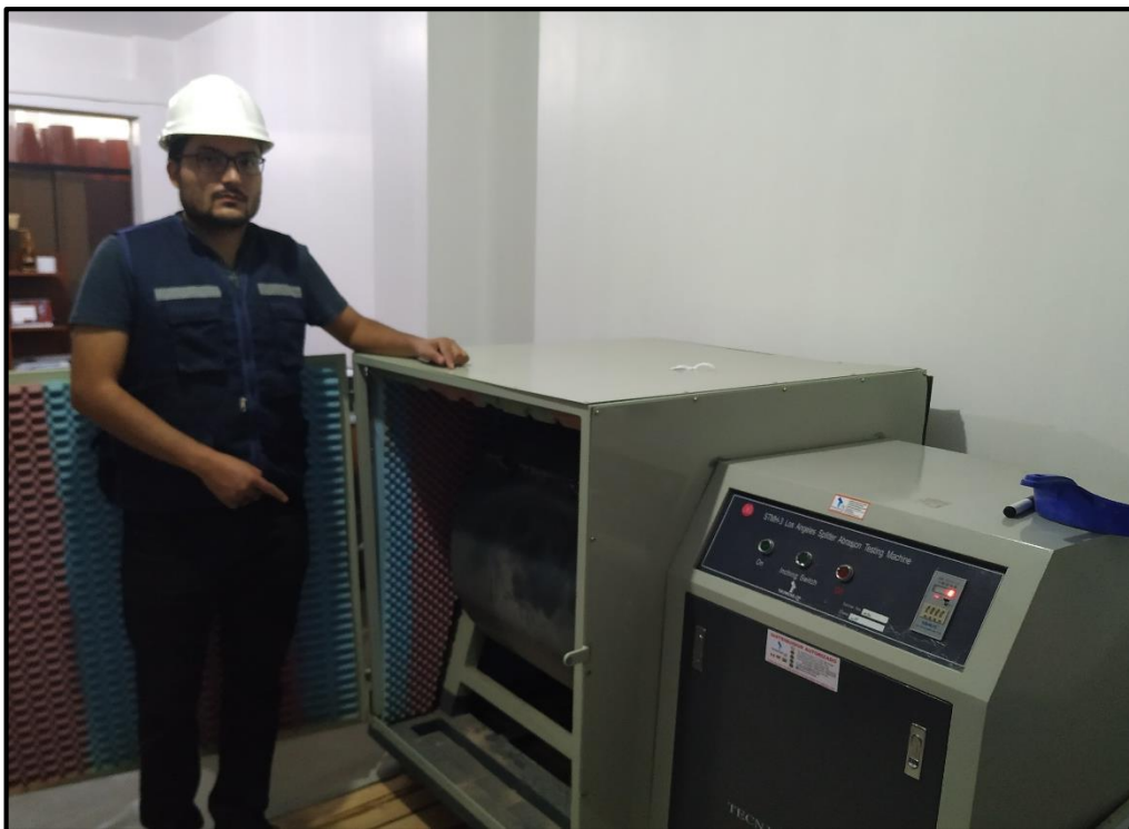
Fotografía 12: Ensayo de abrasión en la máquina de Los Ángeles del agregado grueso
