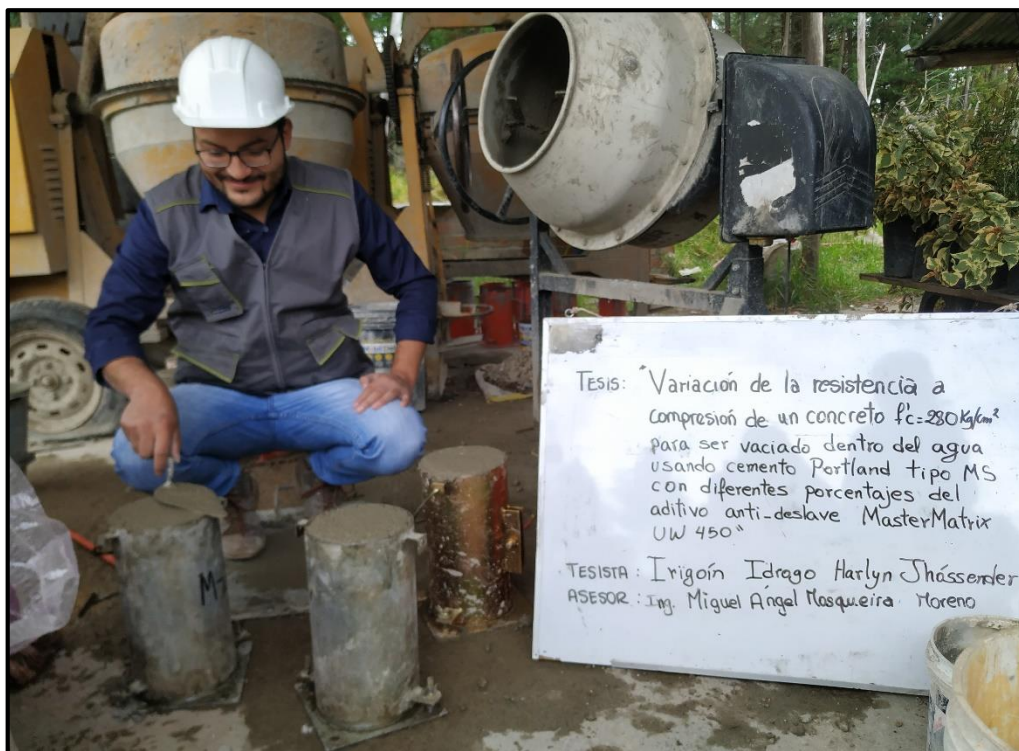
Fotografía 16: Elaboración de probetas cilíndricas del concreto patrón
