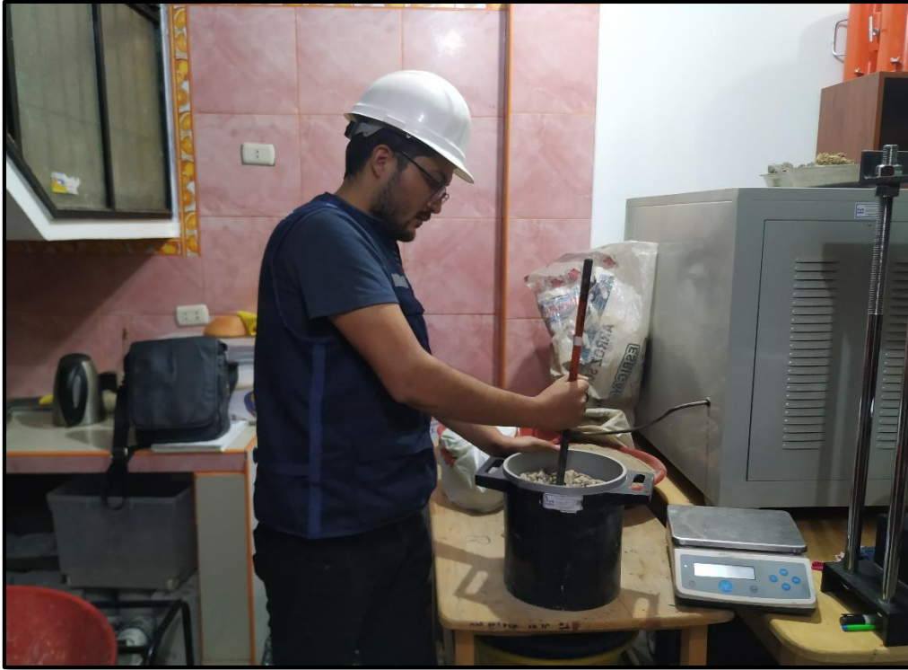
Fotografía 9: Ensayo de peso unitario seco compactado del agregado grueso
