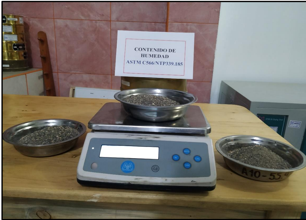
Fotografía 11: Ensayo de contenido de humedad de los agregados
