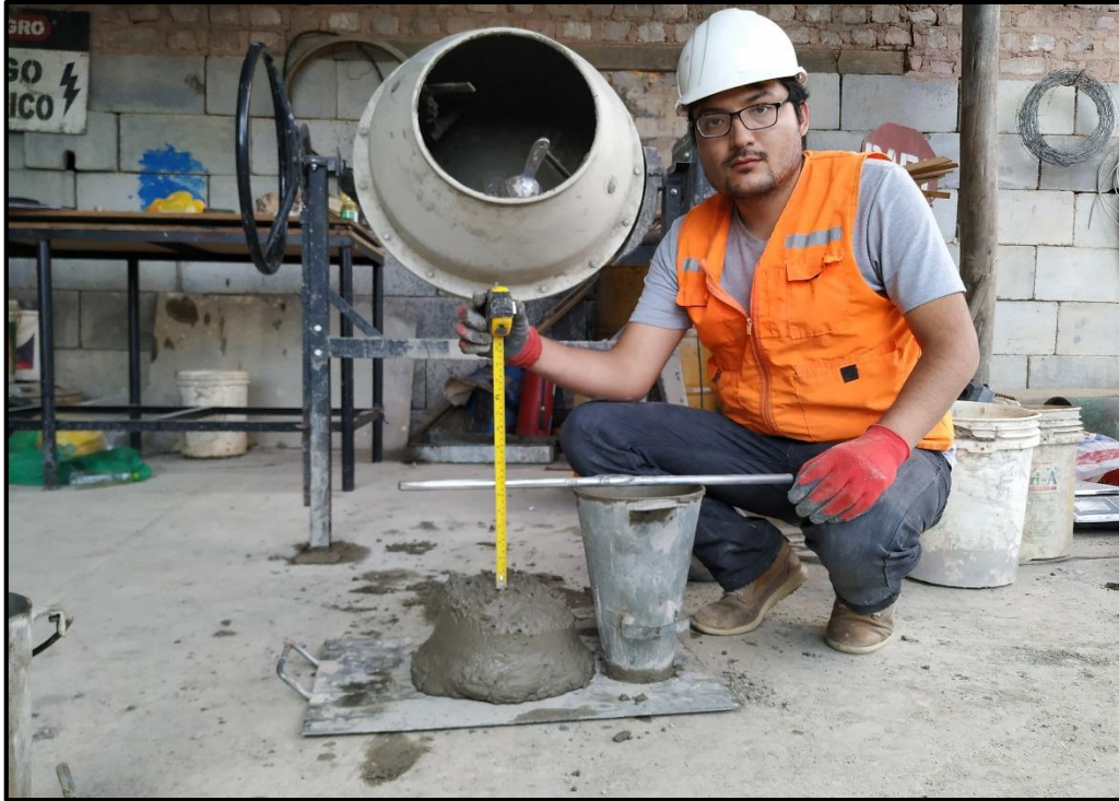
Fotografía 21: Ensayo de revenimiento del concreto anti-deslave
