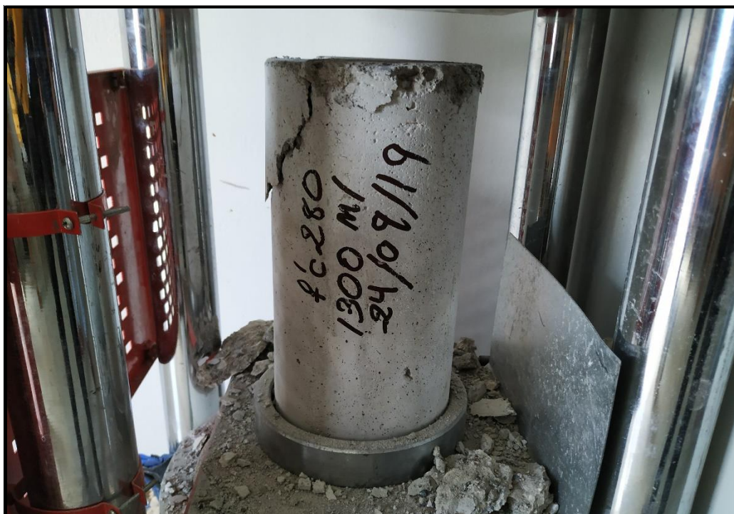
Fotografía 26: Falla tipo V en la ruptura a compresión
