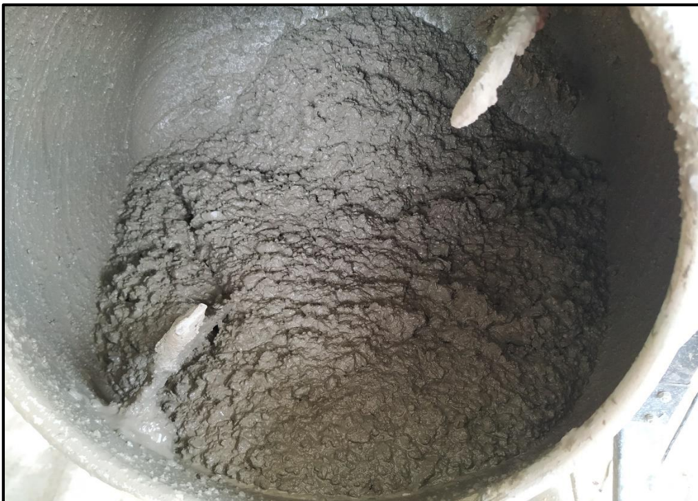
Fotografía 14: Elaboración de la mezcla patrón
