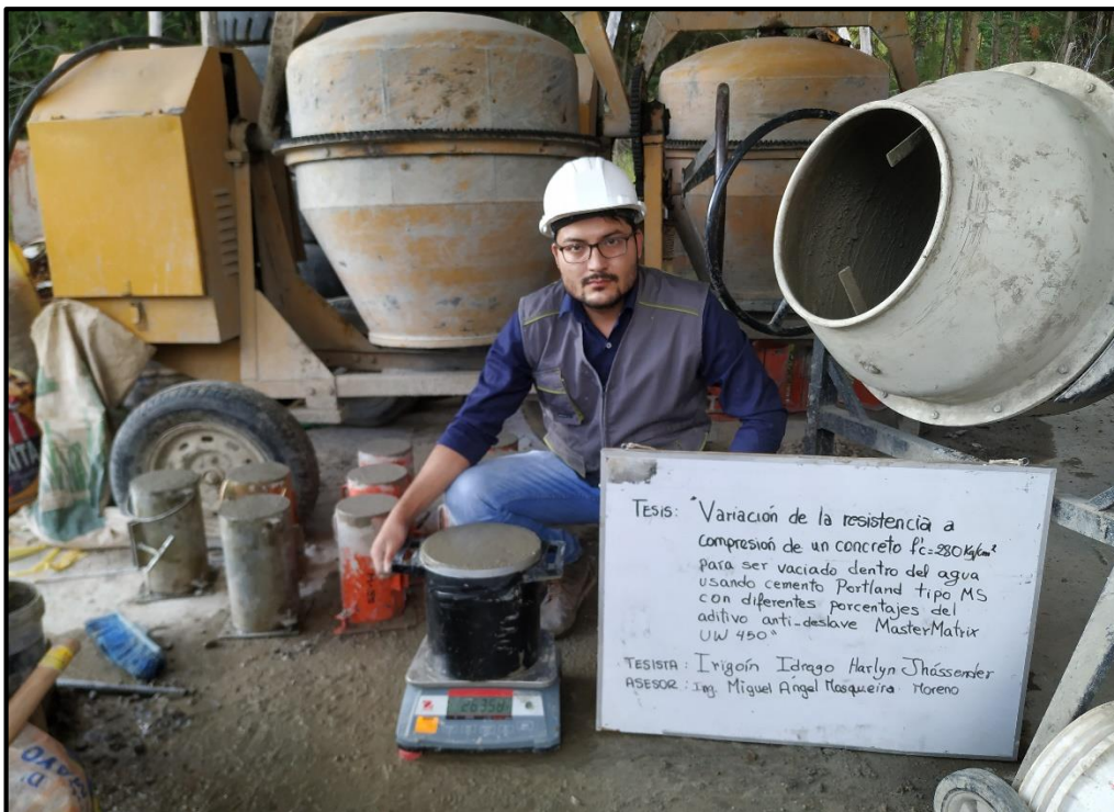
Fotografía 24: Ensayo de peso unitario del concreto fresco
