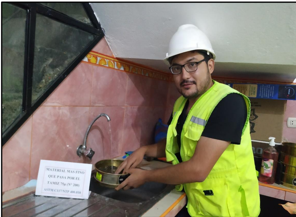
Fotografía 10: Ensayo de porcentaje de finos que pasan el tamiz N° 200
