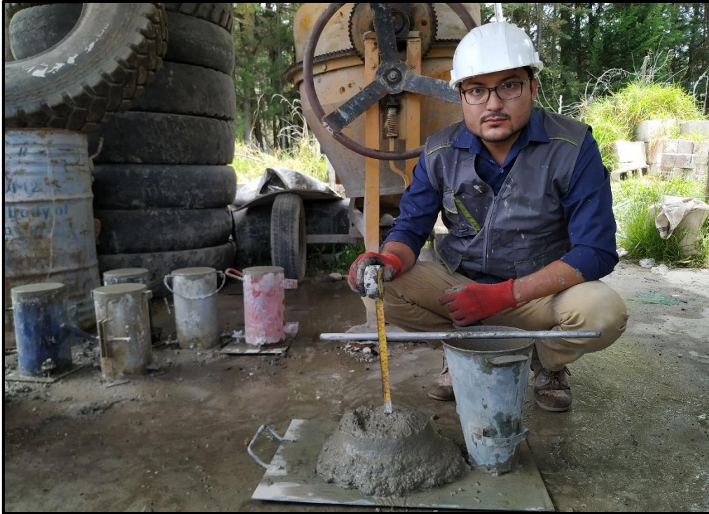
Fotografía 15: Ensayo de revenimiento del concreto patrón
