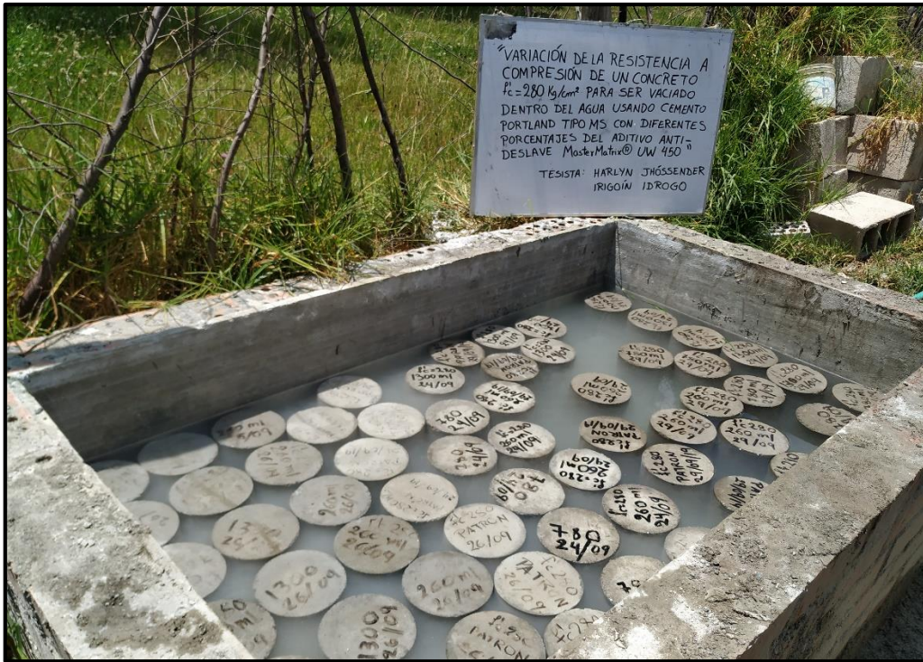
Fotografía 23: Identificación y curado con cal de probetas cilíndricas
