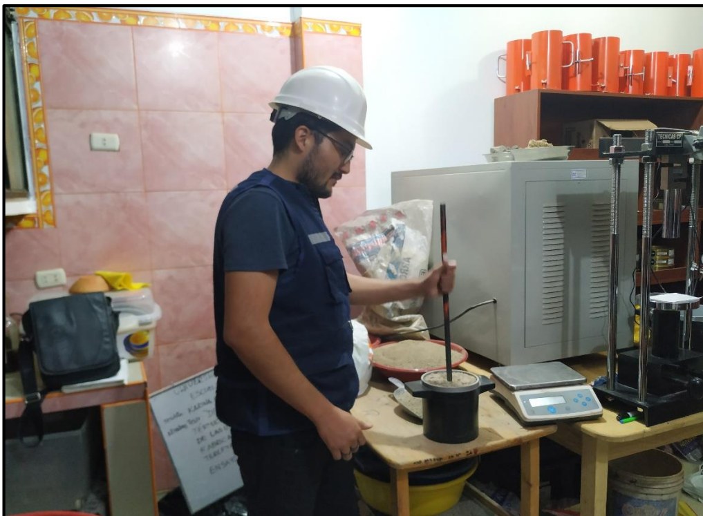
Fotografía 8: Ensayo de peso unitario seco compactado del agregado fino
